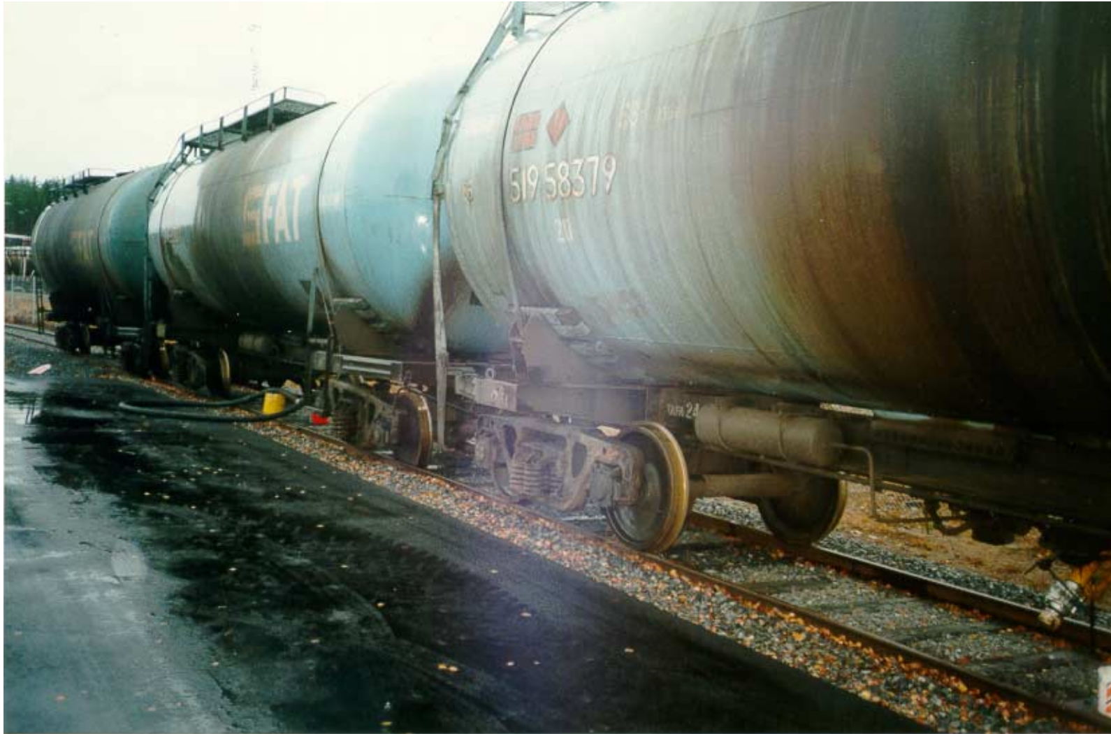
Kuva 3. Suistuneet säiliövaunut. Tyhjennysletku edelleen kiinni yhdessä vaunussa.
