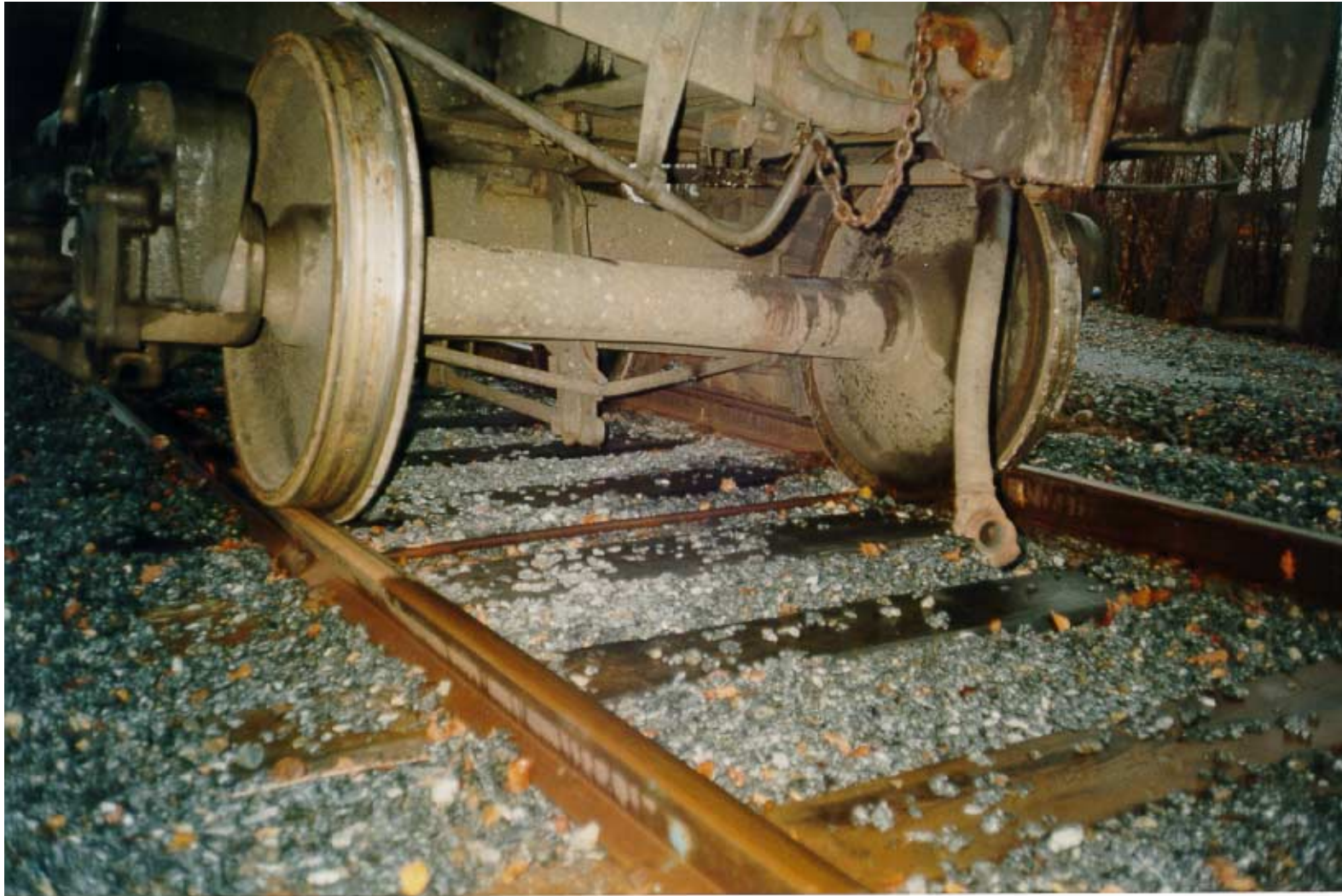
Kuva 6. Takimmaisen öljyvaunun takimmainen pyöräkerta. Pyöräkerran oikea pyörä on tippunut kiskoilta. Kiskojen väli 60 mm sallittua suurempi.
