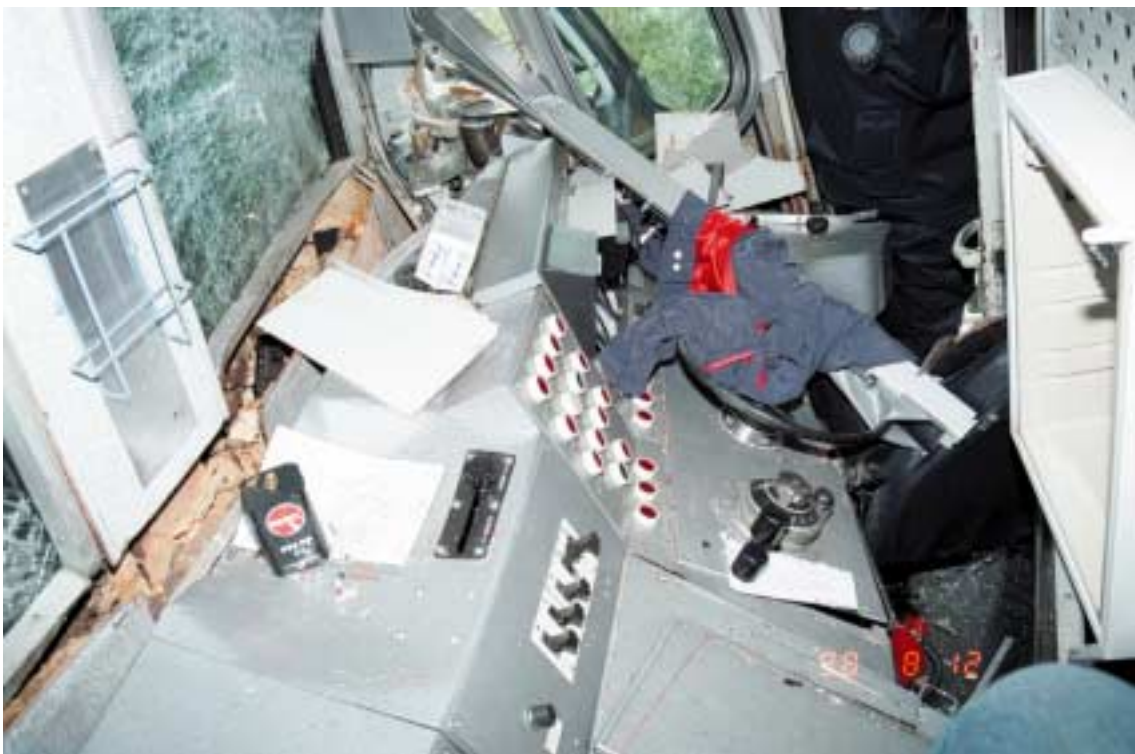
Kuva 4. Junien yhteentörmäys Suonenjoella 12.8.1998. Molempien veturien ohjaamotilat kaventuivat olemattomiksi. Veturien kuljettajat hyppäsivät ulos ohjaamoista hetkeä ennen yhteentörmäystä.
