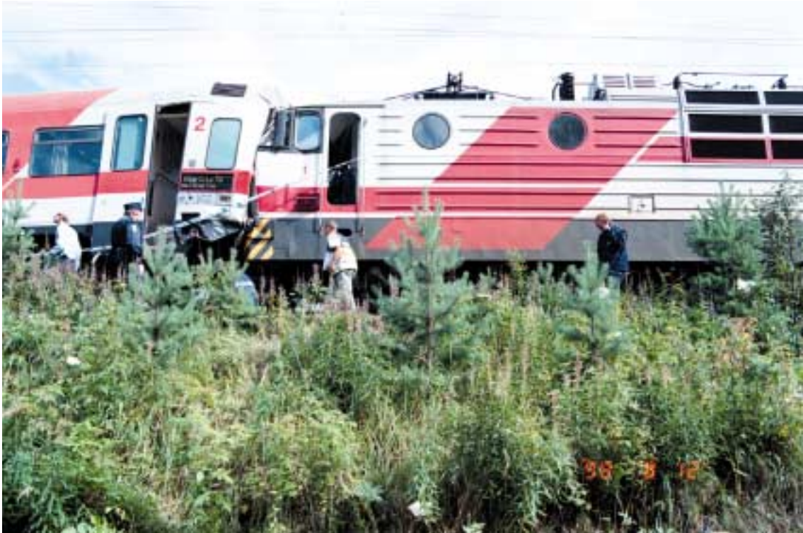
Kuva 5. Junien yhteentörmäys Suonenjoella 12.8.1998. Veturista seuraavana olleen matkustajavaunun päätyeteinen vaurioitui niin, että ovi oli avattavissa vain väkivalloin. Myös muiden vaunujen ovien avaus oli muodonmuutosten takia hankalaa.
