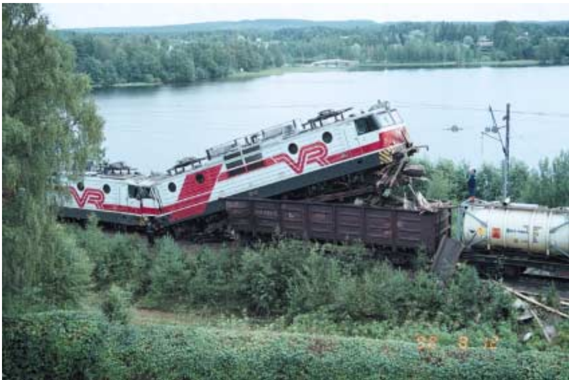
Kuva 2. Junien yhteentörmäys Suonenjoella 12.8.1998. Junat törmäsivät yhteen pysyen kuitenkin korkealla ratapenkereellä. Tavarajunan kaksi ensimmäistä vaunua työntyivät veturin alle nostaen sen perän korkealle ajolankoihin asti.
