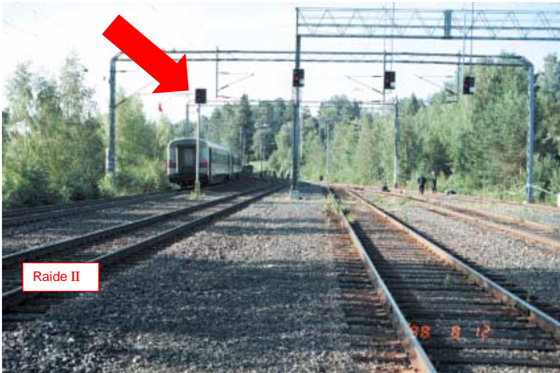
Kuva 1. Junien yhteentörmäys Suonenjoella 12.8.1998. Suonenjoen asemalta lähtenyt InterCity-juna ohitti lähtösuunnan pääopastimen (nuoli) ja törmäsi kaarteessa vastaan tulleeseen tavarajunaan, jonka oli tarkoitus ajaa ennen matkustajajunan lähtöä ohi raidetta II.
