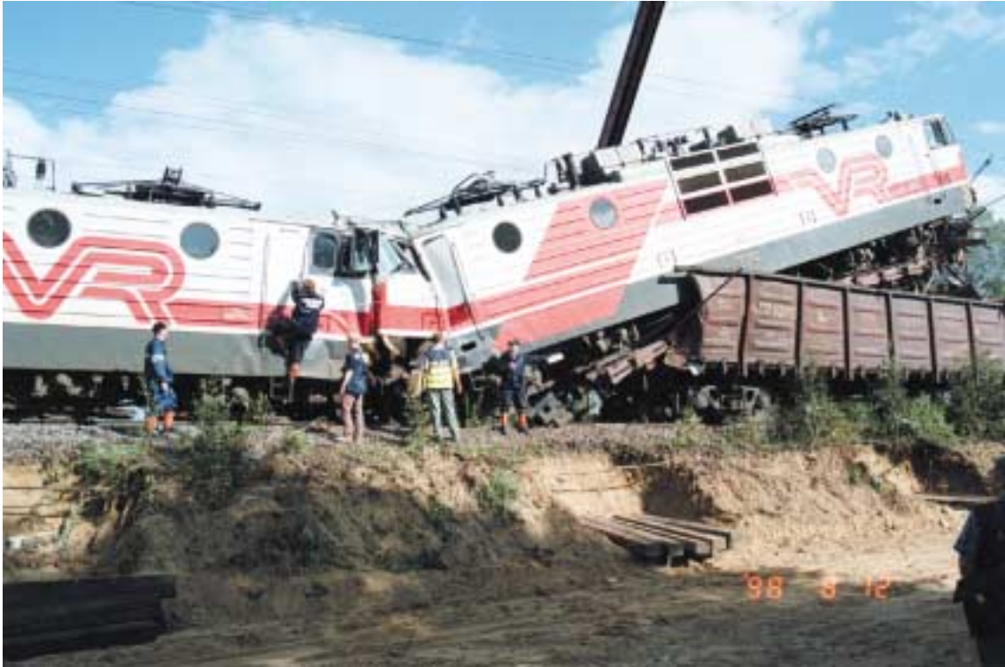
Kuva 3. Junien yhteentörmäys Suonenjoella 12.8.1998. Molempien Sr1-veturien ohjaamot vaurioituivat pahoin. Tutkintalautakunta poisti rekisteröintilaitteiden muistimoduulit onnettomuuspaikalla.
