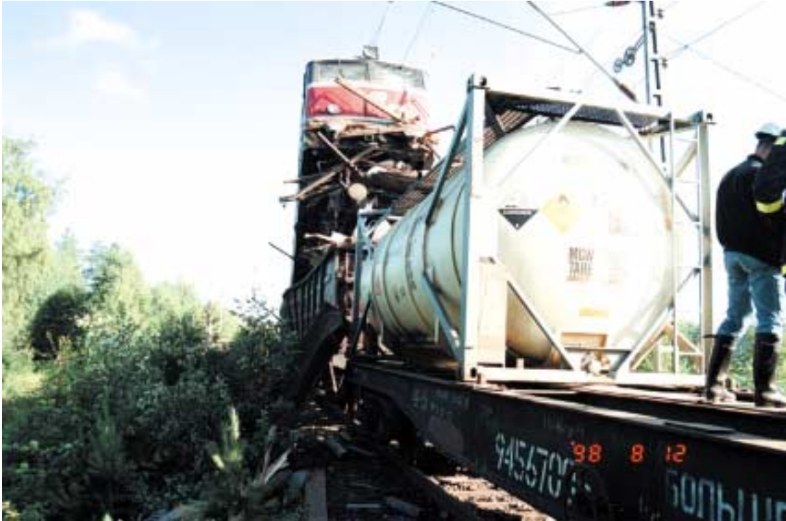
Kuva 7. Junien yhteentörmäys Suonenjoella 12.8.1998. Tavarajunassa kolmantena olleen konttivaunun vetyperoksidisäiliöt säilyivät vahingoittumattomina. Säiliöiden sisällön määrästä oli pitkään epätietoisuutta, koska vaunuluettelon mukaan tyhjä säiliöt näyttivät niihin katsottaessa täysiltä.
