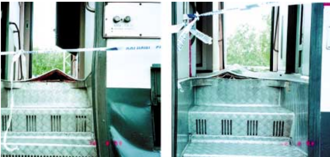
Kuva 6. Junien yhteentörmäys Suonenjoella 12.8.1998. IC-junan vaunujen eteisissä olevat myötäämisrakenteet estivät matkustamon muodonmuutokset ja vähensivät matkustajiin kohdistunutta hidastuvuutta.
