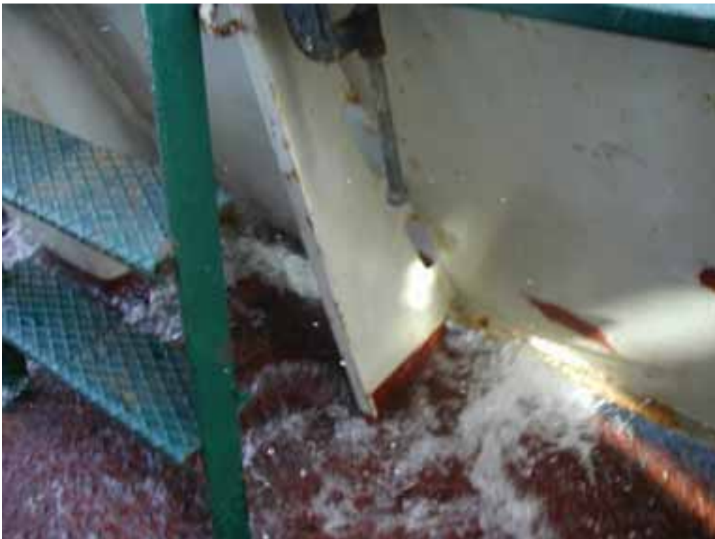
Kuva 15. Kuvien 13 ja 14 tilanteessa keskilaivan kohdalla olevasta valuma-aukosta nousee vesi kannelle.
