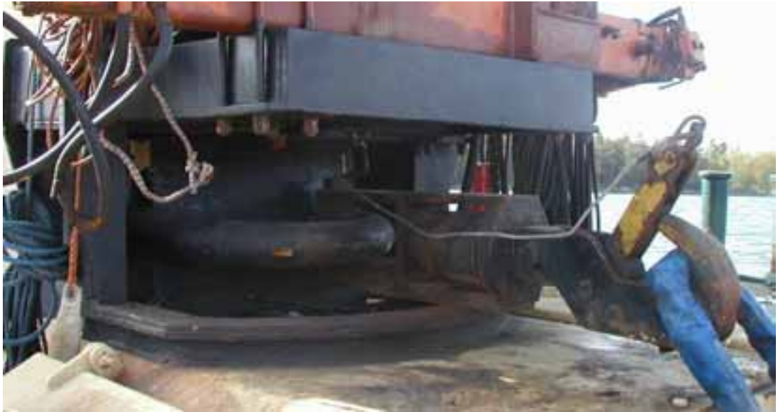
Kuva 4. Hinauskoukku, kiertymiskehä ja kaukolaukaisuvaijeri.
