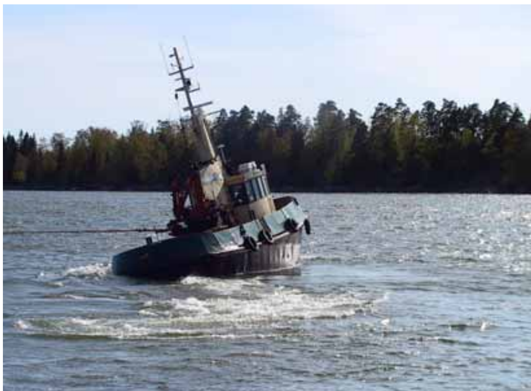
Kuva 13. VOIMAlle tehty vetokoe.
