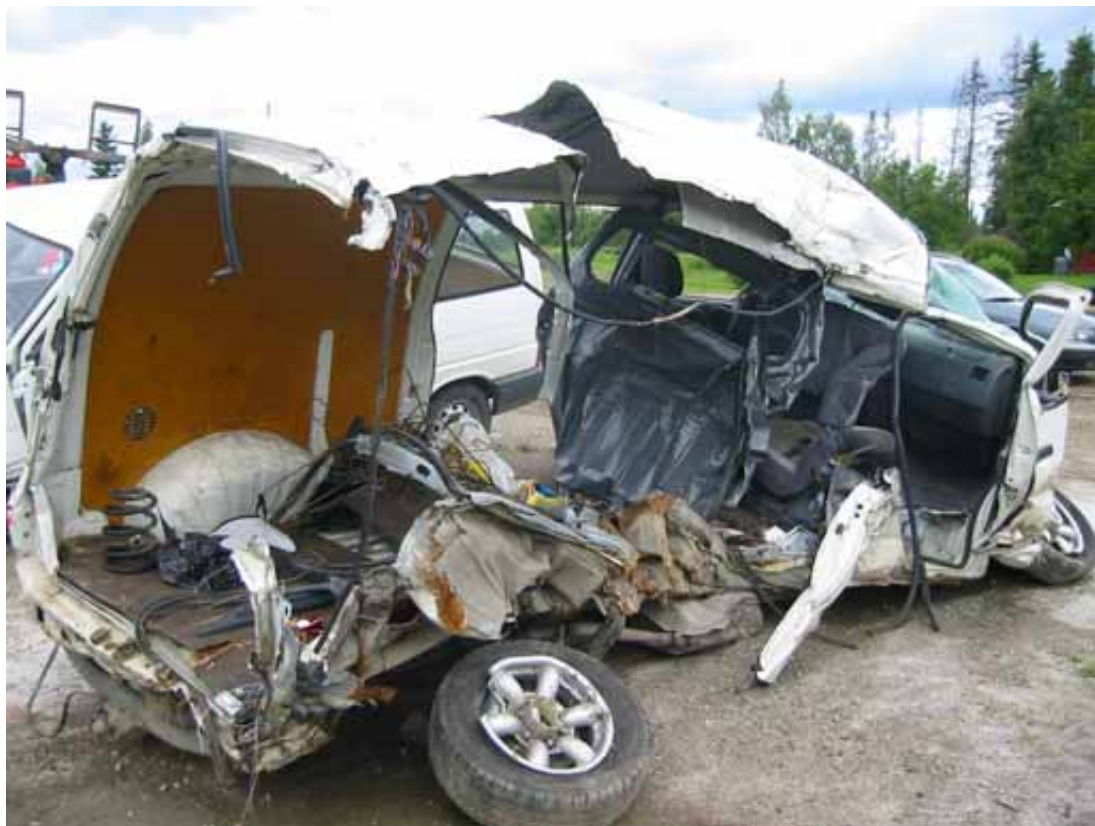
Kuva 3. Pakettiauto kuvattuna onnettomuuden jälkeen hinausyrityksen pihassa. Ohjaamo oli säilyttänyt muotonsa kuljettajan kohdalta, mutta oikea kylki repeytyi tavaratilan kohdalta kokonaan irti ja lattiarakenteet painuivat sisään.
