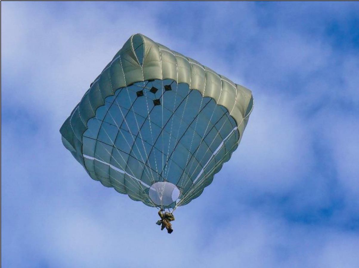
Kuva 4. Laskuvarjo T-11. Varjo on auenneena neliömäinen ja sen jokaisessa kulmassa on ilmanpoistoaukko. (Kuva: Puolustusvoimat)
