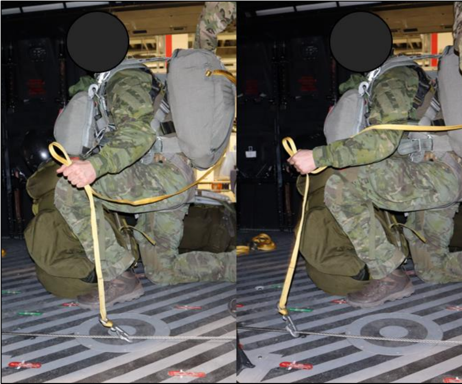
Kuva 1. Ruusukimppuote pakkolaukaisuhihnasta ja hihnan koukun kiinnitys lattiassa olevaan vaijeriin. Vasemmassa kuvassa pakkolaukaisuhihna kulkee oikeaa reittiä ja on vapaana. Oikeassa kuvassa hihna kulkee virheellisesti käsivarren sisäpuolelta ja kiristyessään repäisee käden ylös. Kuvassa hyppääjä on polvillaan helikopterin lattialla, mutta oikeassa hyppytilanteessa hyppääjä seisoo ilma-aluksessa. (Kuva: OTKES)
