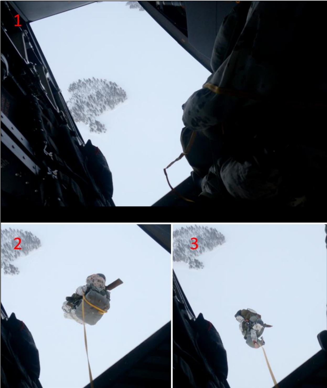
Kuva 2. Loukkaantuneen varusmies B:n uloshyppy. 1. Pakkolaukaisuhihna kulkee virheellisesti vasemman käden ympäri. 2. Hihna kiristyy käden ympärille. 3. Hihna repäisee hyppääjän käsivarren ylös. (Kuva: Puolustusvoimat, muokkaukset: OTKES)
