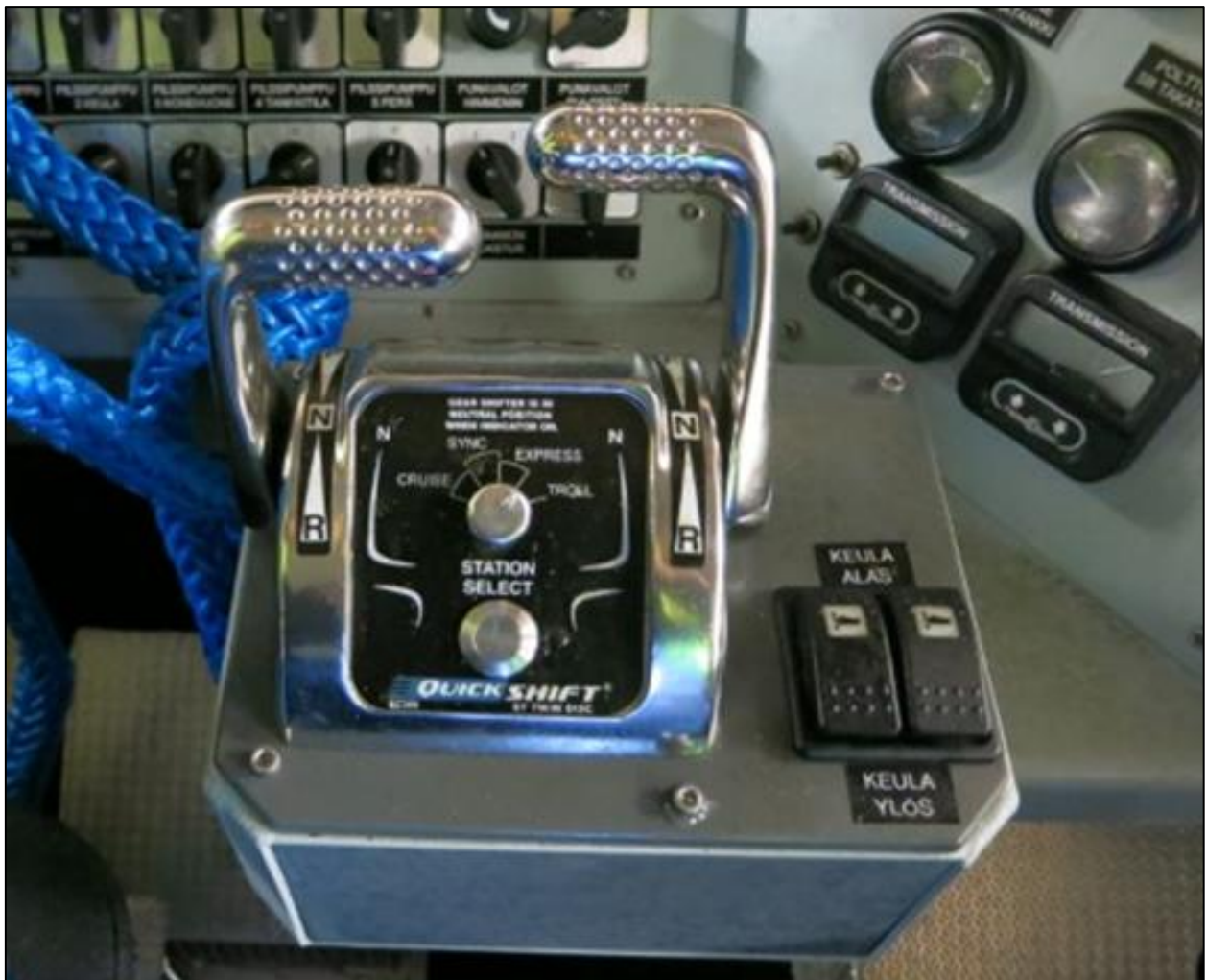
Bild 15. Vad gäller positionen för styrhandtagen var kopplingen för vänster motor i noll-läge, medan kopplingen för högre motor visade på en effekt på ungefär 20 % framåt. (Bild: OTKES)
