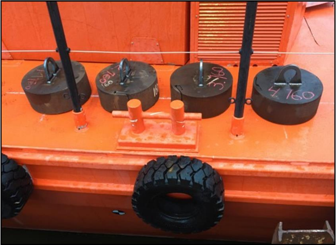
Bild 23. De vikter som använts på lotsbåt L-241:s däck vid krängningsprovet. Vid krängningsprovet användes fyra vikter, som flyttades enligt krängningsprovsschemat på båtdäcket. Krängningarna mättes med två pendlar, av vilka den ena hängts bakom styrhytten och den andra från luckan på fördäcket. (Bild: OTKES)
