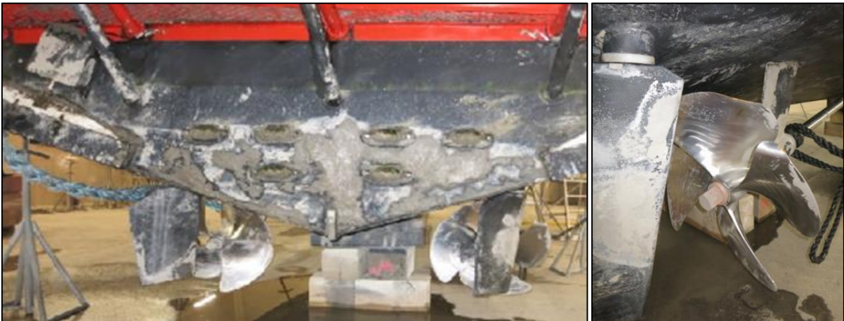
Bild 13. Rodren var i extremposition till vänster. I ändan av högre propellers två blad fanns det en liten böjning. Trimplanen befann sig i sin fack. (Bild: OTKES)
