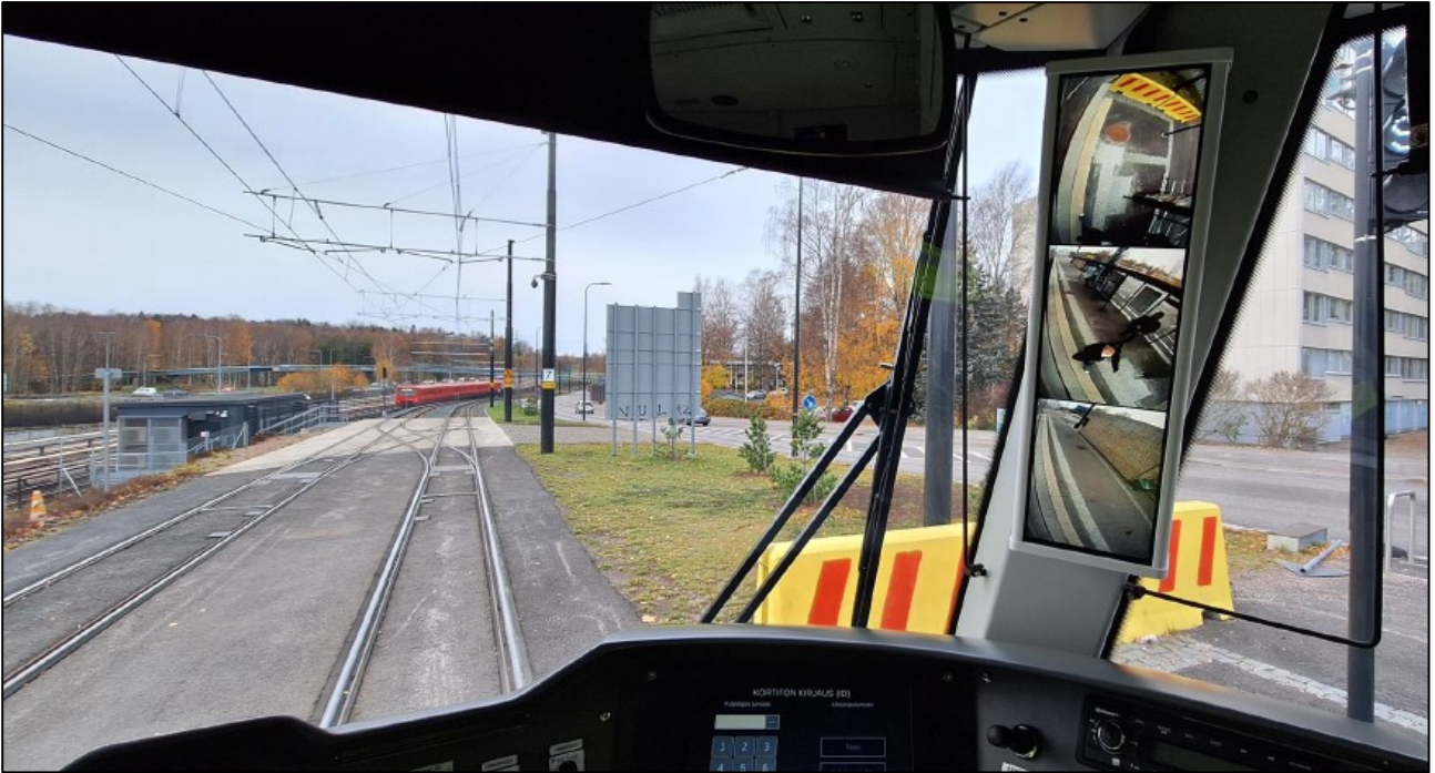
Kuva 13. Kuljettajan näkymä Itäkeskuksen pääte pysäkillä laiturissa 31. Lähtöluvan antava ja vaihteiden asennon ilmaiseva opastin näkyy sivuikkunasta. Kuvassa opastin näyttää seis-opastetta. Vaunu on samassa kohdassa kuin onnettomuuspäivänä ennen onnettomuutta. (Kuva: Pääkaupunkiseudun Kaupunkiliikenne Oy)
