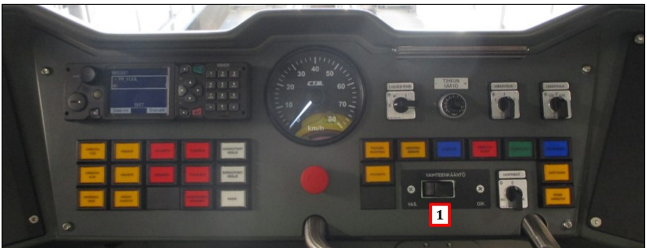
Kuva 18. Smart Artic X54-raitiovaunun ohjauspöydän keskiosan laitteet. Kuvassa numero 1 on vaihteenkääntövipu. (Kuva: OTKES)
