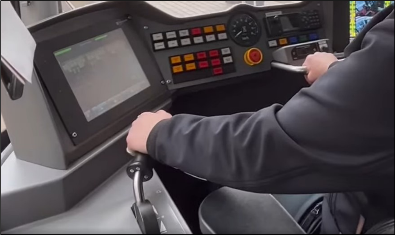
Kuva 17. Kantakaupungin raitiotiellä käytössä olevan Artic X34-raitiovaunun ajokahva ja ohjauspöytä. (OTKES:in kuvakaappaus Pääkaupunkiseudun Kaupunkiliikenne Oy:n videolta)
