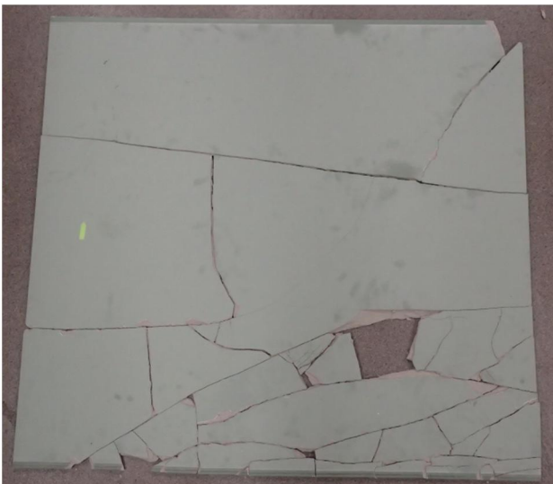
Kuva 8. Kuvassa esitetään rikkoontuneen levyn palasien löytöpaikat (kuva OTKES)
