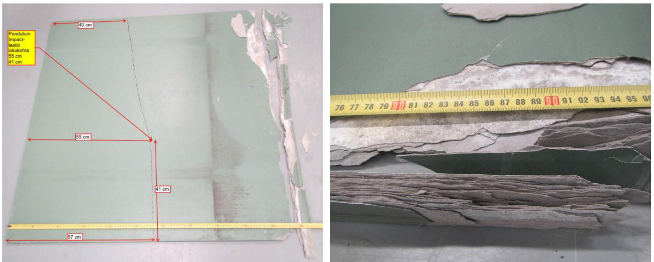
Kuva 10. Levyn yksityiskohtia kokeen jälkeen. Vasemmassa kuvassa näkyy, miten alareuna irtosi. Oikealla lähikuva liuskamaisesti heikentyneestä ja murtuneesta alareunasta. (Kuvat: Contesta Oy)
