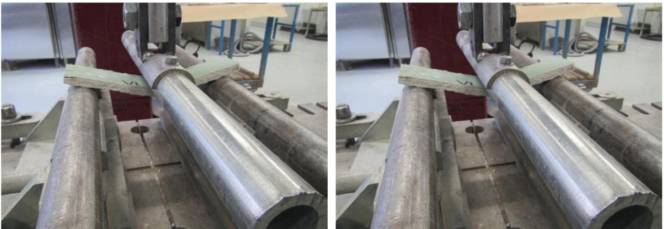
Kuva 11. Taivutuskokeen koejärjestely. (Kuva: Contesta Oy)
