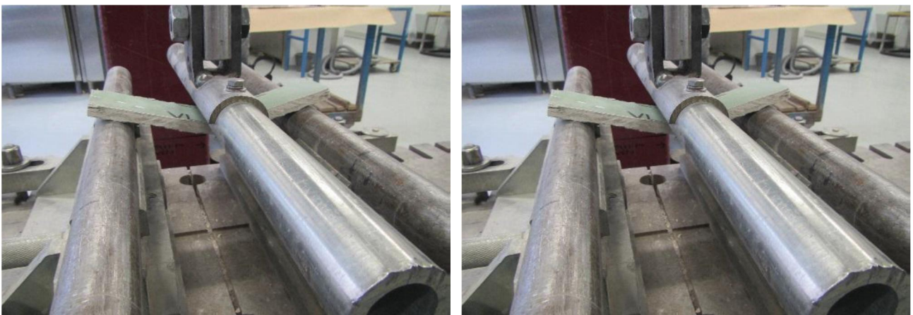
Bild 11. Arrangemang för böjningstestet. (Bild: Contesta Oy)
