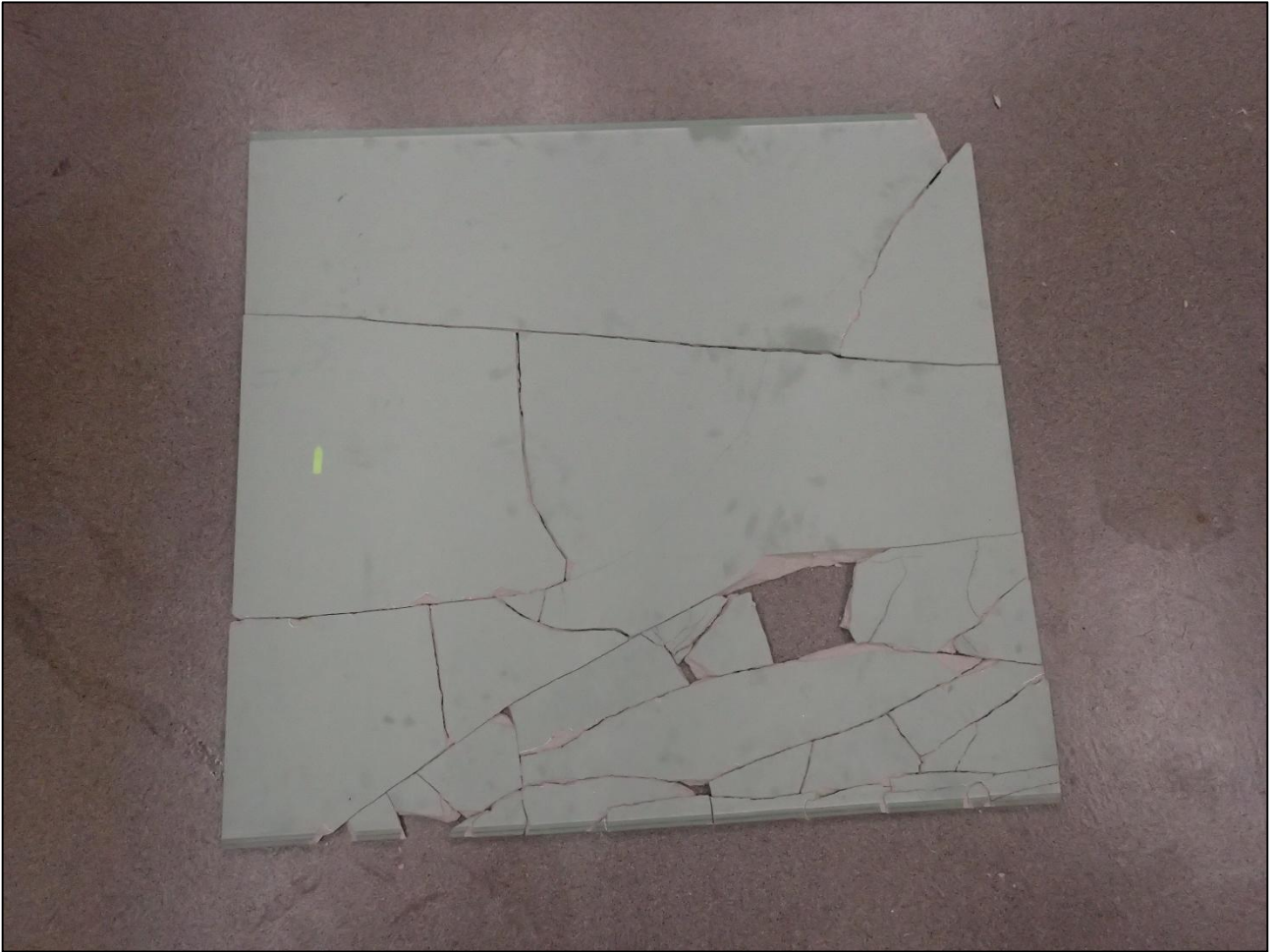
Bild 7. Den rekonstruerade skivan från olycksbalkongen. Skivan är i samma position som när den var fäst i aluminiumstommen med fasadsidan mot åskådaren. (Bild: OTKES)
