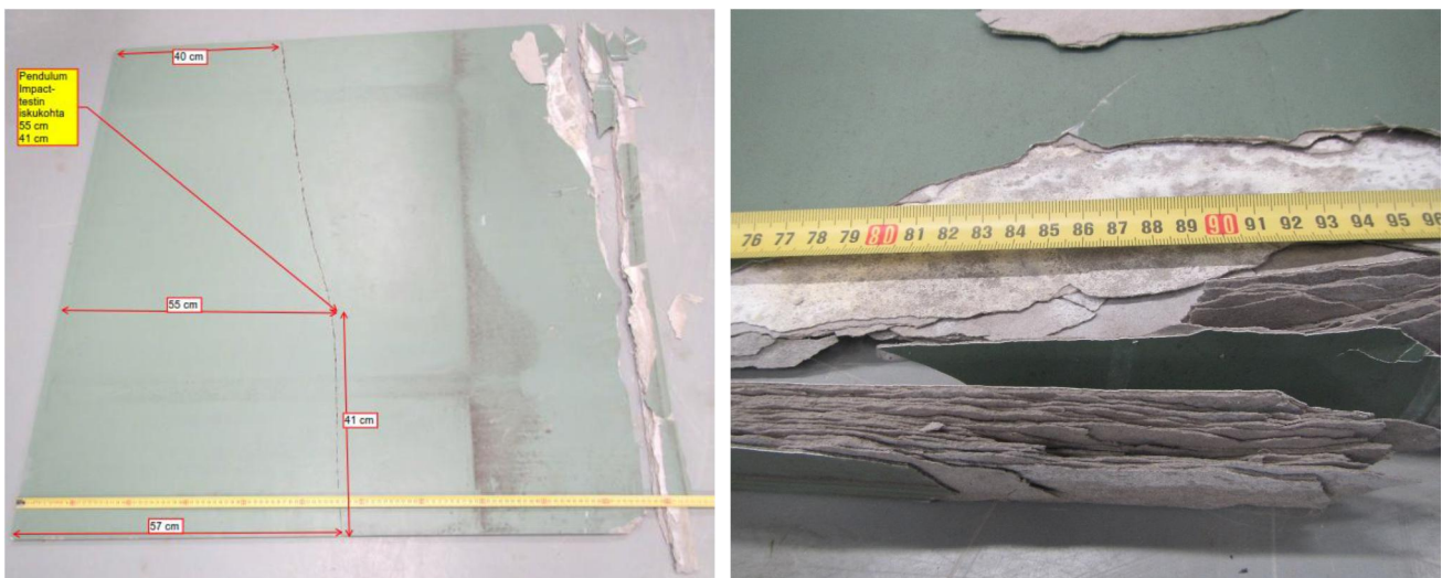
Bild 10. Detaljer av skivan efter testet. På bilden till vänster ser man hur den nedre kanten lossnade. Till höger närbild av den nedre kanten som försvagats flikigt och brutits. (Bilder: Contesta Oy)
