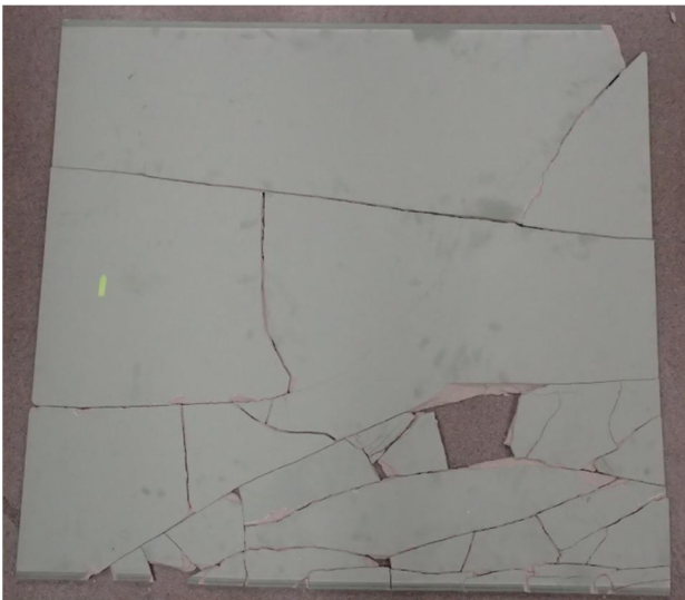
Bild 8. På bilden visas fyndplatserna för bitarna från den trasiga skivan (Bild: OTKES)
