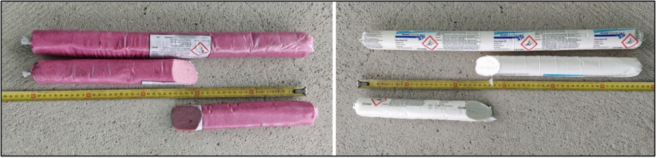
Kuva 11. Räjätettävän kentän panostuksessa käytettiin pohjapanoksena dynamiittia (punaiset patruunat) ja varsipanoksena emulsioräjähdyssainetta (valkoiset patruunat). (Kuvat: OTKES)
