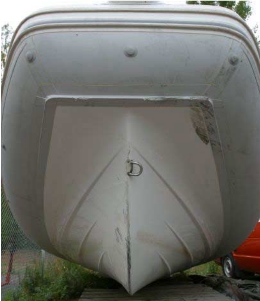
Bild 10. Skadorna i fören på Brig-båten.
