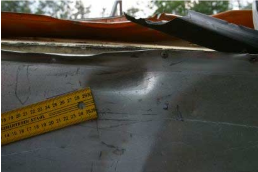
Kuva 14. Buster-veeneen vasemmassa kyljessä olleet naarmut ja painautuma.
