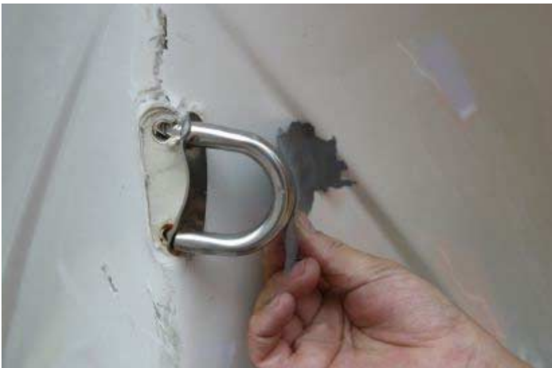
Bild 15. Krökningen på Brig-båtens stävögla är den samma som i intryckningen i Buster-båtens sida. Jämförelsen gjordes med hjälp av en silikonavgjutning.
