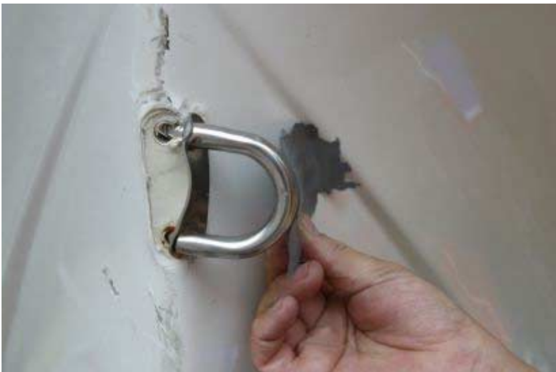
Kuva 15. Brig-veeneen keulasilmukan kaarevuus on sama kuin Buster-veeneen kyljessä olleen painautuman. Vertailu tehtiin silikonivaloksen avulla.
