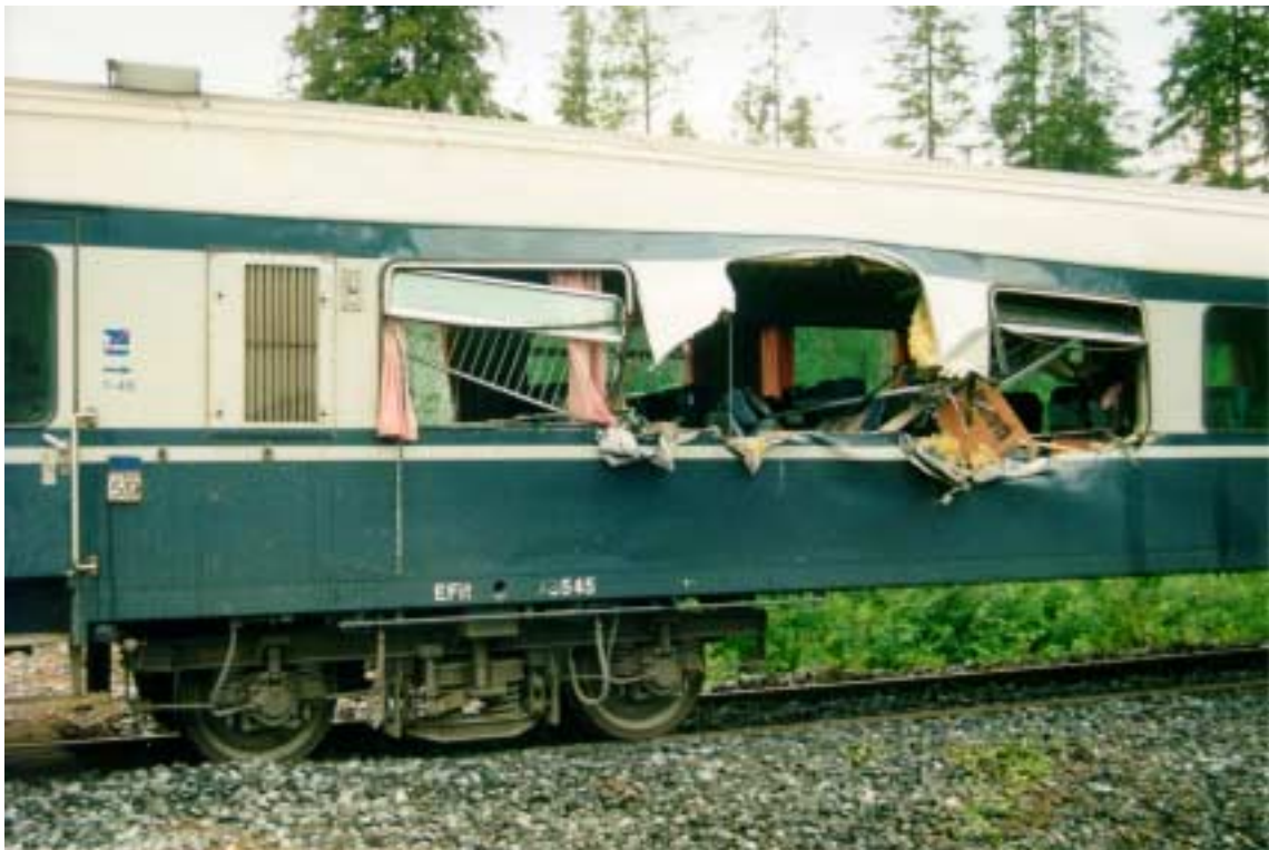
Kuva 9. Matkustajajunan ja sepeliä kuljettaneen ajoneuvoyhdistelmän törmäys Kuivaniemellä 6.7.2000. Perävaunun rungon etuosa tunkeutui toisen vaunun takaosaan rikkoen kolme ikkunaa. Onnettomuudessa menehtynyt matkustaja istui keskimmäisen ikkunan kohdalla.
