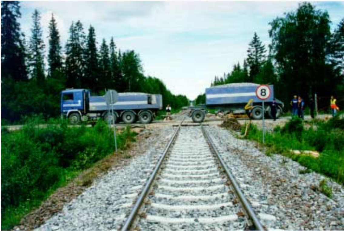
Kuva 3. Henkilöjunan ja sepeliä kuljettaneen ajoneuvoyhdistelmän törmäys Kuivaniemellä 6.7.2000. Tasoristeykseen on ajettu samanlainen ajoneuvoyhdistelmä kuin onnettomuusauto oli. Auto on juuri siinä kohdassa, jossa törmäys tapahtui.
