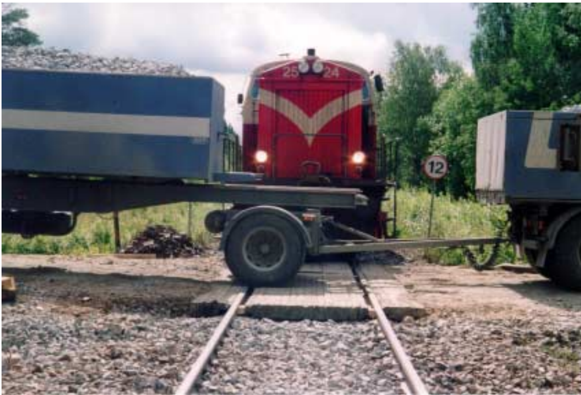
Kuva 4. Matkustajajunan ja sepeliä kuljettaneen ajoneuvoyhdistelmän törmäys Kuivaniemellä 6.7.2000. Veturi törmäsi vetoauton ja perävaunun väliin, juuri perävaunun etuakselin kohdalle.
