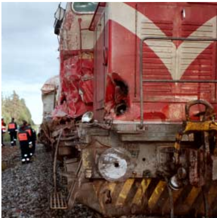
Kuva 5. Matkustajajunan ja sepeliä kuljettaneen ajoneuvoyhdistelmän törmäys Kuivaniemellä 6.7.2000. Perävaunun etuakselin vanteen jättämä pyöreä jälki näkyy veturin kelta-mustassa esteenraivaajassa. Perävaunun kasettilava osui veturiin ylemmäs ja 1. vaunuun.
