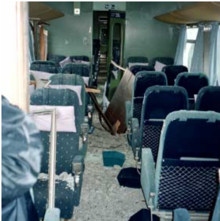
Kuva 7. Matkustajajunan ja sepeliä kuljettaneen ajoneuvoyhdistelmän törmäys Kuivaniemellä 6.7.2000. Ensimmäisen vaunun ensimmäisen osaston lattia oli täysin sepelin ja lasinsirujen peitossa.
