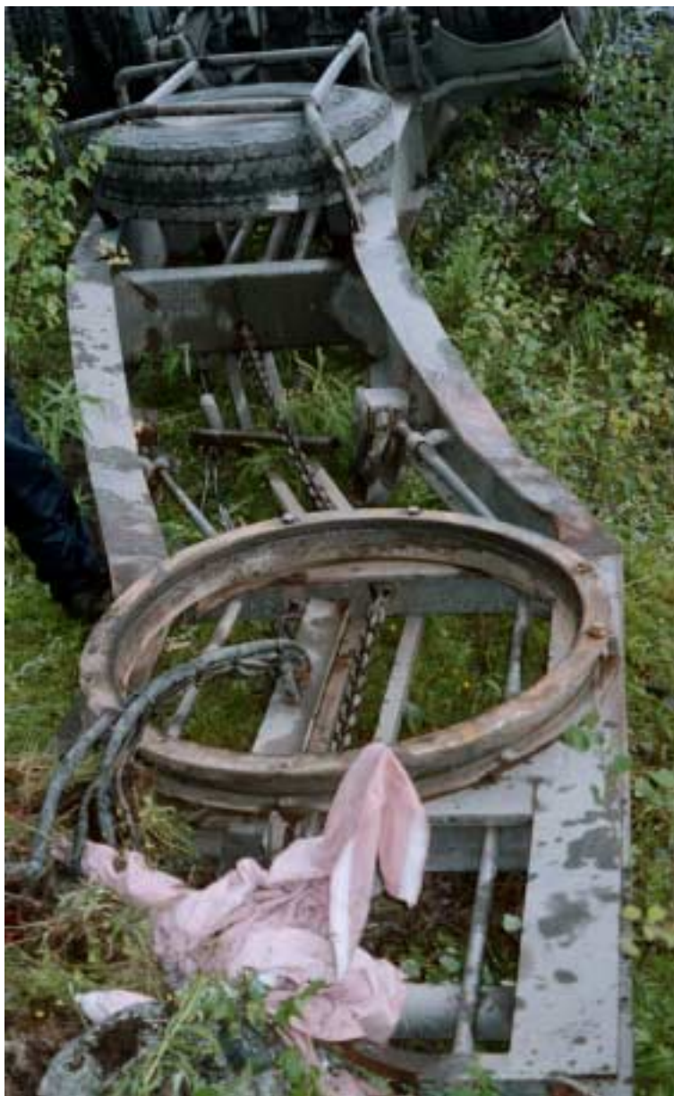
Kuva 10. Matkustajajunan ja sepeliä kuljettaneen ajoneuvoyhdistelmän törmäys Kuivaniemellä 6.7.2000. Perävaunun vääntynyt runko, josta törmäyksessä irtosi kasettilava ja etuakseli. Rungon etuosassa on junan toisesta vaunusta peräisin oleva ikkunaverho.
