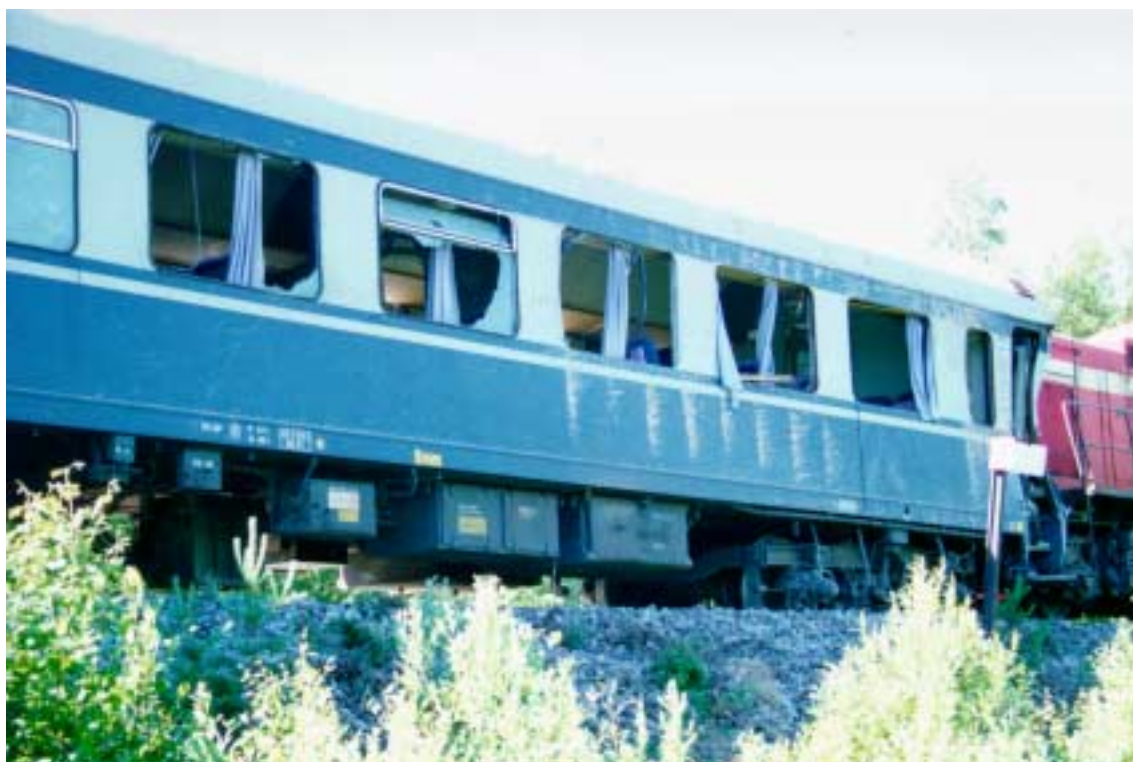
Kuva 6. Matkustajajunan ja sepeliä kuljettaneen ajoneuvoyhdistelmän törmäys Kuivaniemellä 6.7.2000. Kasettilavalla ollut sepeli ryöpsähti ikkunoiden läpi sisälle ensimmäiseen vaunuun.
