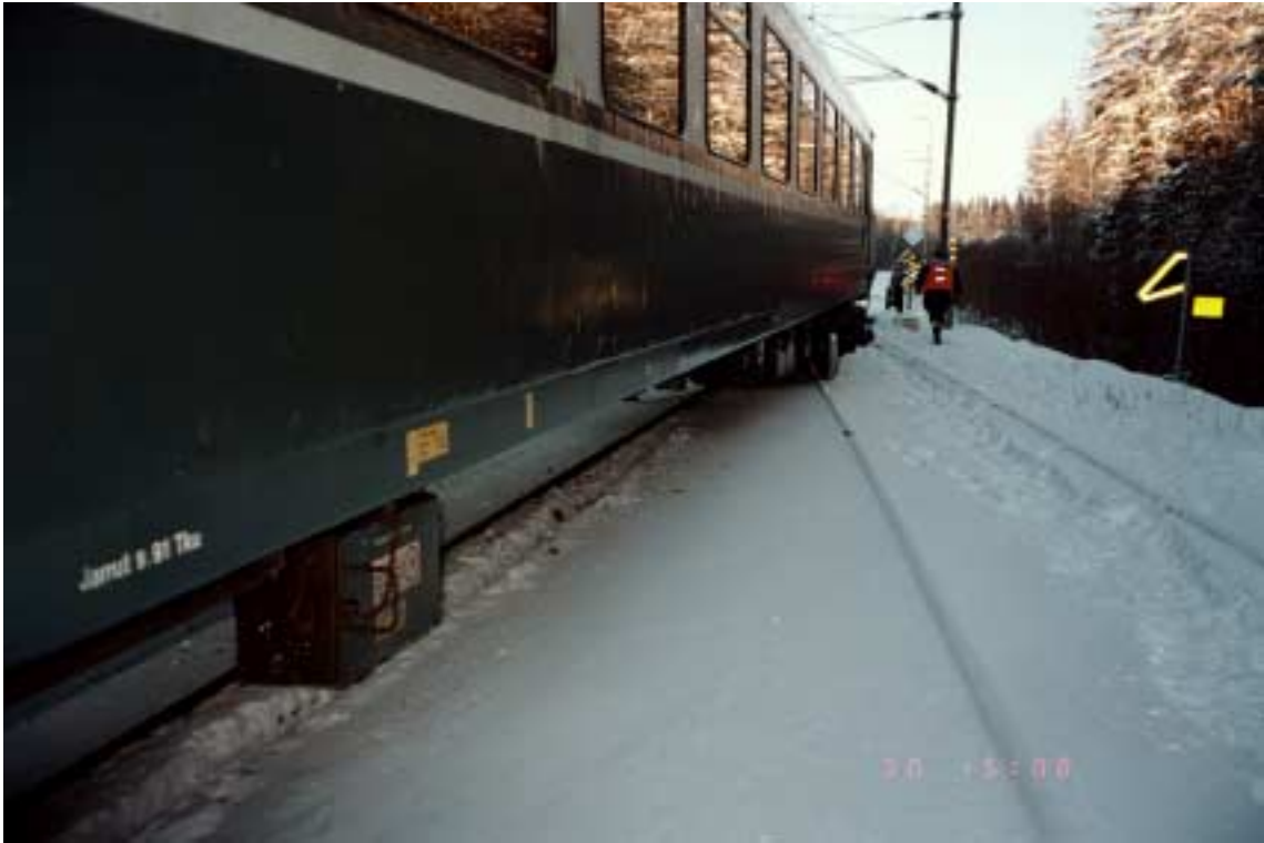
Kuva 8. Henkilövaunun suistuminen kiskoilta Mynttilässä 30.1.1999. Etutelin suistumisjälki. Figure 8. Passenger coach derailling at Mynttilä, on January 30, 1999. Marks made by the front bogie when derailling.
