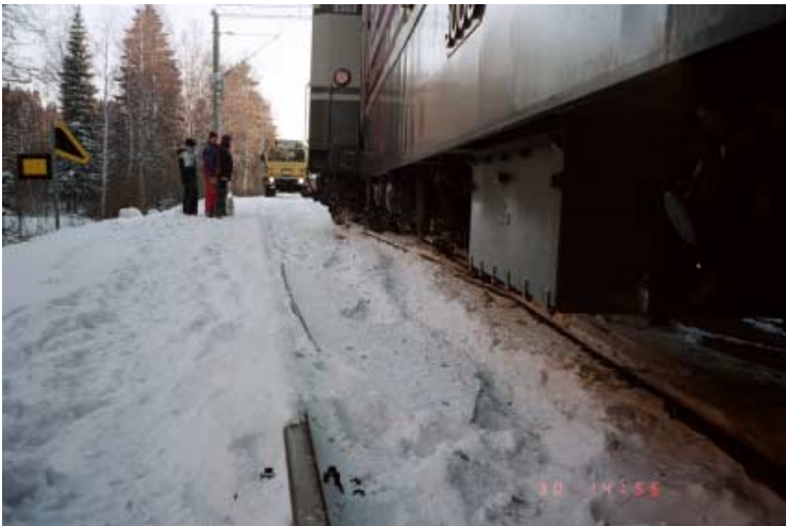
Kuva 7. Henkilövaunun suistuminen kiskoilta Mynttilässä 30.1.1999. Väärälle raiteelle ohjautuneen ja sen oikealle puolelle suistuneen telin tekemiä jälkiä. Telin vasemmanpuoleiset pyörät ovat jääneet vasemmalle johtavan raiteen oikean kiskon päälle.
