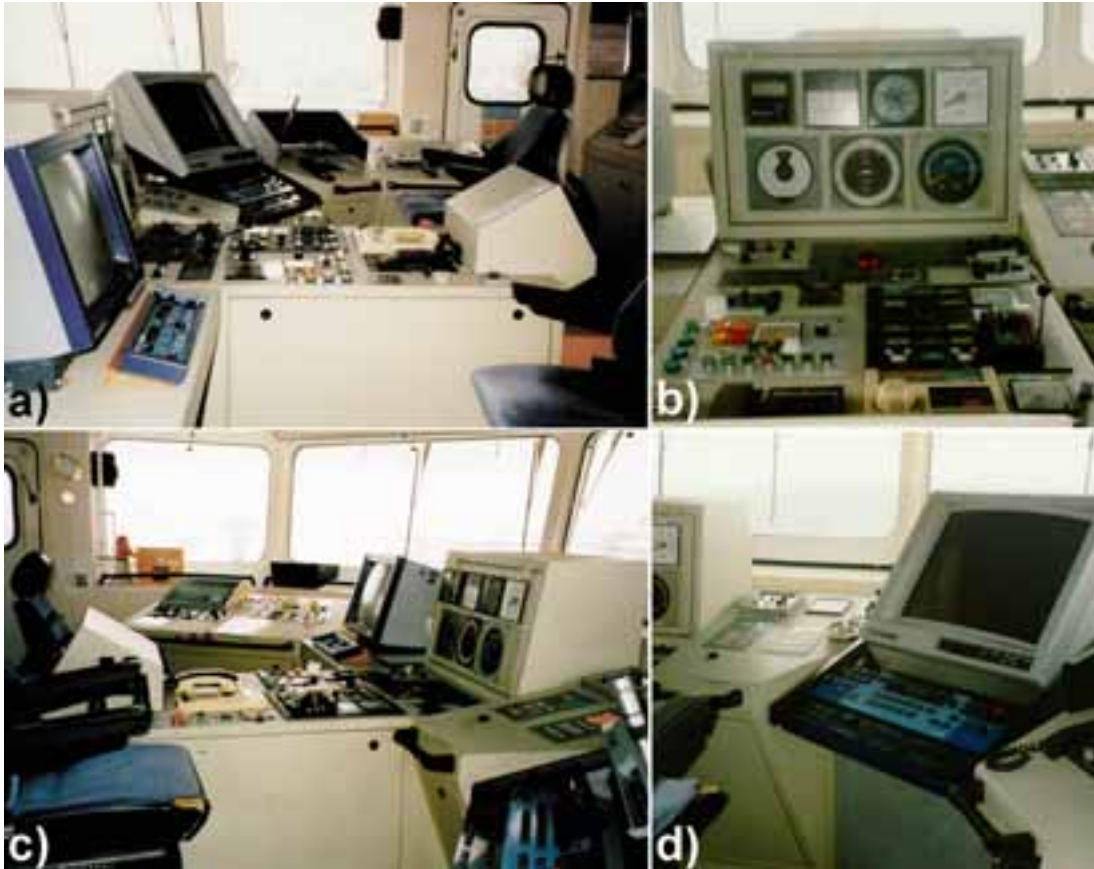
Kuva 4a-d. Ohjauslaitteiden sijoittelu CRYSTAL AMETHYSTin komentosillalla.
