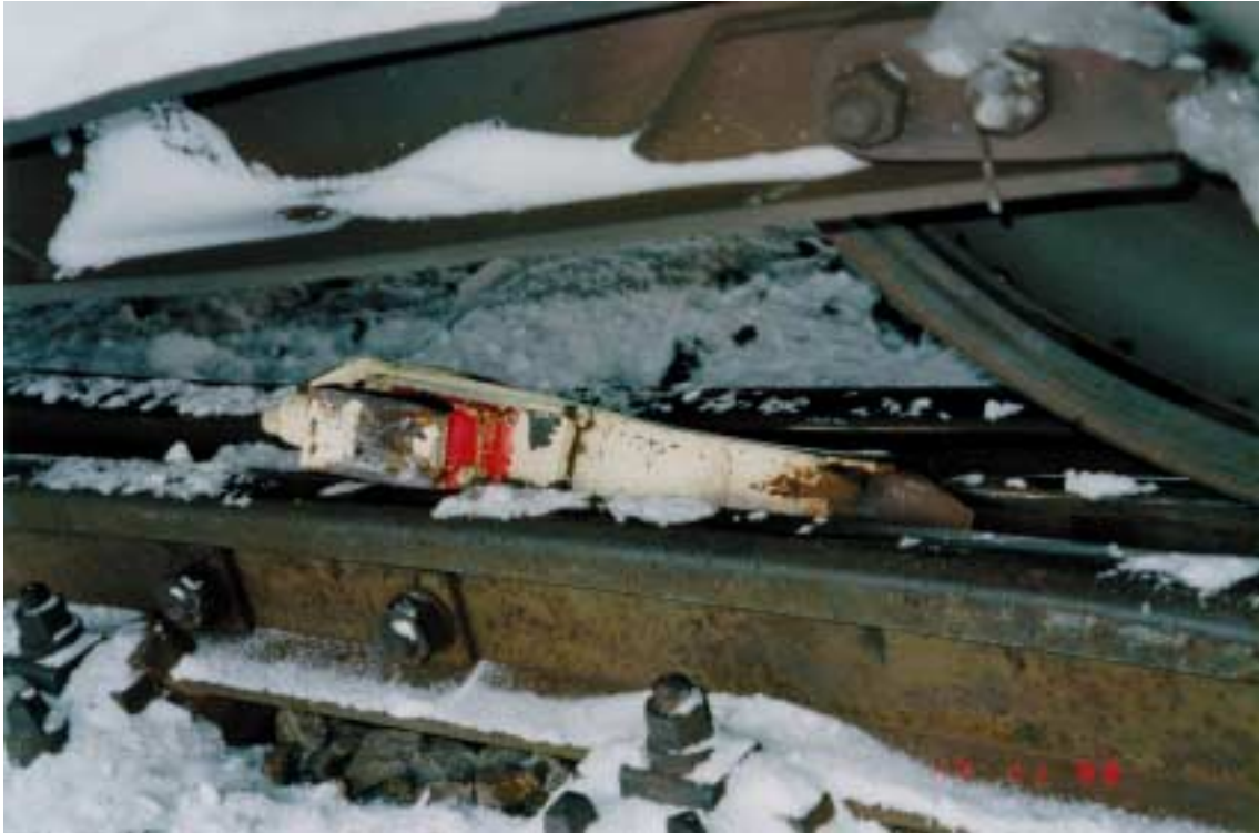
Kuva 5. Tavaravaunujen suistuminen kiskoilta Tampereella 17.11.1998. Vasemmalla kiskolla ollut pysäytyskenkä juuttuneena vaihteen V272 ristikkoon.
