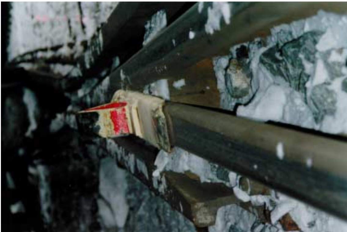
Kuva 6. Tavaravaunujen suistuminen kiskoilta Tampereella 17.11.1998. Oikealla kiskolla ollut pysäytyskenkä juuttuneena vaihteen V271 ristikkoon.
