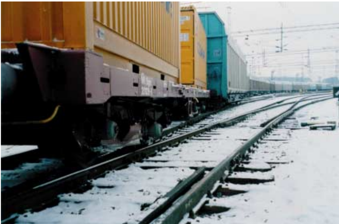
Kuva 4. Tavaravaunujen suistuminen kiskoilta Tampereella 17.11.1998. Ensimmäisen vaunun (Sgm 201226-8) etuteli suistui vasemmalle puolelle ja takateli oikealle.
