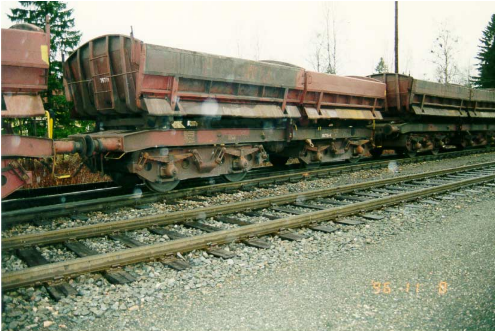
Kuva 8. 21. olleen Ome-vaunun takatelin etupyöräkerta putosi kiskoilta ja takapyöräkerta ohjautui väärälle raiteelle. Myös 22. olleen vaunun takatelin etupyöräkerta on pois kiskolta.
