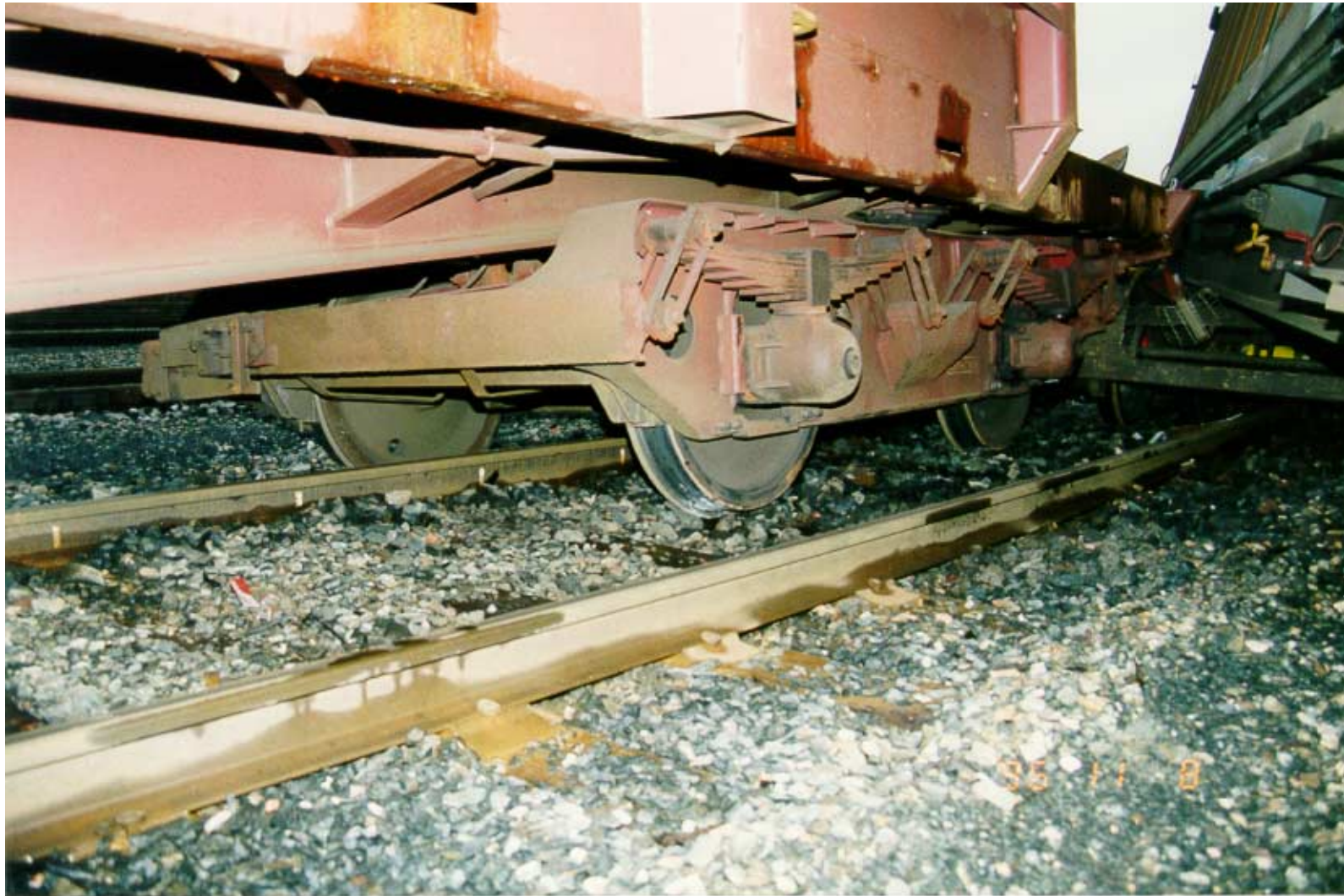
Kuva 6. Obrk-vaunun takateli suistui raiteen oikealle puolelle. Kuvassa näkyy myös Sins-vaunun etuteli sekä se miten Sins-vaunu nousi Obrk-vaunun aluskehysten päälle.
