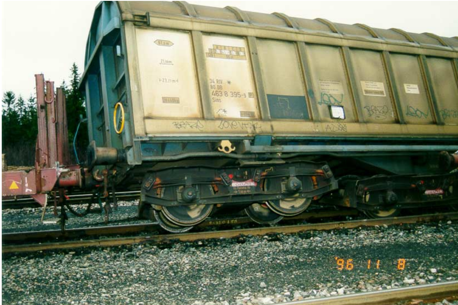
Kuva 7. Sins-vaunun takapäätä oikealta sivulta kuvattuna. Irronnut etuteli on aivan takatelin edessä.
