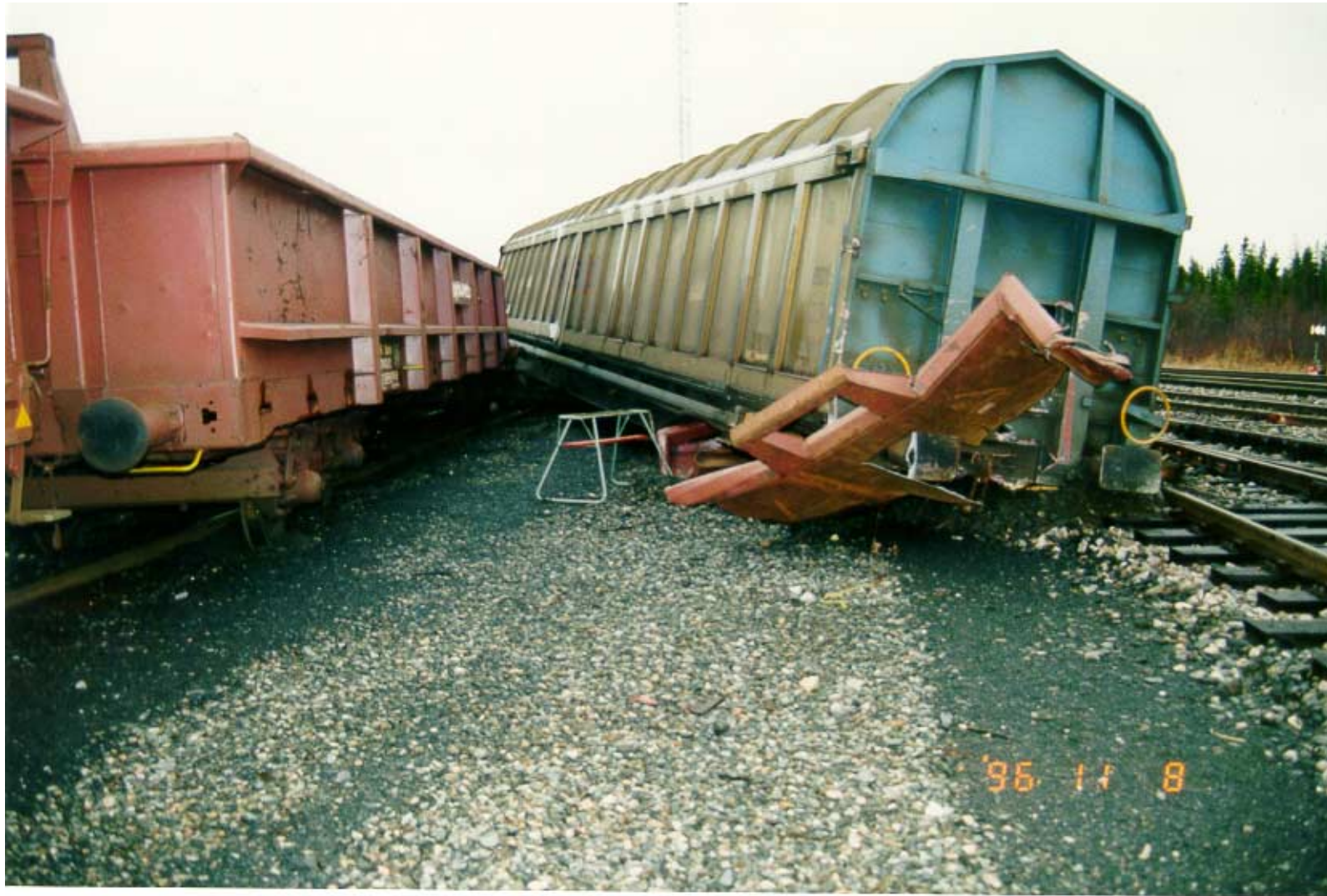
Kuva 5. Sins-vaunu suistuneena kokonaan raiteelta ja Obrk-vaunun etupään teli suistuneena vasemmalle puolelle kiskoa. Kuvassa näkyy myös Obrk-vaunun irronnut pääty.
