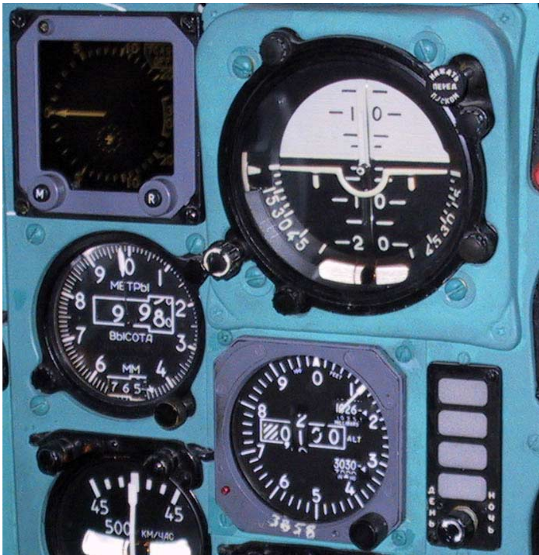
Kuva 4. IL62M:n päällikön korkeusmittarit ja TCAS:n näyttöruutu.
