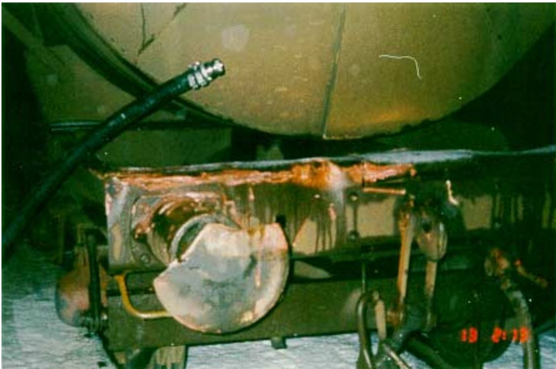
Kuva 4. Piifluorivetyhappovaunun suistuminen ja happovuoto Jämsän ratapihalla 12.12.1996. Suistuneen vaunun etupuolella kulkeneen vaunun rikkoutunut puskin.
