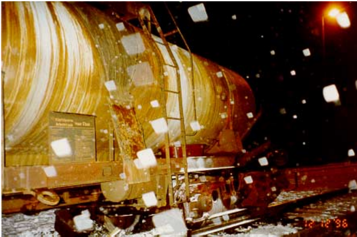
Kuva 1. Piifluorivetyhappovaunun suistuminen ja happovuoto Jämsän ratapihalla 12.12.1996. Aluksi happovuoto oli vähäinen ja käytettiin muoviasiaa vuotokohdan alla. Työskentelyä häiritsi lumisade. Figure 1. A tank wagon derailing and leaking out acid in Jämsä, on 12 December 1996. At first the leakage was slight and there was a plastic basin under the leakage spot.
