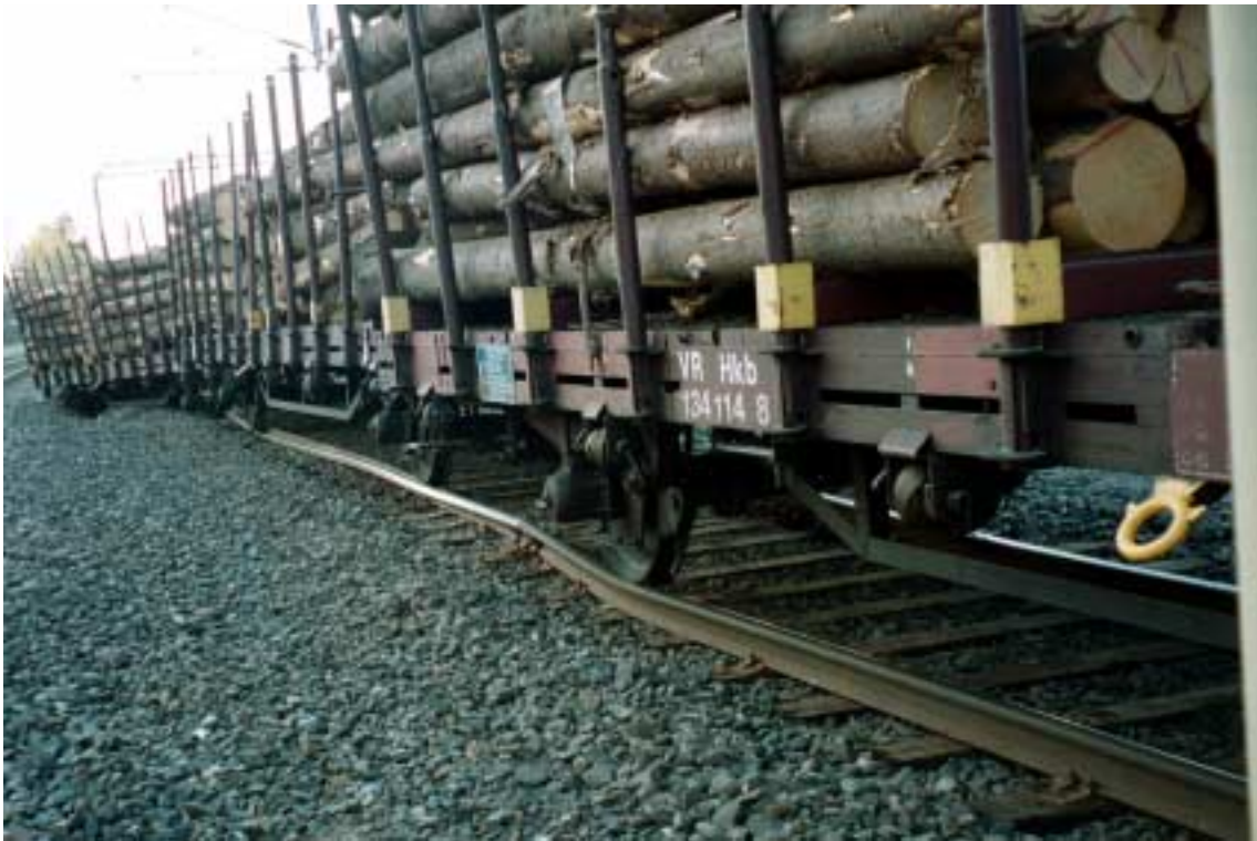
Kuva 5. Tavaravaunujen suistuminen kiskoilta Siilinjärvellä 20.5.2000. Suistuneita vaunuja vasemmalta sivulta, takaa päin, kuvattuna. Jyrkkä mutka kiskossa pyörän etupuolella. Suistumiset alkaneet siitä lähtien.
