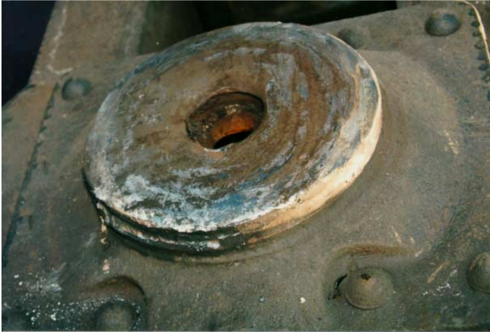
Kuva 5. Suistuneen vaunun telikeskiö. Keskiön karkeus ja voitelemattomuus on pyrkinyt estämään telin kääntymistä raskaasti lastatussa vaunussa.
