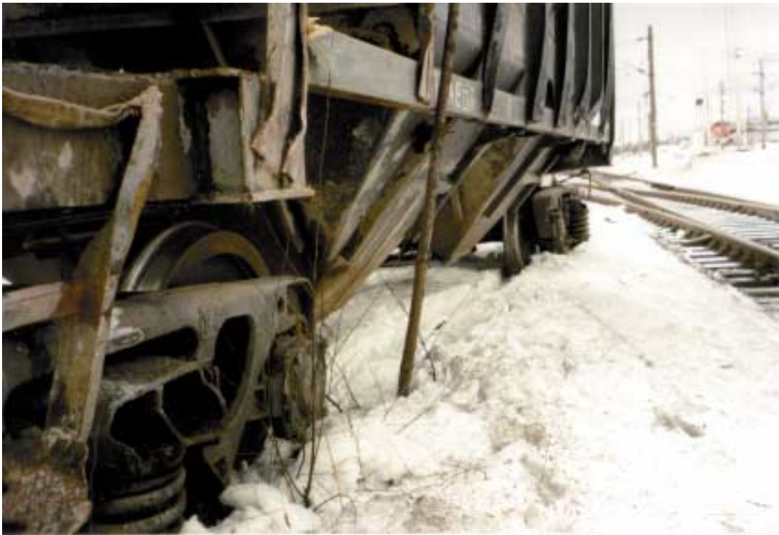
Kuva 6. Vaihtotyöveturin työntämän vaunuryhmän törmääminen tavarajunan kylkeen Kouvolassa 28.2.1998. Raidetta 229 työnnetyn vaunuryhmän ensimmäinen tyhjä venäläinen vaunu.
