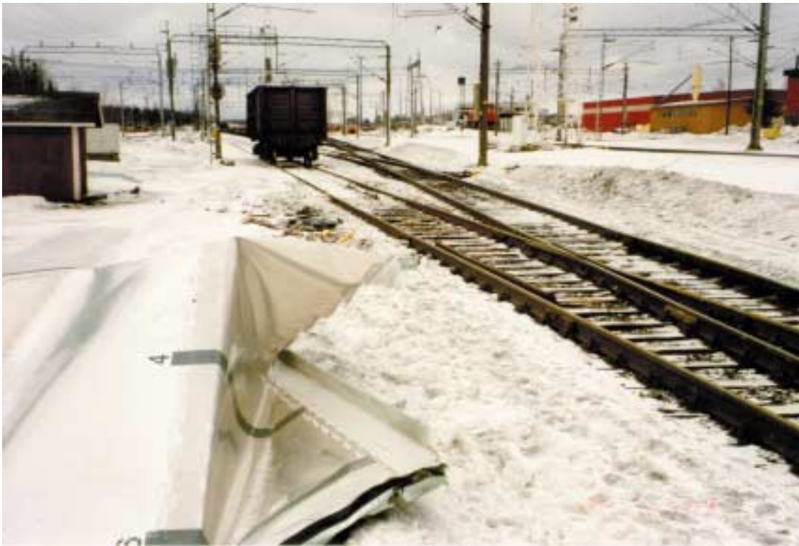
Kuva 4. Vaihtotyöveturin työntämän vaunuryhmän törmääminen tavarajunan kylkeen Kouvolassa 28.2.1998. Tavarajunan T 2600 vaunusta irronnut ovi.
