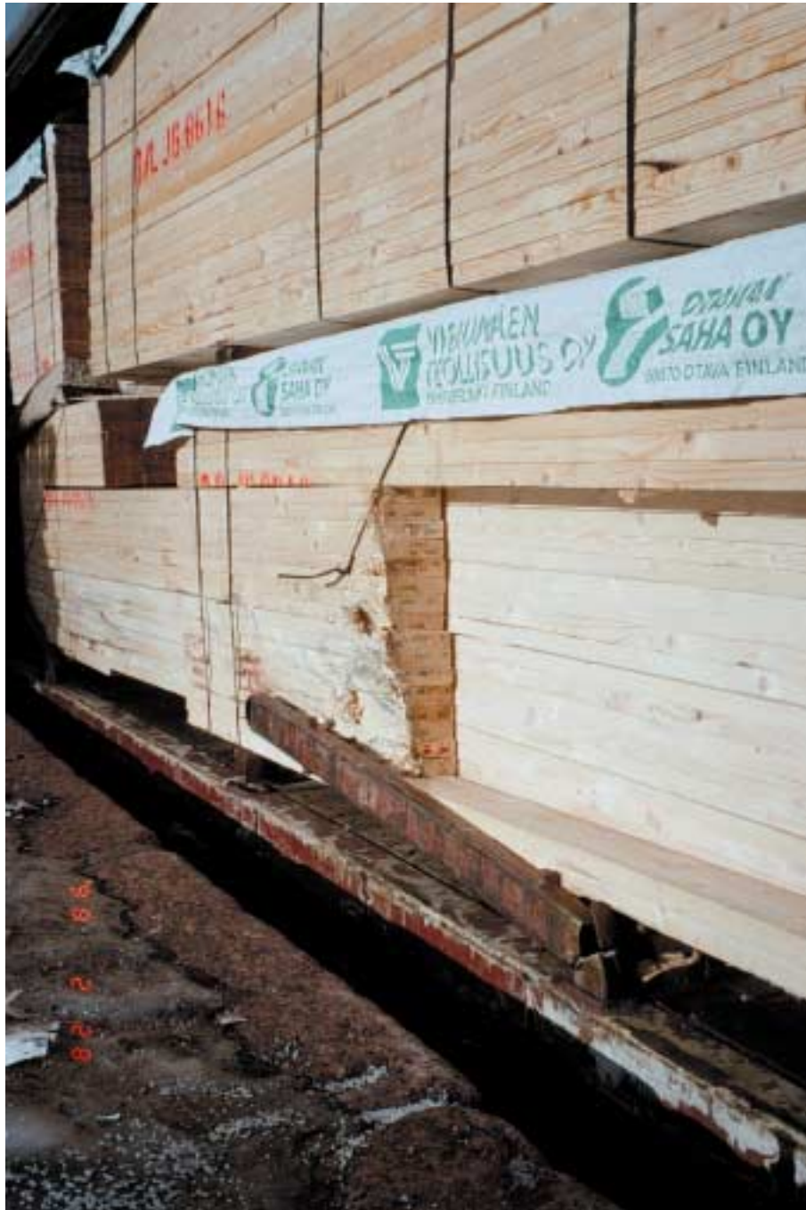
Kuva 3. Vaihtotyöveturin työntämän vaunuryhmän törmääminen tavarajunan kylkeen Kouvolaissa 28.2.1998. Tavarajunan T 2600 vaurioitunut vaunu ja sahatavaraa.
