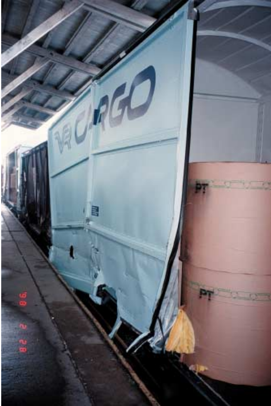
Kuva 2. Vaihtotyöveturin työntämän vaunuryhmän törmääminen tavarajunan kylkeen Kouvolaissa 28.2.1998. Tavarajunan T 2600 vaurioitunut vaunu ja paperirulla.
