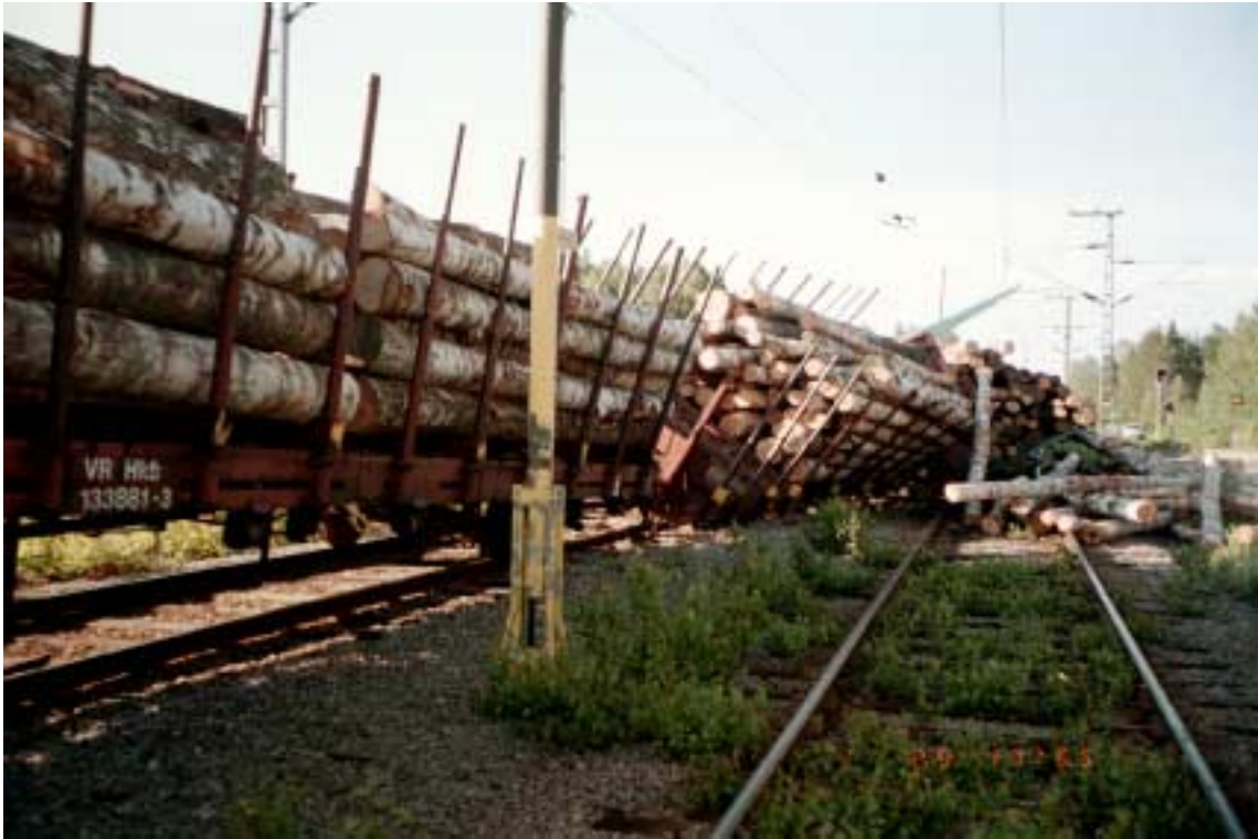
Kuva 2. Viiden puutavaravaunun suistuminen Saaren liikennepaikalla 29.6.2000. Kuva junan oikealta puolelta. Suistuneita vaunuja kaatui raiteen 2 päälle ja puutavaraa lensi raiteelle I saakka. Juna lähti liikkeelle opastimen R takaa (kuvassa näkyy opastinpylväs).
