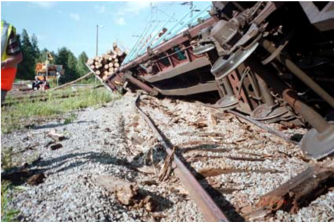
Kuva 3. Viiden puutavaravaunun suistuminen Saaren liikennepaikalla 29.6.2000. Kuva junan vasemmalta puolelta. Onnettomuudessa vaurioituivat raitapihan raiteet 2, 3 ja 4. Kuvassa suistuneiden vaunujen telien jättämiä jälkiä.
