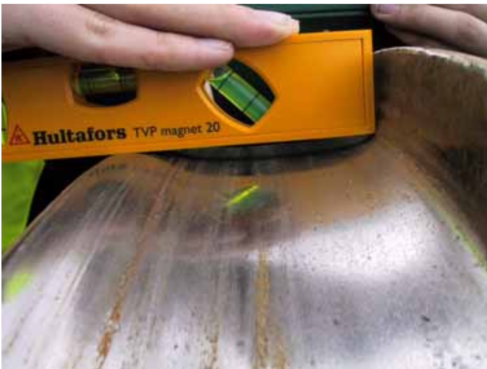
Kuva 5. Neljän venäläisen puutavaravaunun suistuminen kiskoilta Jyväskylän ratapihalla 14.5.2003. Junan kolmanneksi viimeisessä vaunussa ollut huonokuntoinen pyörä. Kuvassa nähtävillä kuopalle painunut/kulunut kulkukehä.
