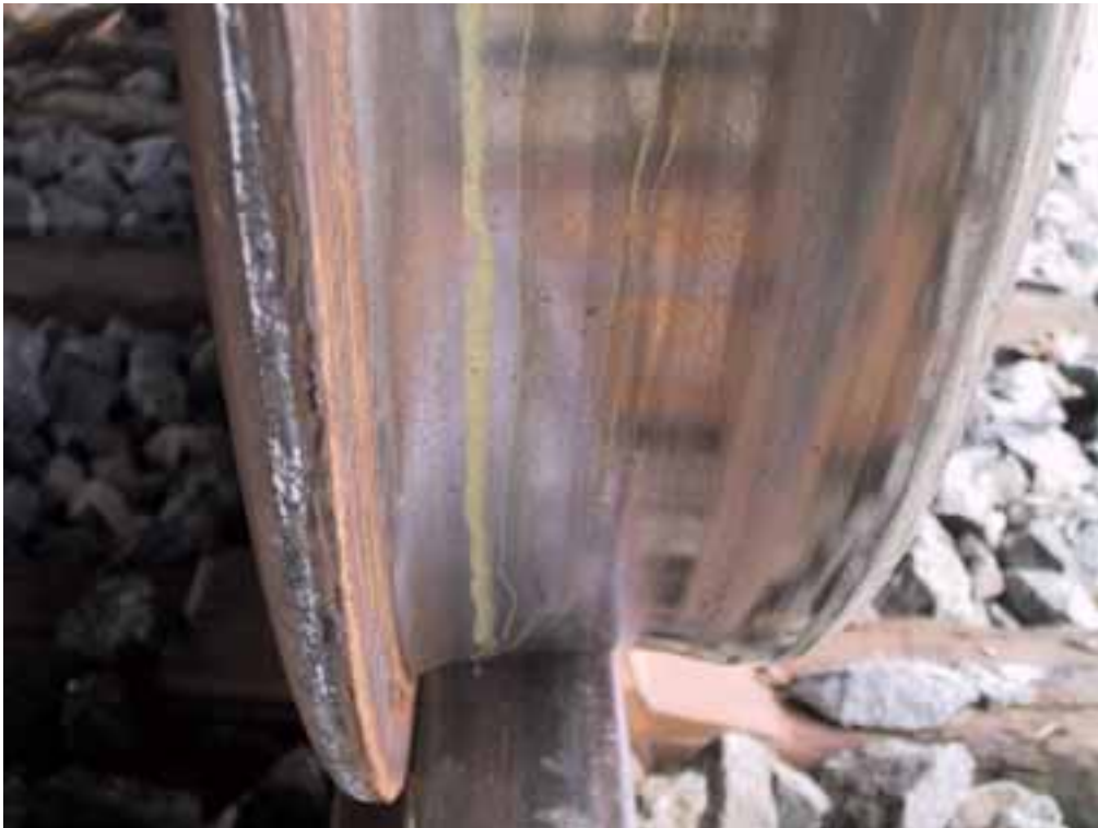
Kuva 4. Neljän venäläisen puutavaravaunun suistuminen kiskoilta Jyväskylän ratapihalla 14.5.2003. Junan viidenneksi viimeisessä vaunussa ollut huonokuntoinen pyörä.
