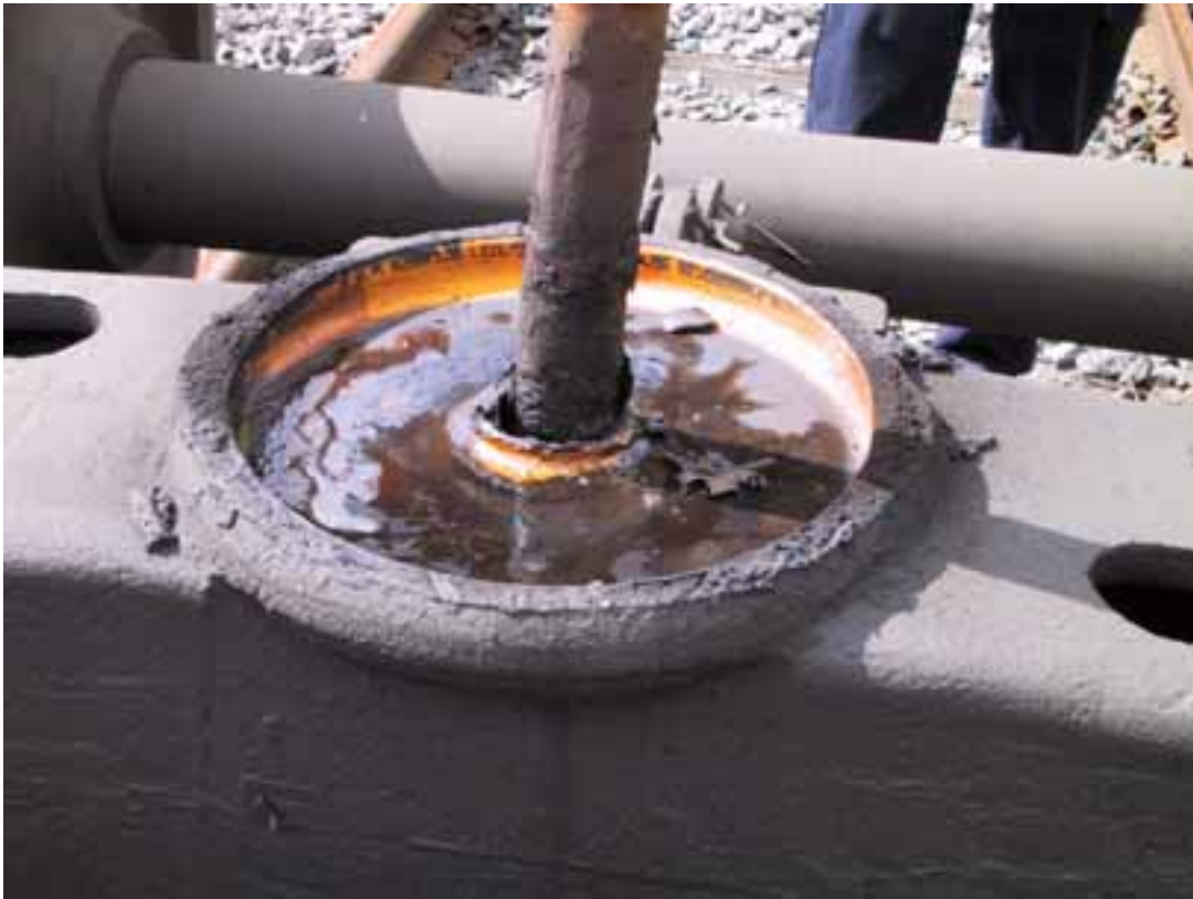
Kuva 6. Neljän venäläisen puutavaravaunun suistuminen kiskoilta Jyväskylän ratapihalla 14.5.2003. Junan viidenneksi viimeisessä vaunussa ollut telikeskiö. Pohjalla näkyvä neste on ruosteista vettä.
