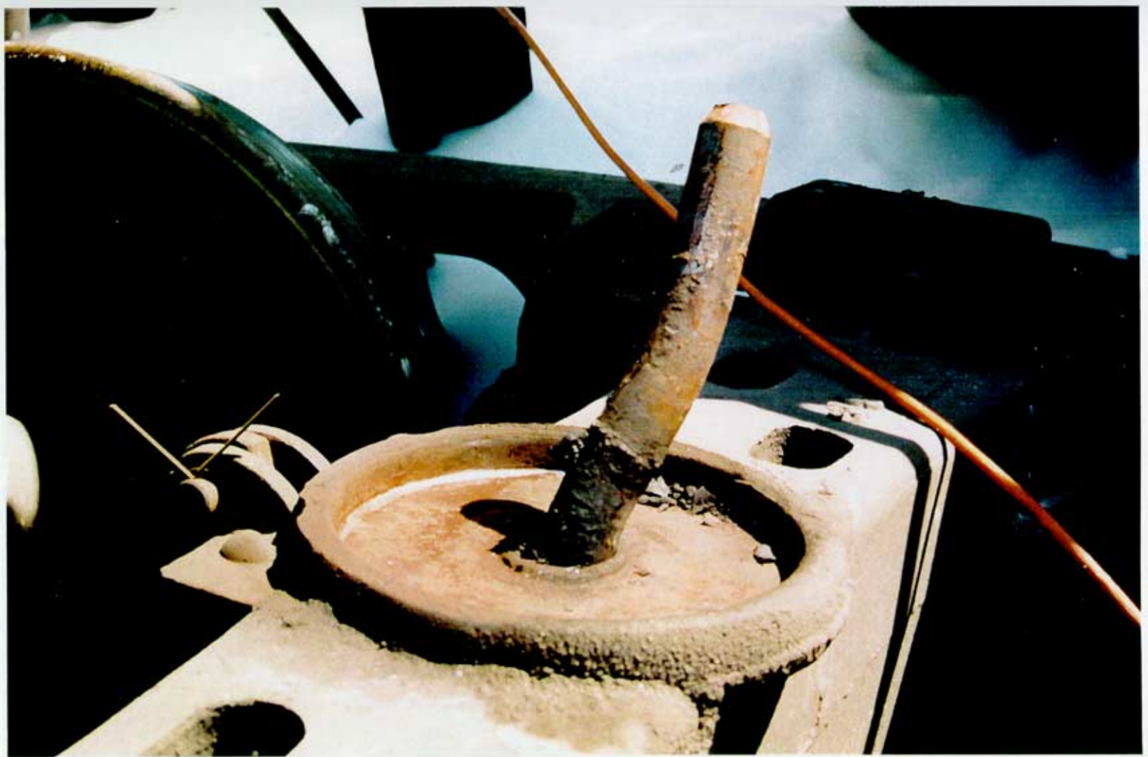
Vääntynyt Vgobo-säiliövaunun lavetin tappi, joka pitää säiliötä paikallaan
