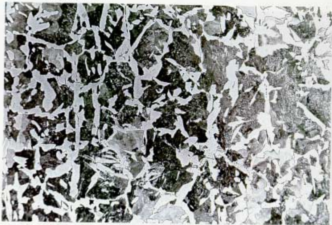
Kuva 5. Kiskomateriaalin mikrorakenne (200x). Perinnäisen austeniitin raerajoille syntynyttä ferriittiä ja perliittiä. Raekoko n 0.1 mm eli melko karkea.
