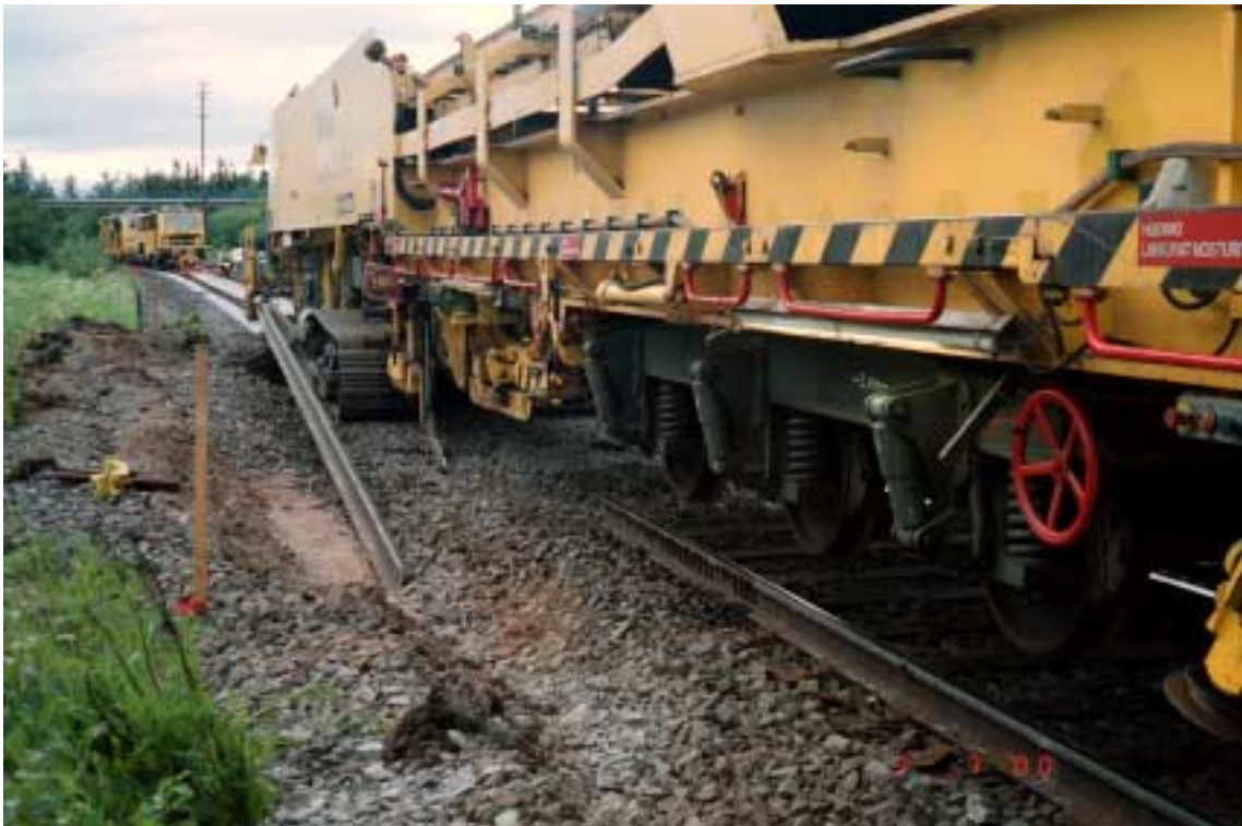
Kuva 5. Pölkkyjen kuljetusyksikön ja raiteenvaihtoyksikön yhteentörmäys Olhavassa 3.7.2000. Raiteenvaihtokone siirtyi törmäyksen voimasta noin kahdeksan metriä pohjoisen suuntaan.
