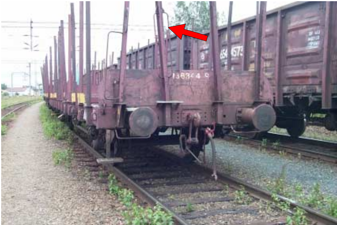
Kuva 2. Junamiehen loukkaantuminen vaihtotyössä Haminan ratapihalla 7.8.2000. Kuva viimeisestä vaunusta jossa junamies oli seisomassa. Hän piti kiinni nuolen osoittamasta käsirivasta.
