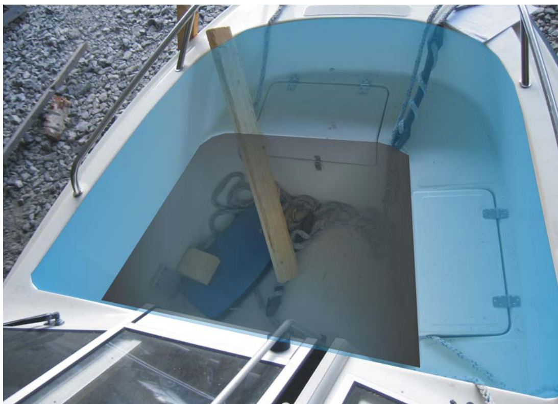
Kuva 6. Keulan avotila. Penkkien yläpinnan muodostaman tason (kuvan harmaa taso) alapuoliseksi tilavuudeksi mitattiin karkeasti noin 300 l ja penkkien yläpinnan ja veneen laidan tason (kuvassa sininen taso) välisen alueen tilavuudeksi noin 400 l.
