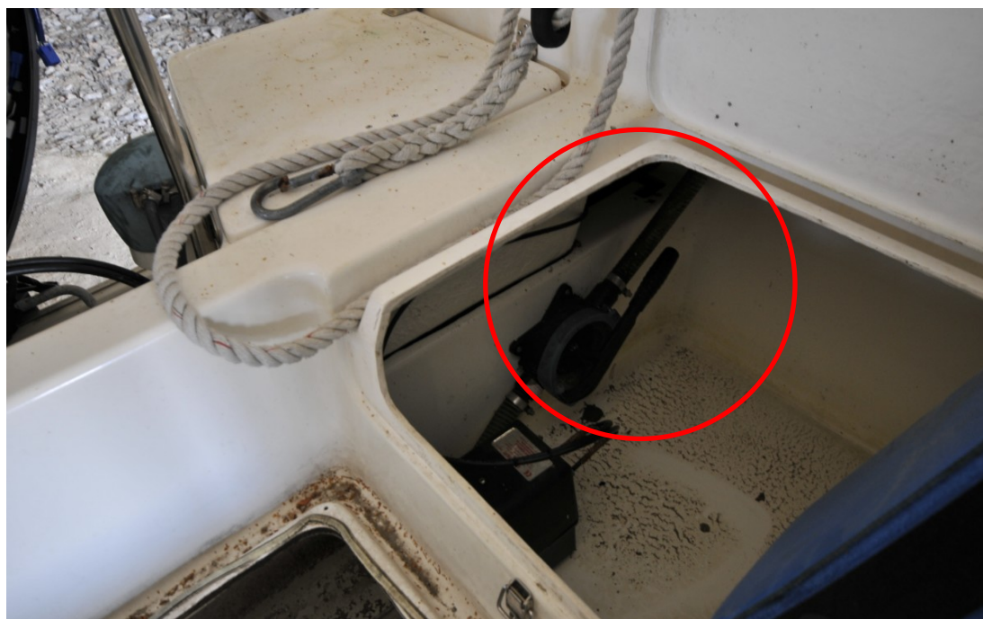
Kuva 11. Punaisella ympyrällä on merkitty käsikäyttöinen pilssipumppu veneen takakannella PB-puoleisessa kotelossa. Katso myös kuva 9.
