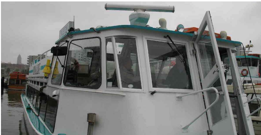
Kuva 20. QUEEN. Tutka-antennin sijoituspaikka ohjaamon katolla.
