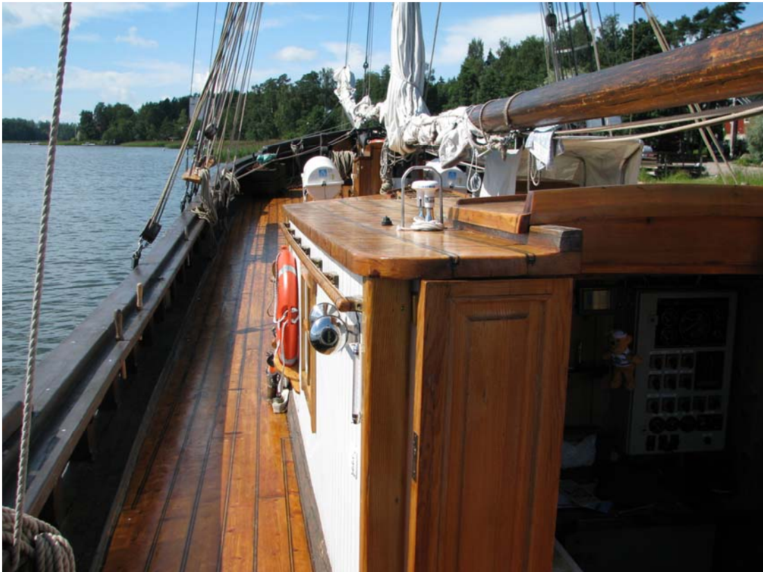
Kuva 2. Kuva on otettu ohjailupaikalta noin 1 m vasemmalle. Navigointilaitteet ovat avatun kajuutan oven takana. Keulan eteen jää noin 100 metrin katve ohjailupaikalta
