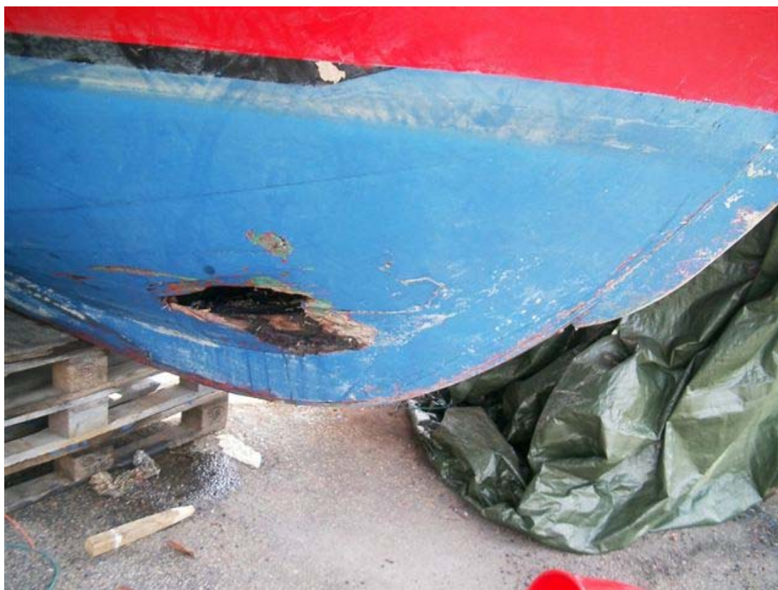
Kuva 2. Reikä aluksen pohjassa.
