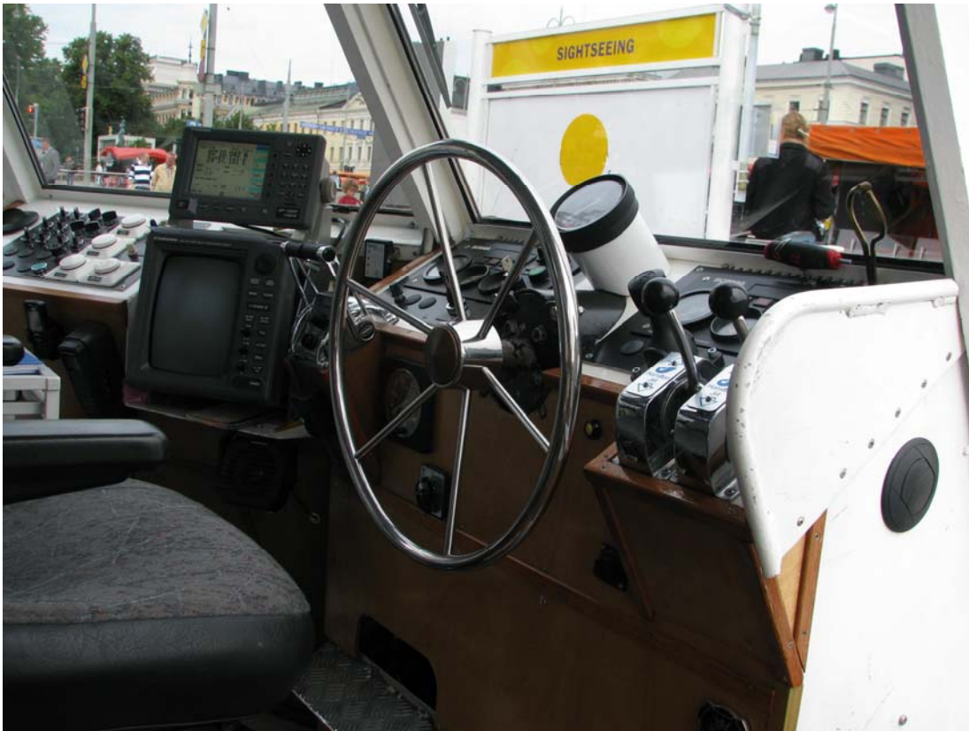
Kuva 2. Ohjaamo; hälytyspaneeli on ruorin yläpuolella
