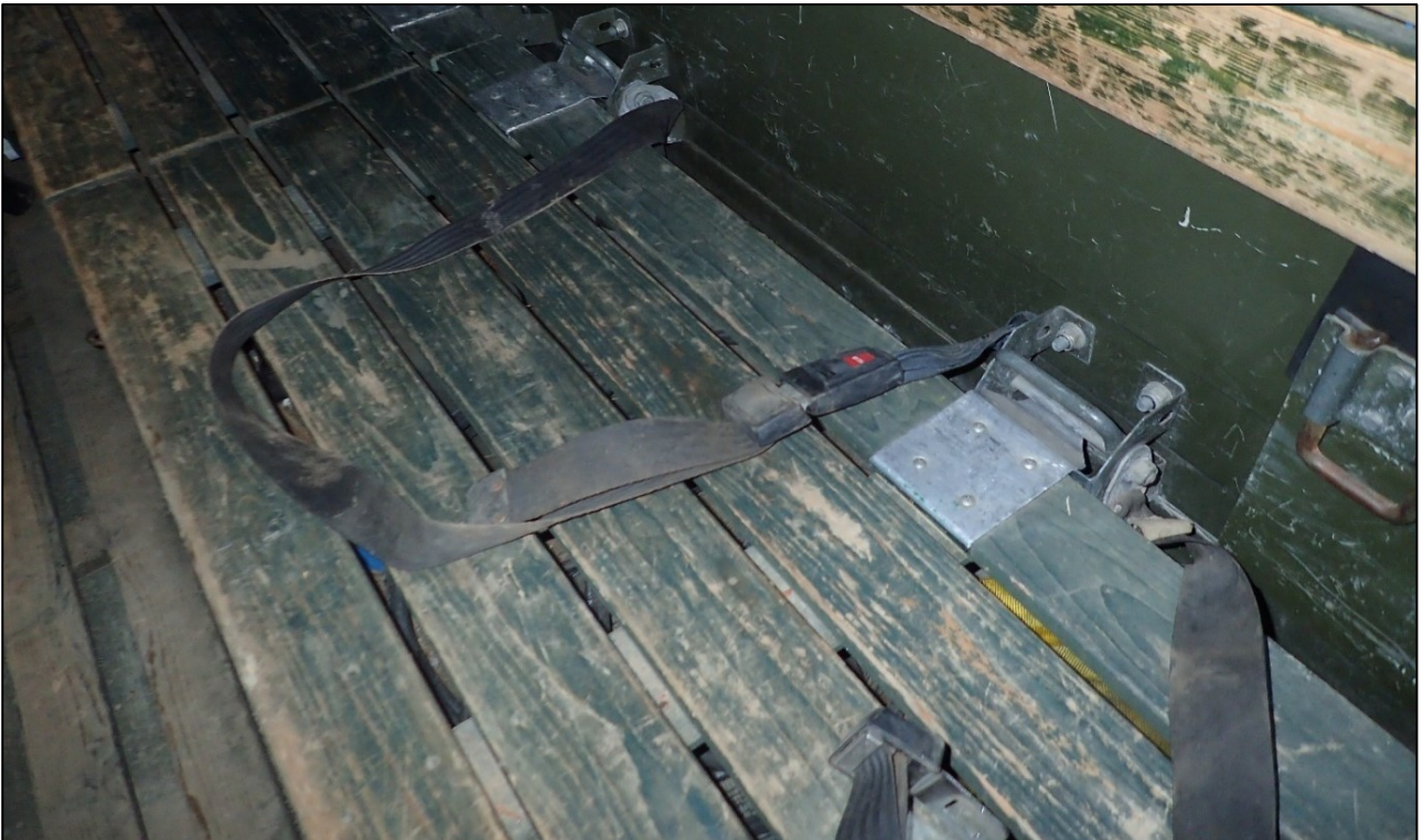
Kuva 6. Takavaunun istumapaikoilla olevat lannevyöt joutuvat helposti istuinalustojen taakse tai alle. (Kuva: OTKES)
