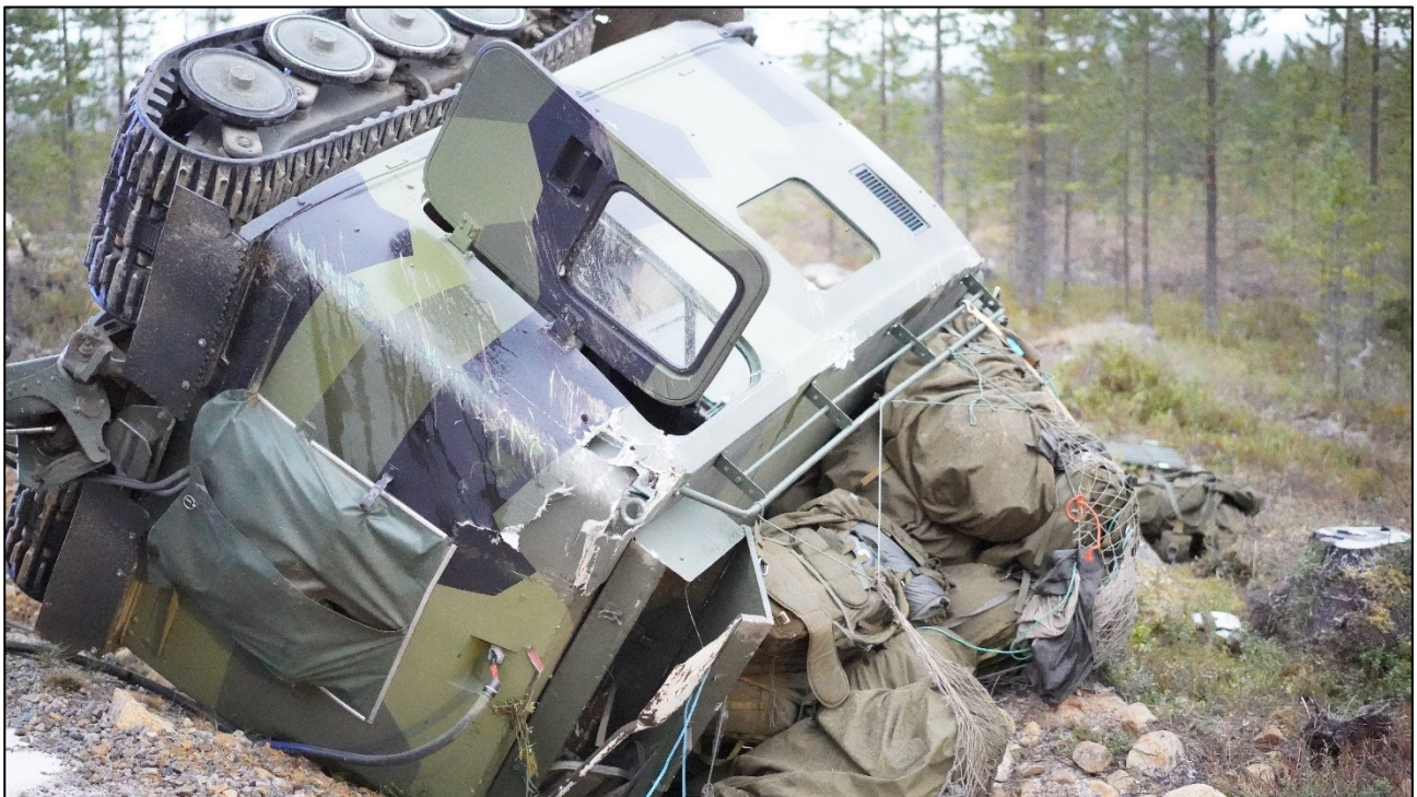
Kuva 7. Tela-ajoneuvon takavaunu kaatuneena onnettomuuspaikalla. (Kuva: Rajavartiolaitos)
