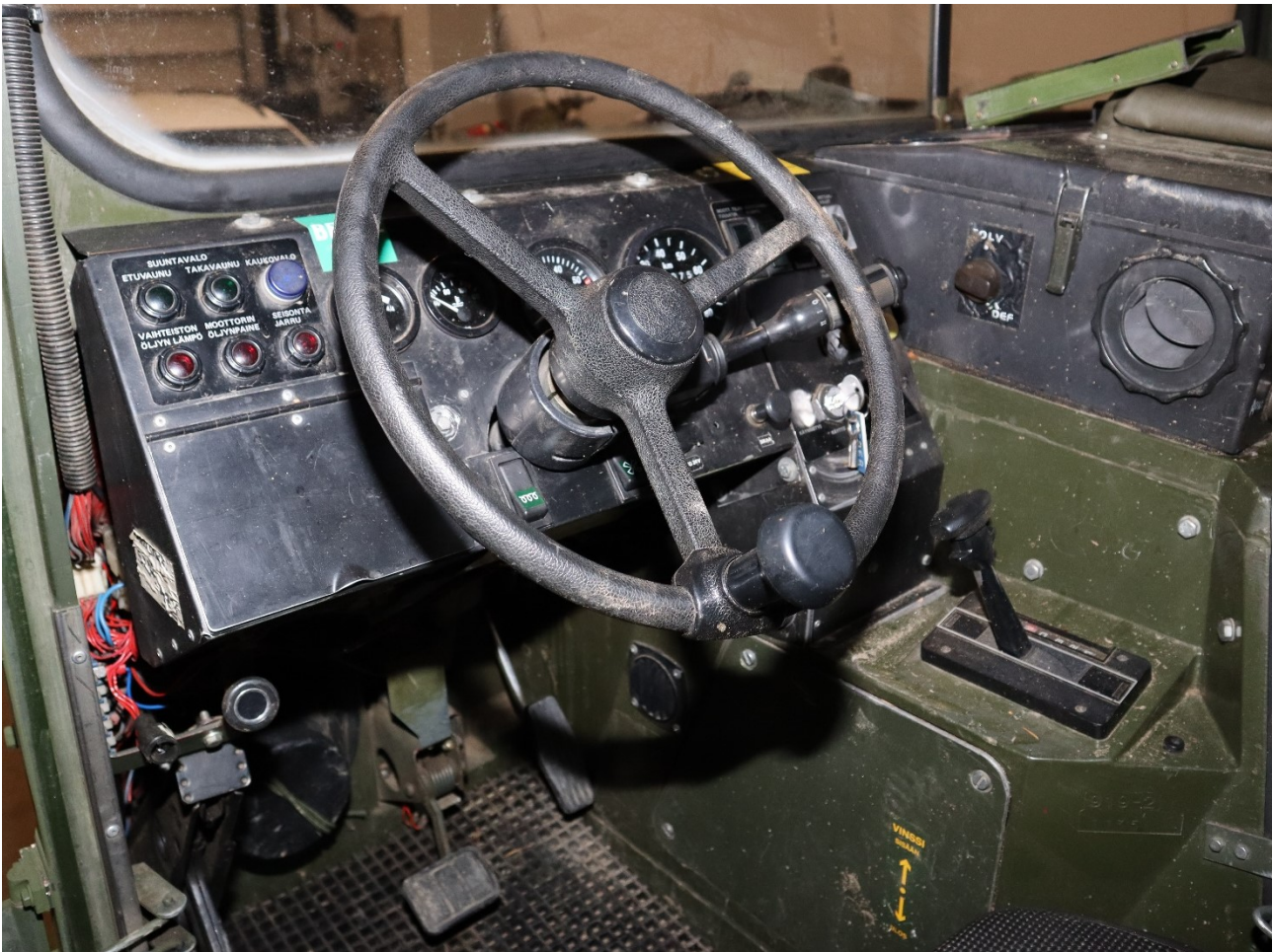
Kuva 4. Tela-ajoneuvon ohjauspyörään kiinnitetty ohjausnuppi, jolla nopeutetaan ohjauspyörän kääntämistä. (Kuva: OTKES)
