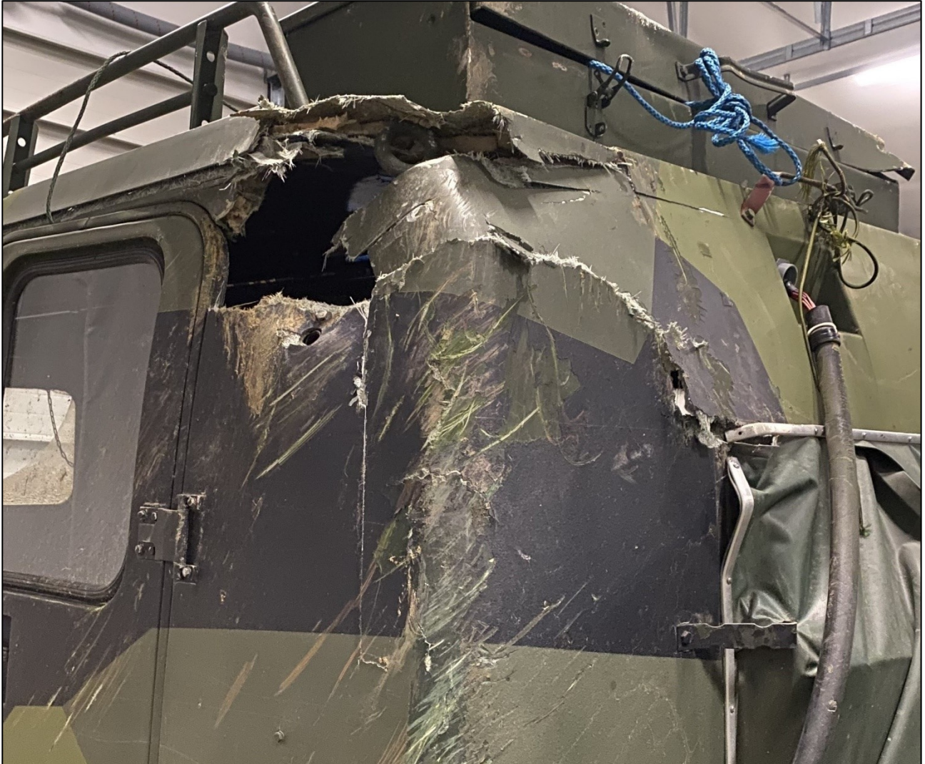
Kuva 2. Tela-ajoneuvon takavaunun vaurioitunut korirakenne. (Kuva: OTKES)
