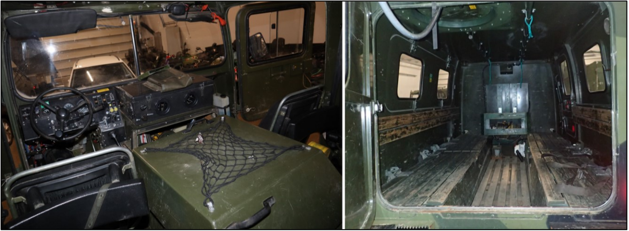
Kuva 5. Kuvat etu- ja takavaunun sisätiloista. Vasemmalla etuvaunun sisätila, josta kuvassa näkyy kuljettajan ja etumatkustajan istuimet sekä näiden takana selkä menosuuntaan olevien matkustajien istuinten selkänojat. Kuvassa näkyvä moottorin suojakansi on pois paikaltaan. Oikeanpuoleisessa kuvassa takavaunun sisätila takaovelta kuvattuna. Matkustamon etuseinässä näkyy puukehikolla ympäröity vinssi. (Kuvat: OTKES)
