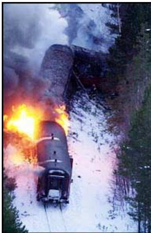
Kuva 10. Norjassa Åstassa 4.1.2000 tapahtunut dieselkäyttöisen moottorijunan ja pikajunan yhteentörmäys, jossa menehtyi 19 ihmistä. Dieselveturi syttyi tuleen, josta palo levisi 1960-luvulla rakennettuihin vaunuihin, joiden sisustus oli helposti palavaa materiaalia. Palo kesti noin kuusi tuntia. 18
