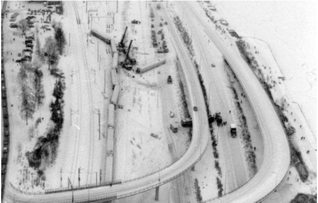
Kuva 6. Jyväskylän junaonnettomuudessa 6.3.1998 pikajuna ajoi vaihteeseen liian suurella nopeudella. Juna suistui, minkä seurauksena 10 ihmistä menehtyi. 11
