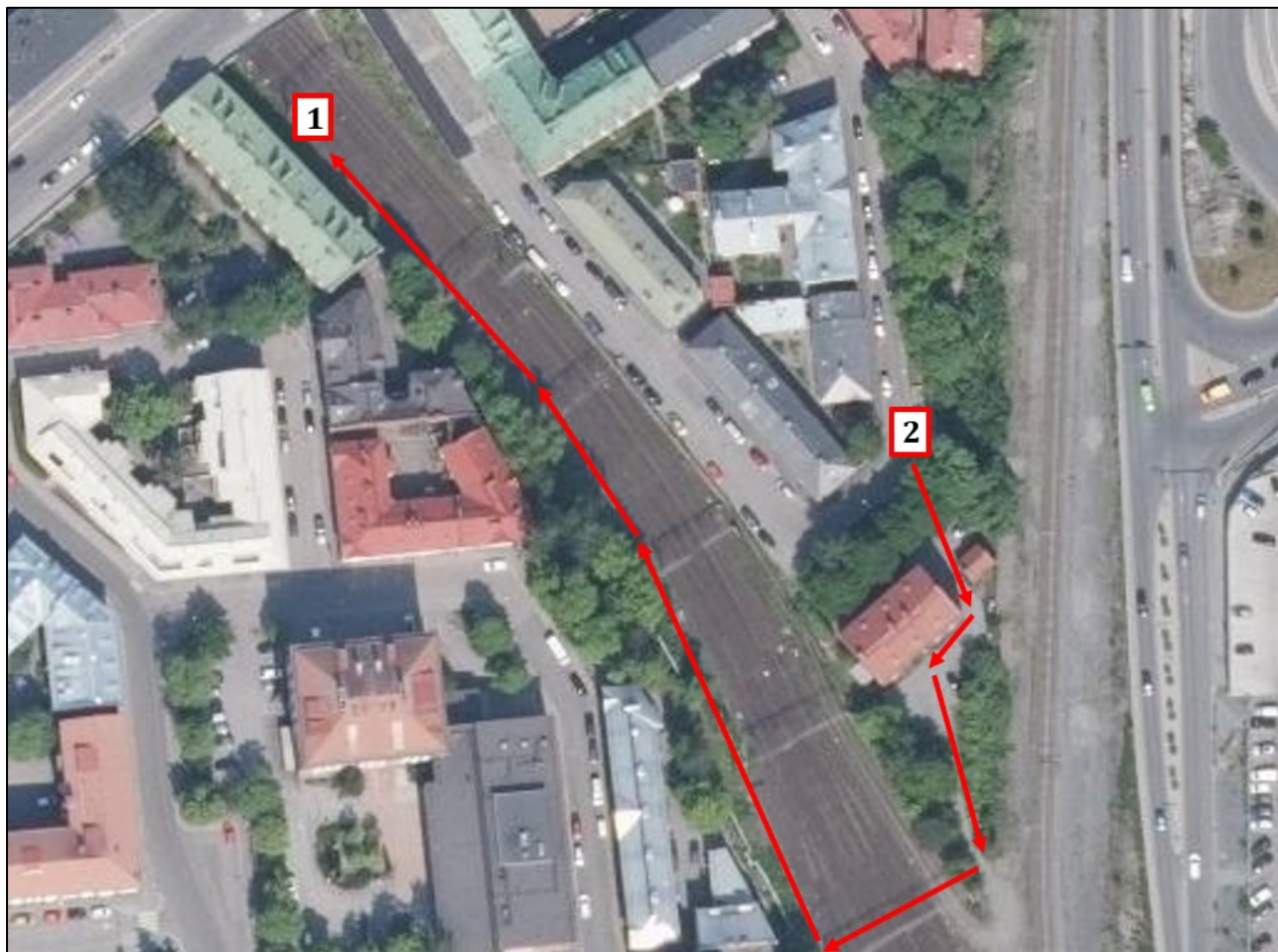
Kuva 5. Havainnekuva raivaustoiminnan työskentelyalueesta. Kuvaan on merkitty suistuneen veturin sijainti (1) ja raivausauton sijoituspaikka (2). Raivauskaluston siirtoreitti raivausautolta suistumispaikalle on merkitty punaisilla nuolilla. (Ilmakuva ©Maanmittauslaitos 7/2024, Merkinnät: OTKES)
