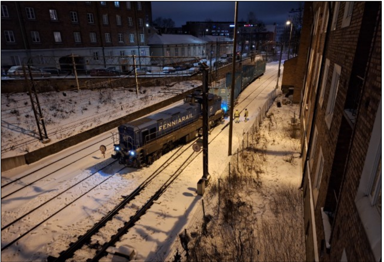
Kuva 4. Tilanne suistumisen jälkeen. Kuvanottohetkellä junan 19 viimeistä vaunua oli viety pois liikennehäiriöiden vaikutusten vähentämiseksi. Kuvan kaksi oikeanpuoleista raidetta olivat liikenteeltä suljettuina. (Kuva: OTKES)
