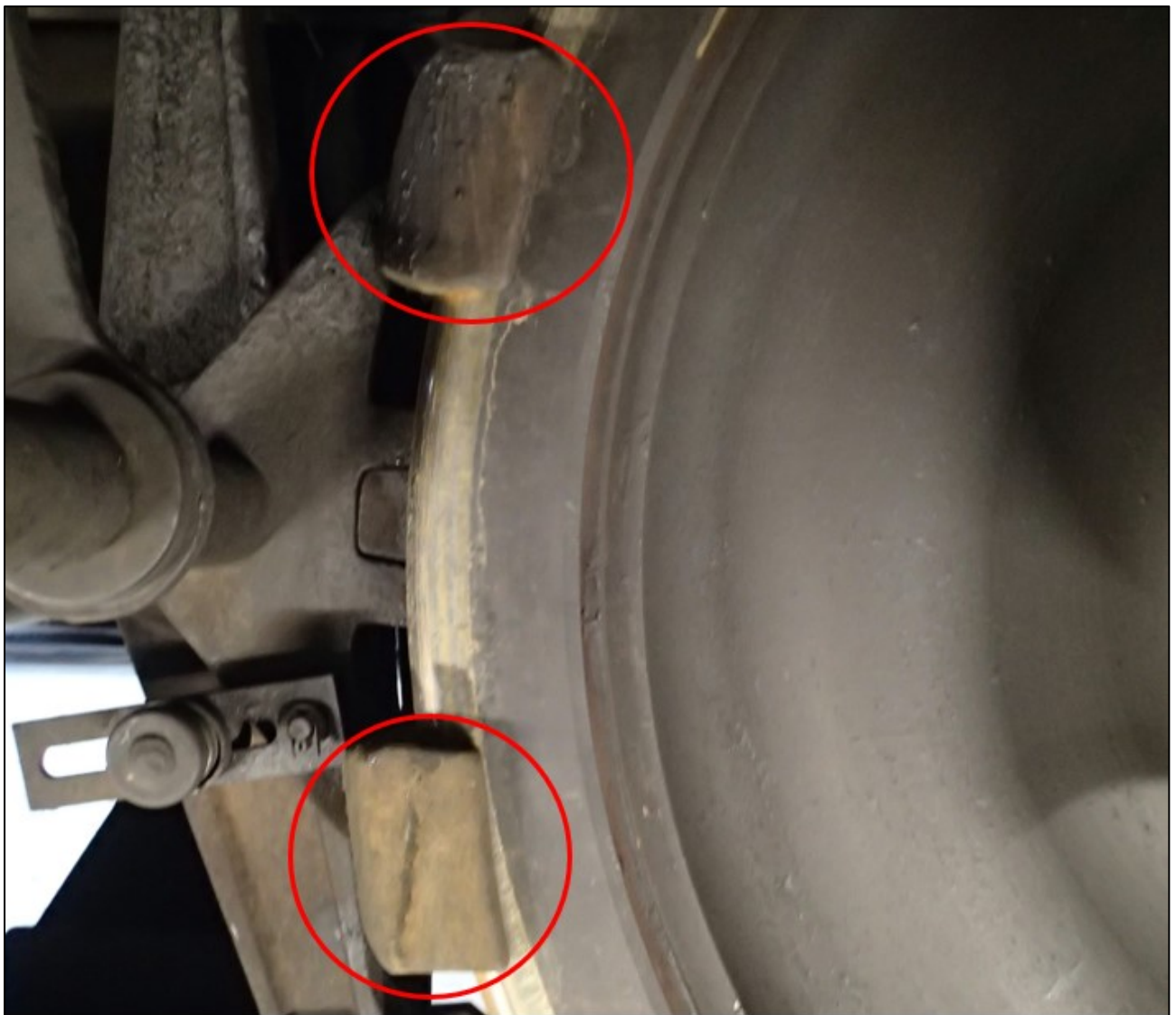
Kuva 14. Dr18-veturin jarrutönkkä pyörän sisäpuolelta kuvattuna. Jarrutönkässä olevat pyörän laipan yli kaartuvat kitkapinnan osat ovat kuvassa ympyröitynä. (Kuva ja Merkinnot: OTKES)
