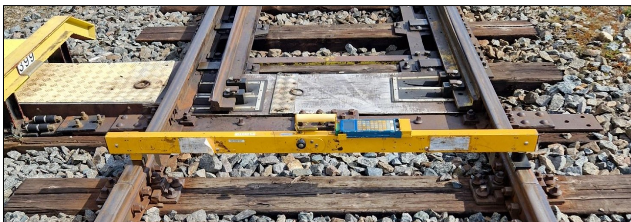
Kuva 21. Vaihteen RATO-ohjeen mukainen mittaus Vatjus-mittauslaitteella. Kuvassa mitataan vaihteen a-mittaa. (Kuva: OTKES)
