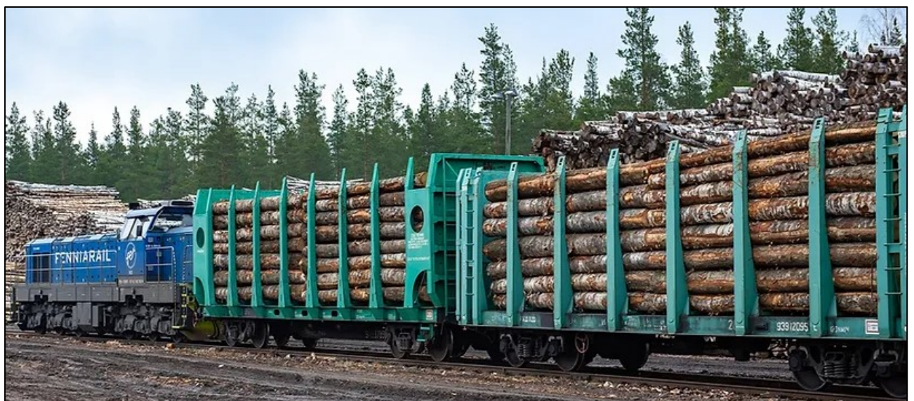
Kuva 18. Vop-raakapuuvaunu. (Kuva: Fenniarail)
