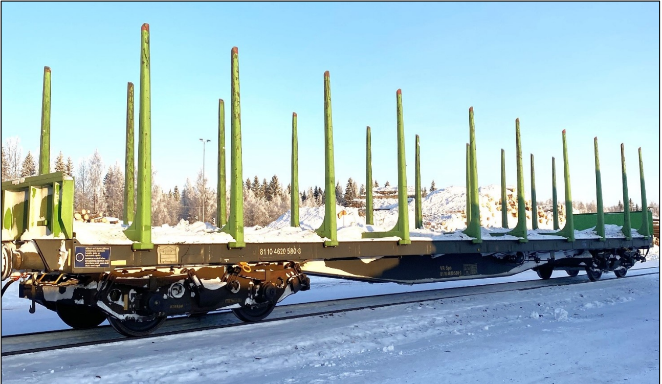
Kuva 12. Sp-sarjan raakapuuvaunu. (Kuva: OTKES)
