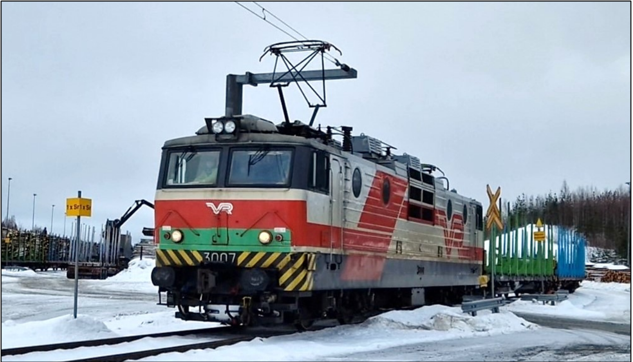
Kuva 14. Havainnekuva, jossa Sr1-sähköveturi työntää raakapuuvaunuja Kurkimäen raiteelle 006. Kuvassa näkyy ajojohtimen päätyminen sekä veturin ohjaamon ja vaunujen kohdistuspaikka-merkit. (Kuva: OTKES)
