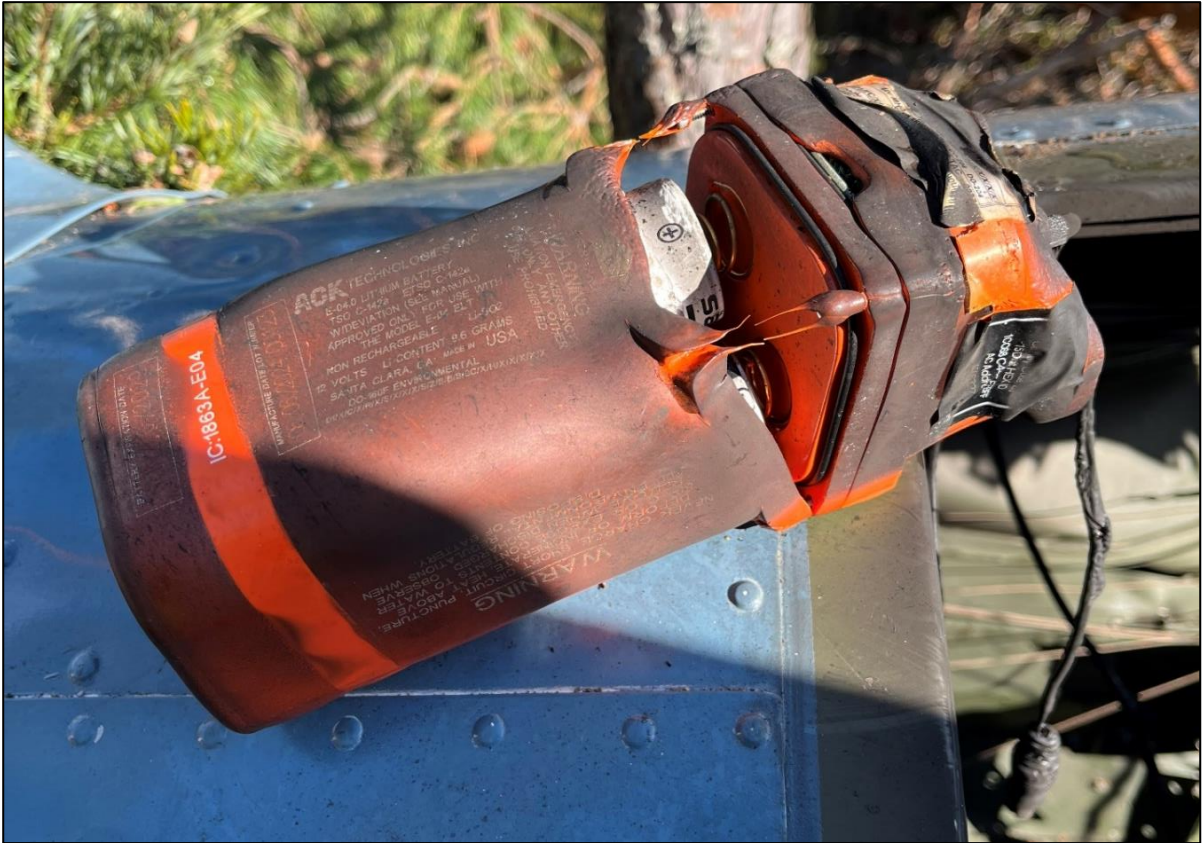
Kuva 17. ELT-hätälähetin törmäyksen ja tulipalon jälkeen. Paristokotelo on lähes irronnut lähettimestä, mutta paristot ovat kuitenkin edelleen kontaktissa lähettimeen. (Kuva: OTKES)
