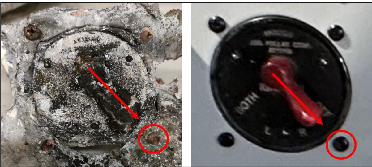
Kuva 19. Lentokoneen magneettokytkin oli onnettomuuden jälkeen OFF-asennossa. Oikeanpuolei- sessa kuvassa magneettokytkin alkuperäisessä kunnossa. (Kuvat: OTKES, lentokoneen omistaja, muokkaukset: OTKES)
