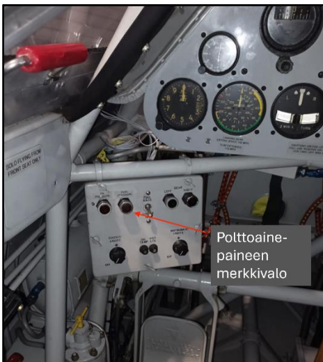
Kuva 8. Polttoainepaineen merkkivalon sijainti OH-NAT:n takaohjaamossa. (Kuva: Lentokoneen omistaja).
