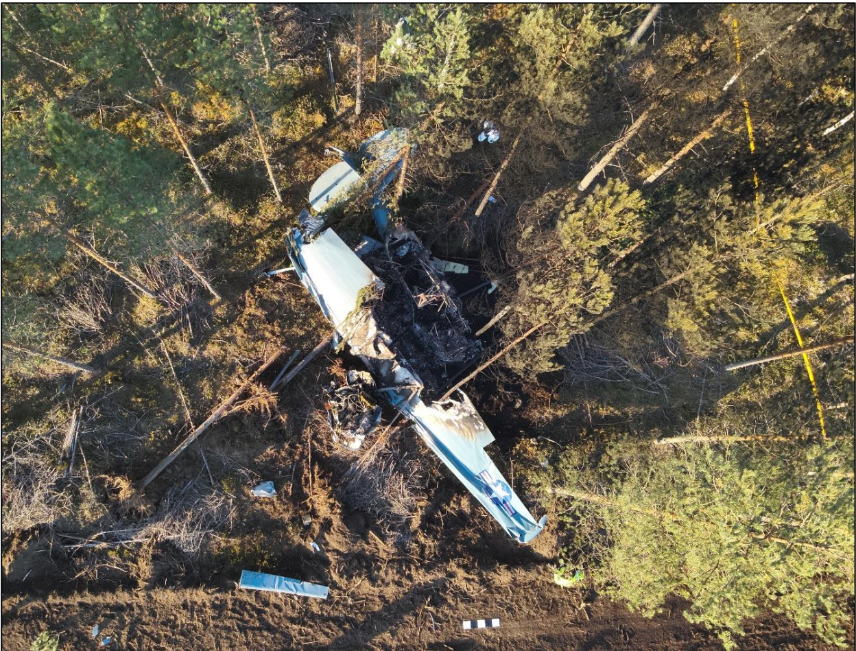
Kuva 15. Lentokone onnettomuuden jälkeen. Lentokoneen siipi repeytyi törmäyksessä irti rungosta ja lentokoneen runko tuhoutui palossa. (Kuva: OTKES)
