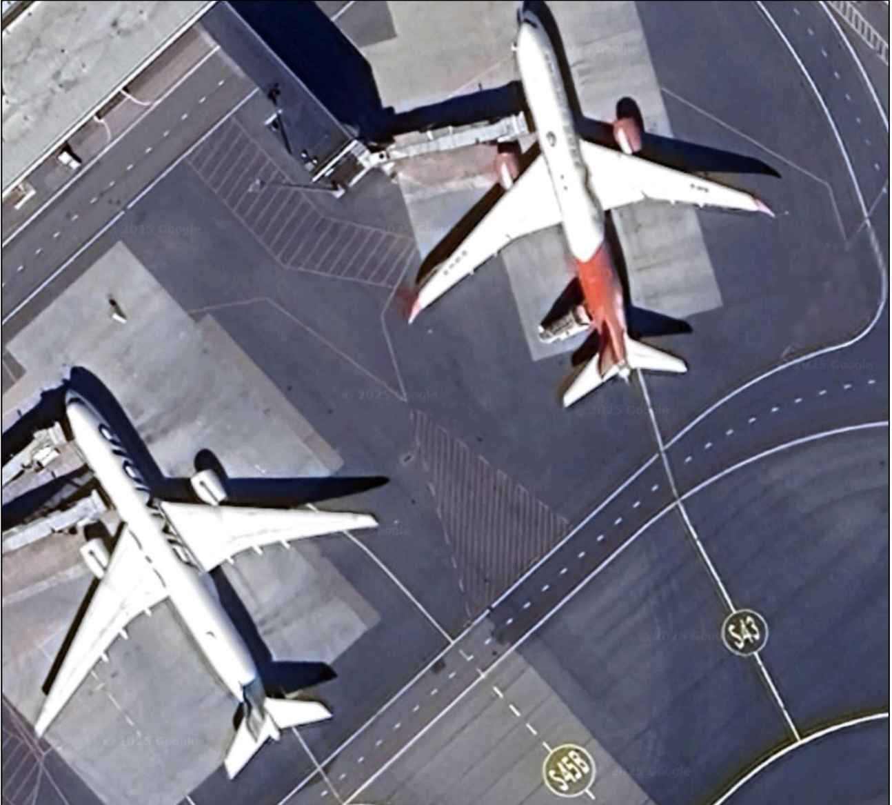
Kuva 4. Ilmakuva seisontapaikoista S45 ja S43, joiden välissä on kolmion muotoinen vinoviivoinen pysäköintikieltoalue. ERL-viiva jatkuu katkoviivana pysäköintikieltoalueen kohdalla. Kuvassa vastaavat lentokonetyypit (Airbus 350-900 ja Boeing 787-900) kuin nyt tutkittavassa tapauksessa. (Kuva: Google Maps ©2025)
