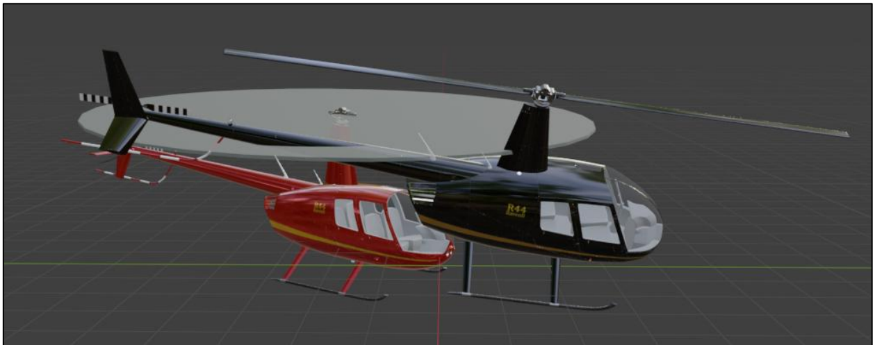
Kuva 14. Helikopterien arvioitu asento törmäyshetkellä. Arvio perustuu tässä kappaleessa kuvattuihin helikoptereiden vaurioihin. (Kuva: OTKES)
