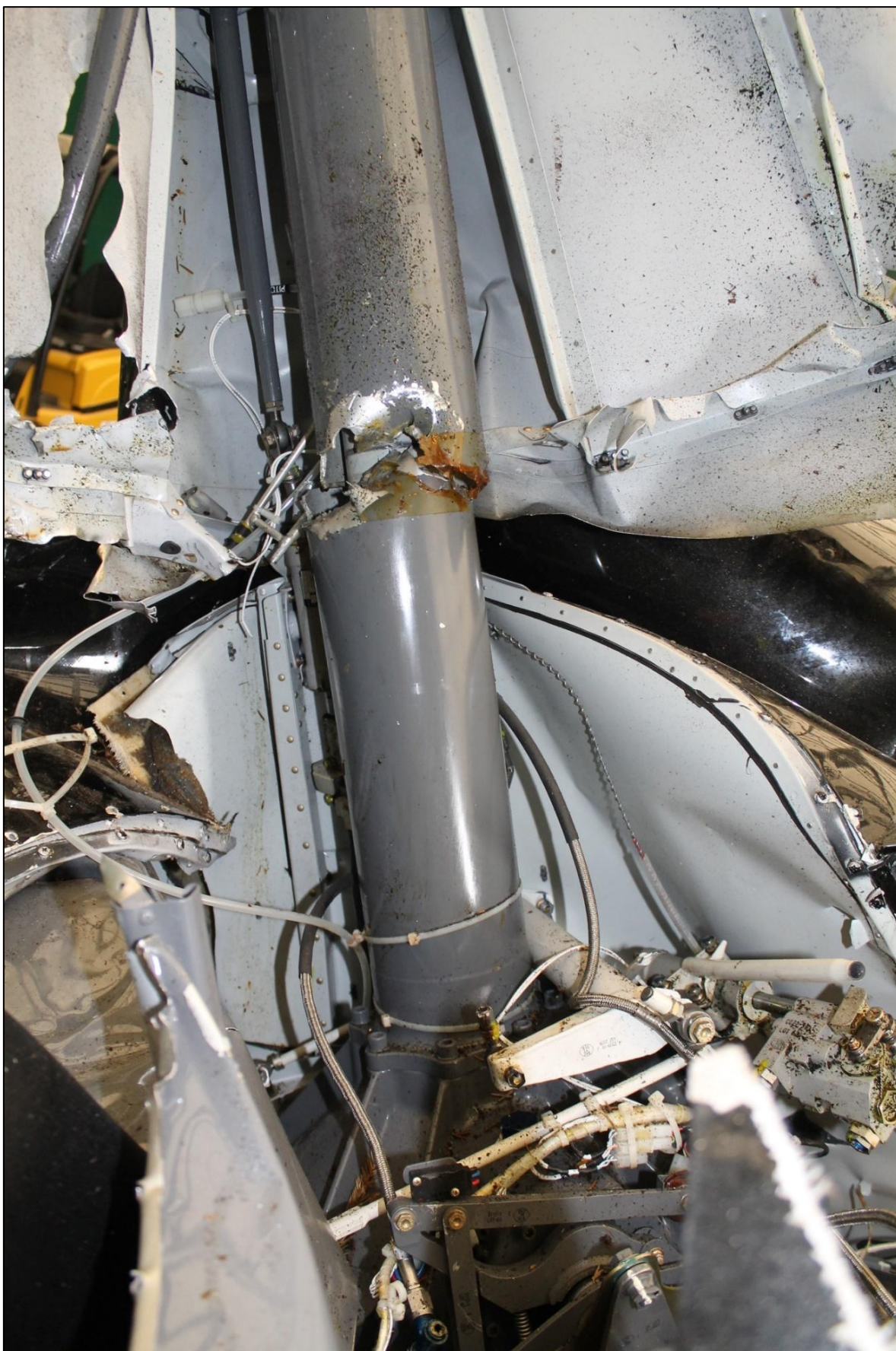
Kuva 11. OE-XOS:n pääroottorin masto oli katkennut noin 40 cm roottorin päävaihteiston yläpuolelta. (Kuva: OTKES)
