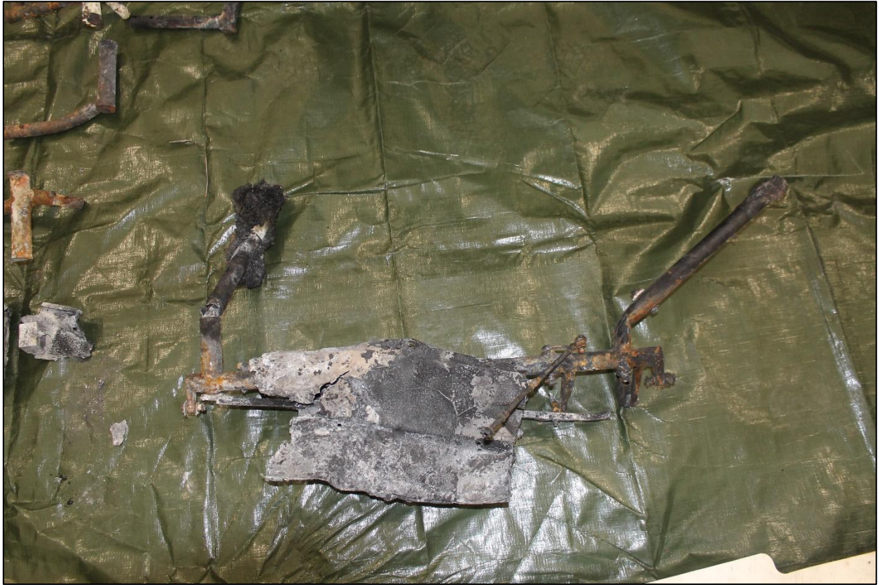
Kuva 7. ES-ETR:n noususauva onnettomuuden jälkeen. (Kuva: OTKES)
