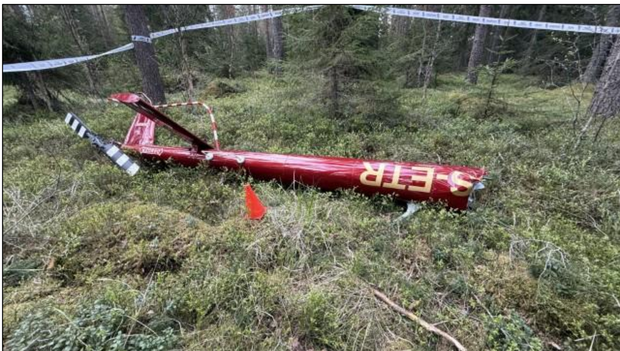
Joonis 8. ES-ETR-i sabapoom oli kokkupõrke tulemusel helikopteri kere küljest eemaldunud. (Joonis: OTKES)
