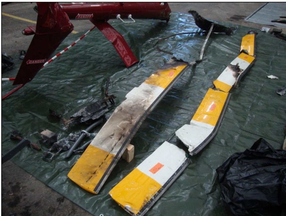
Joonis 9. ES-ETR-i pearootori labad. Üks laba põles poolenisti ära ja teine purunes kokkupõrkel neljaks osaks. (Joonis: OTKES)
