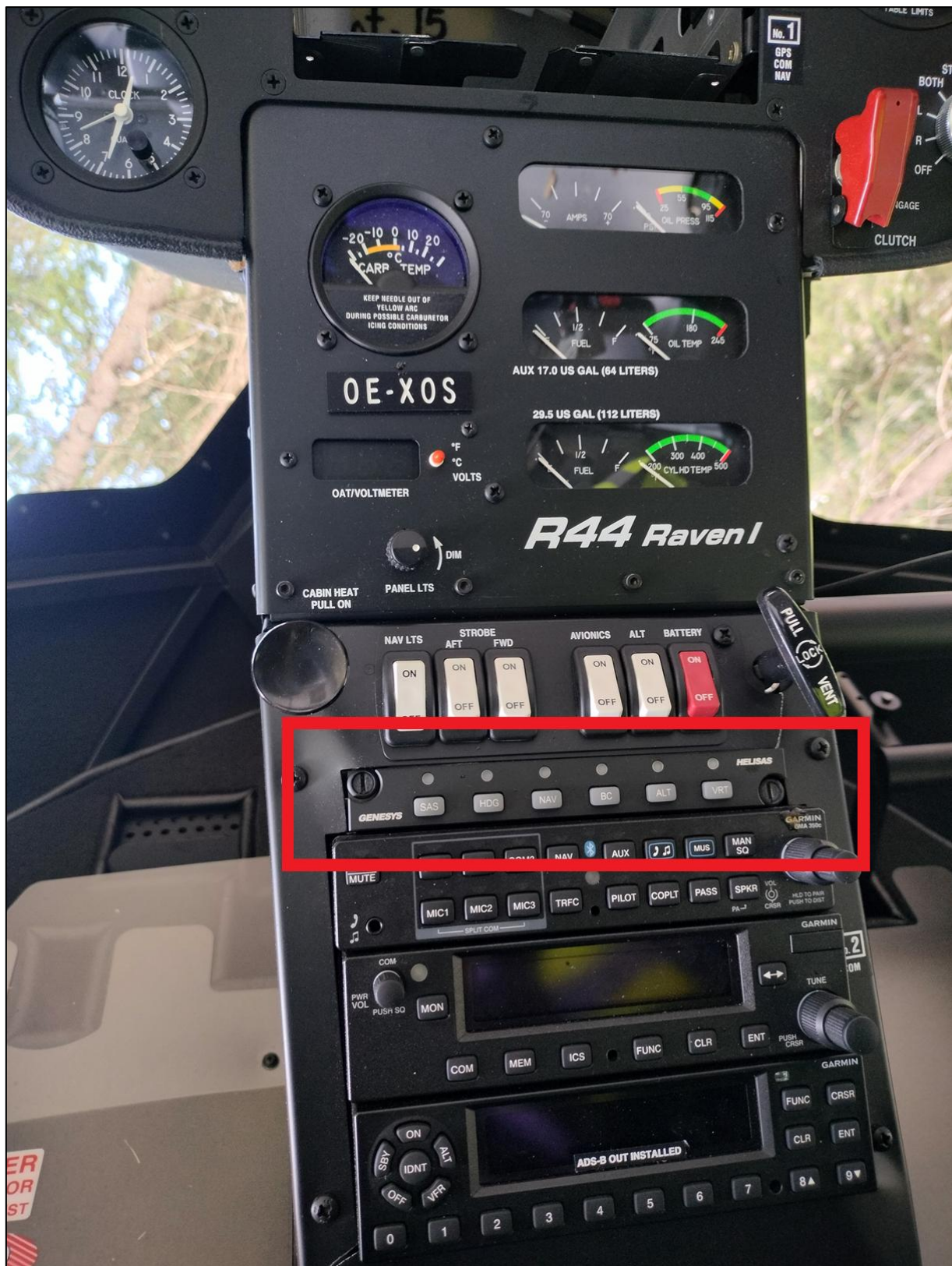
Joonis 5. Genesys HeliSAS-i juhtpaneel (Joonis: OTKES)
