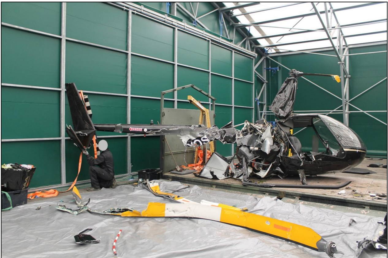
Joonis 12. OE-XOS hallis pärast õnnetust. Sabapoom oli umbes keskelt purunenud, kuid see on pildistamise hetkel rekonstrueerimise eesmärgil tagasi oma kohale tõstetud. (Joonis: OTKES)
