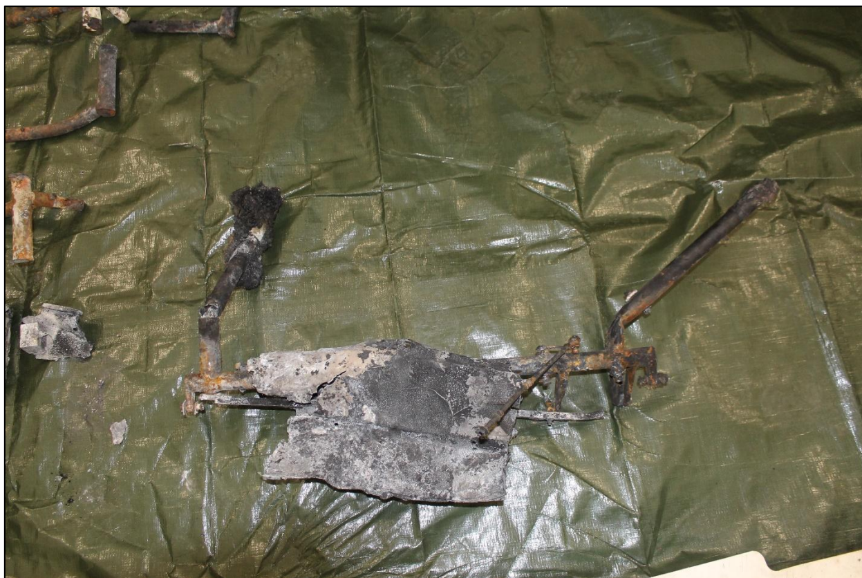
Joonis 7. ES-ETR-i tõusuhoob pärast õnnetust. (Joonis: OTKES)
