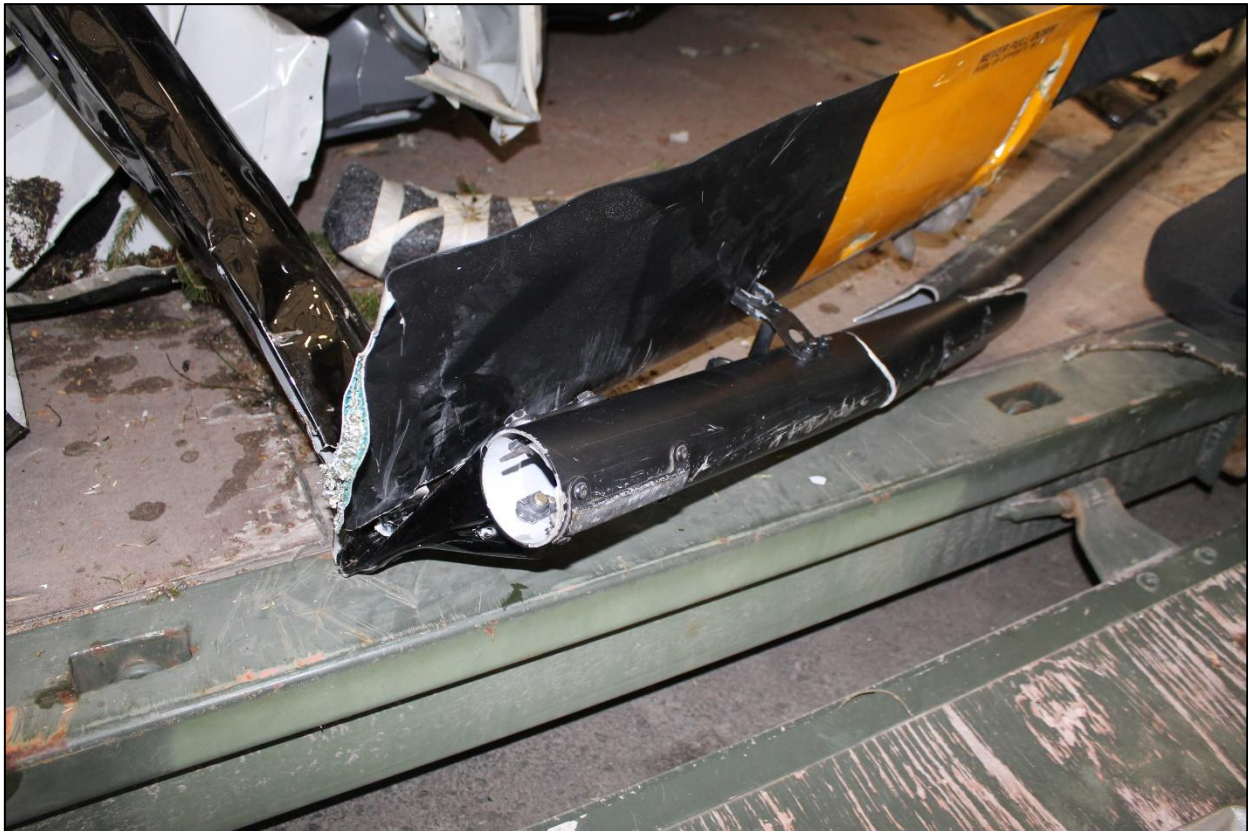
Joonis 13. OE-XOS-i parema maandumisteliku tagaosa ja ES-ETR-i pearootori laba, mille kahjustused vastavad üksteisele. (Joonis: OTKES)
