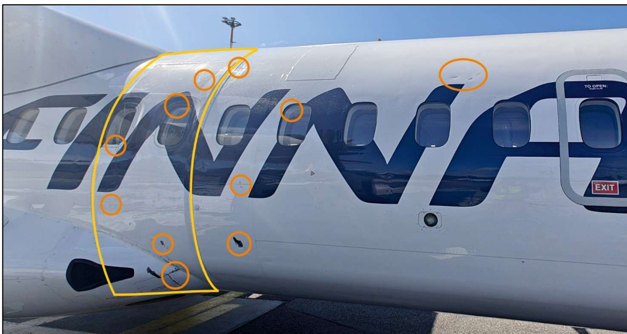
Kuva 6. Lentokoneen vauriot on merkitty kuvaan oransseilla ympyröillä. Lentokoneen rungon vahvistettu osa on rajattu keltaisella kuviolla. (Kuva: OTKES)
