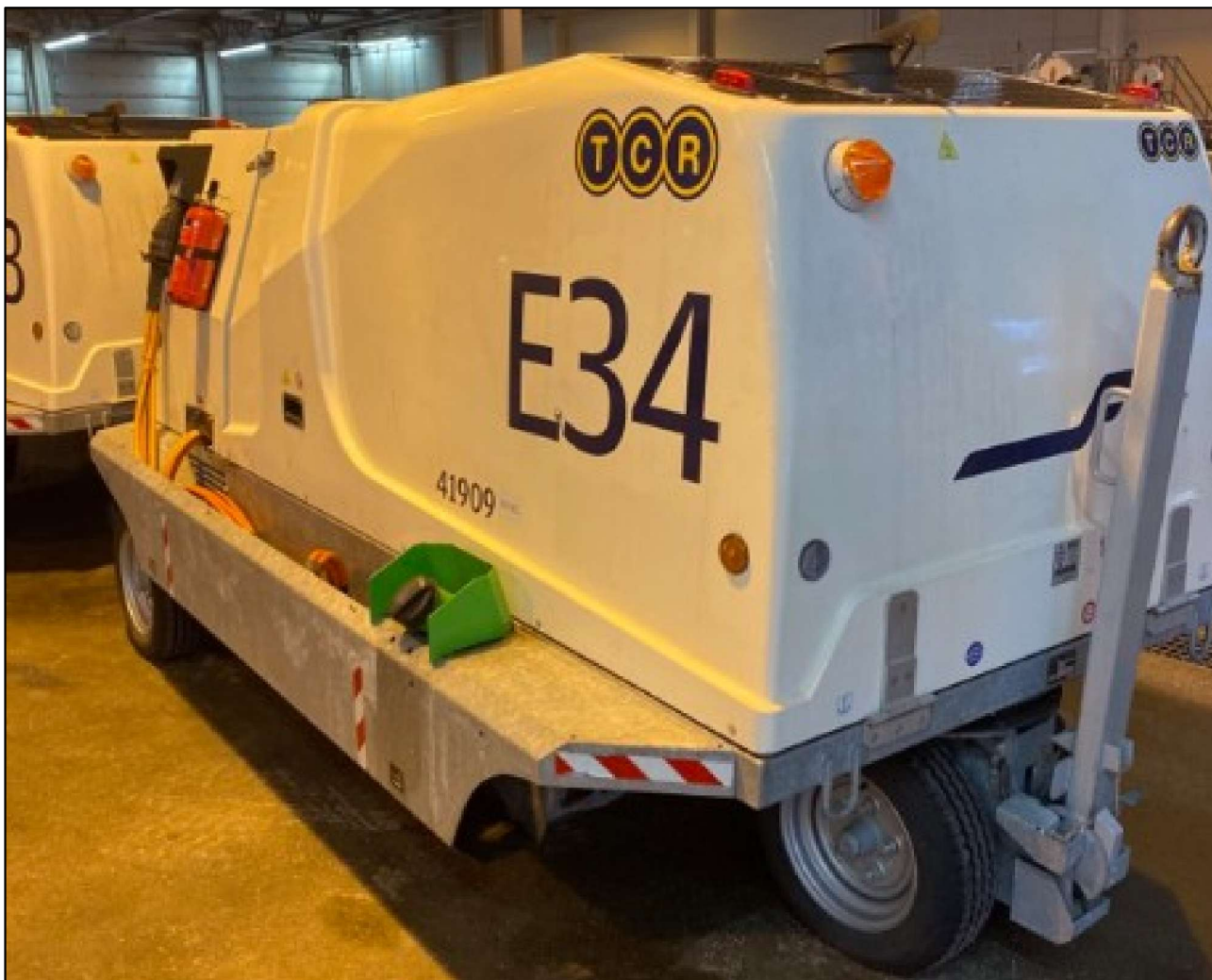
Kuva 9. Guinaultin GA90-mallinen maavirtalaite. (Kuva: TCR Finland)
