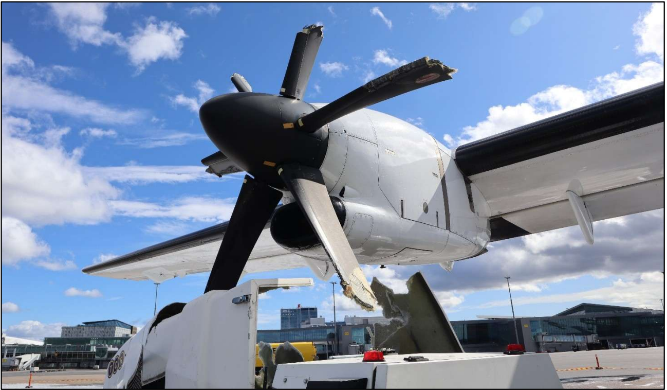
Kuva 4. Lentokoneen potkurin lavat katkesivat osuessaan maavirtalaitteeseen. (Kuva: OTKES)
