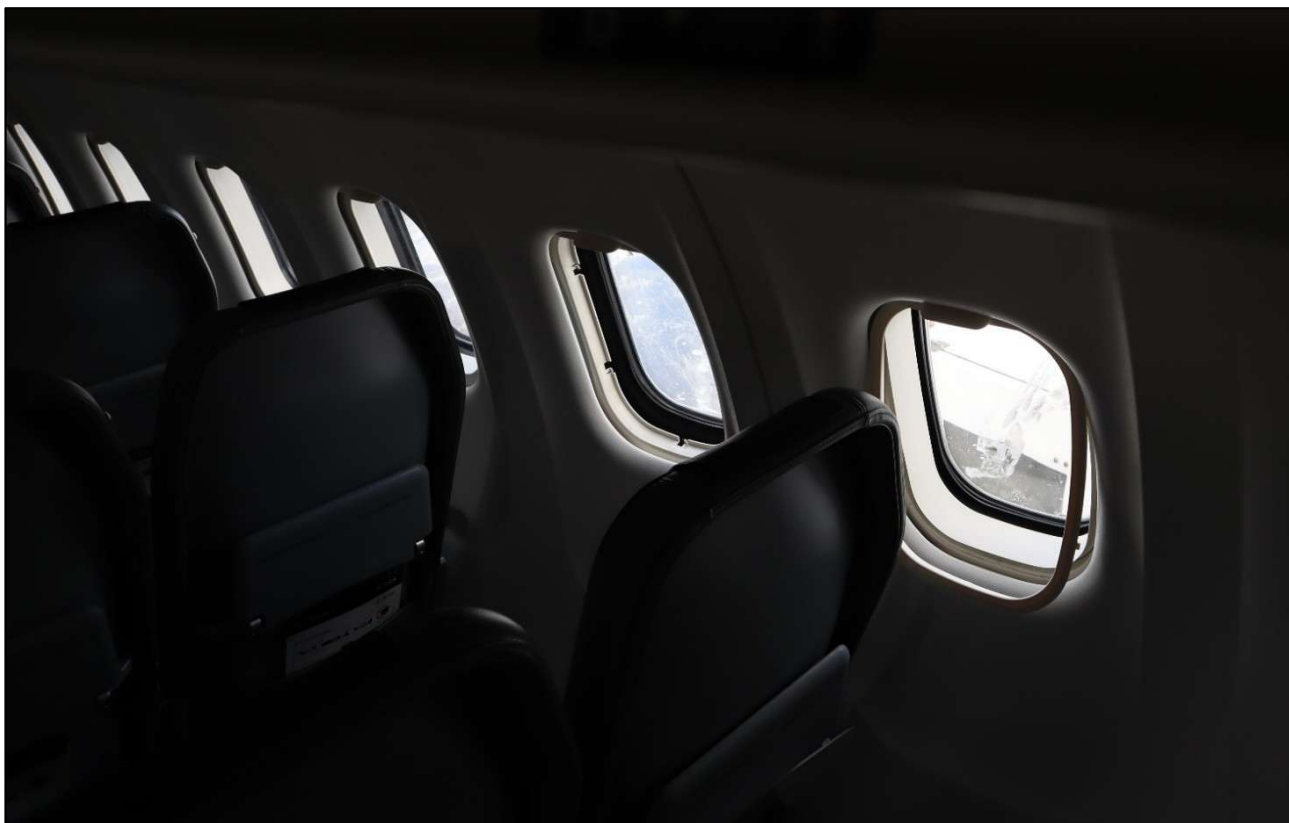
Kuva 5. Ikkunoihin lentäneet potkurin ja maavirtalaitteen kappaleet aiheuttivat lentokoneen sisäpuoleisten ikkunoiden ja niiden kehysten irtoamisen sijoiltaan rikkoutuneen potkurin kohdalta. (Kuva: OTKES)
