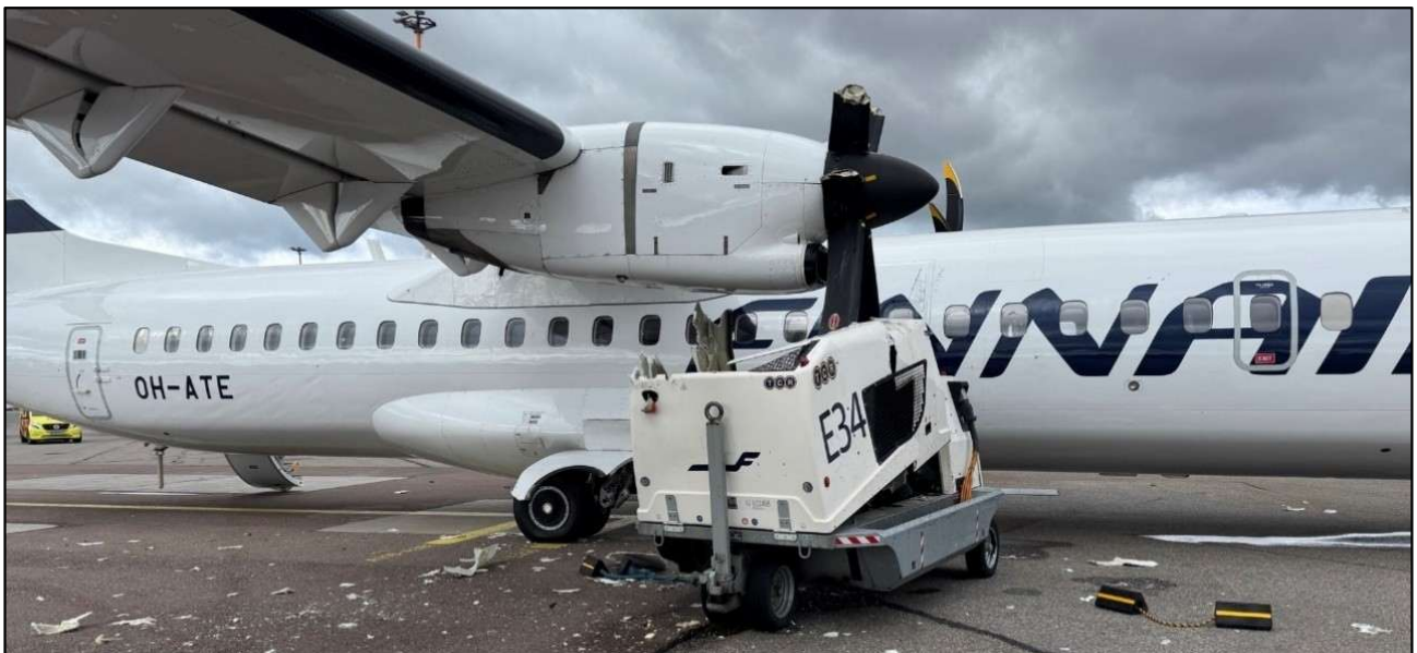
Kuva 1. Lentokoneen ja maavirtalaitteen yhteentörmäys. (Kuva: OTKES)
