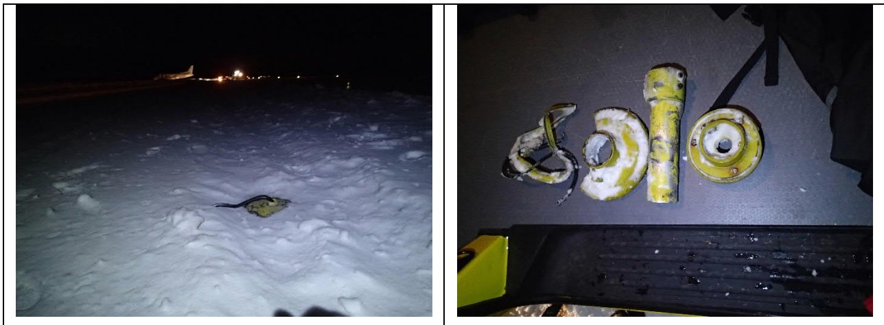
Kuva 4. Rikkoutunut kiitotien reunavalo. (Kuvat: OTKES)
