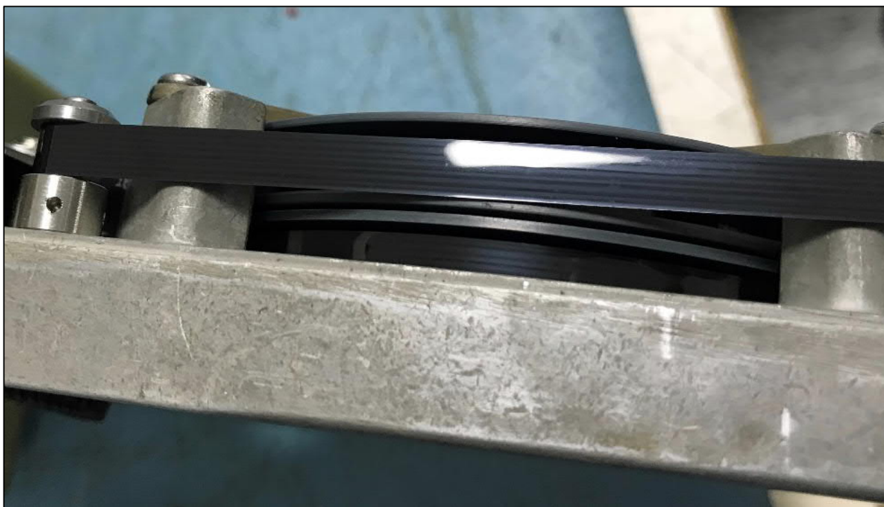
Kuva 7. Lentoarvotallennin oli magneettinauhatyypinen. Kuvassa näkyvät pitkittäiset juovat kertovat nauhan kuluneisuudesta. Hyväkuntoisessa nauhassa ei ole juovia. (Kuva: AAIB)
