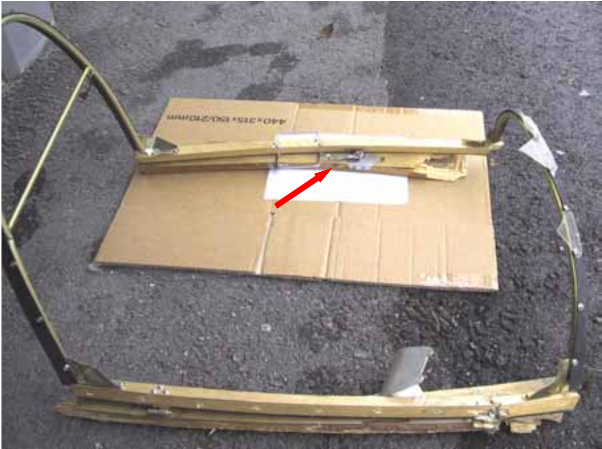
Kuva 4 Kuomu, nuolen osoittama lukitusvipu kiinni-asennossa
