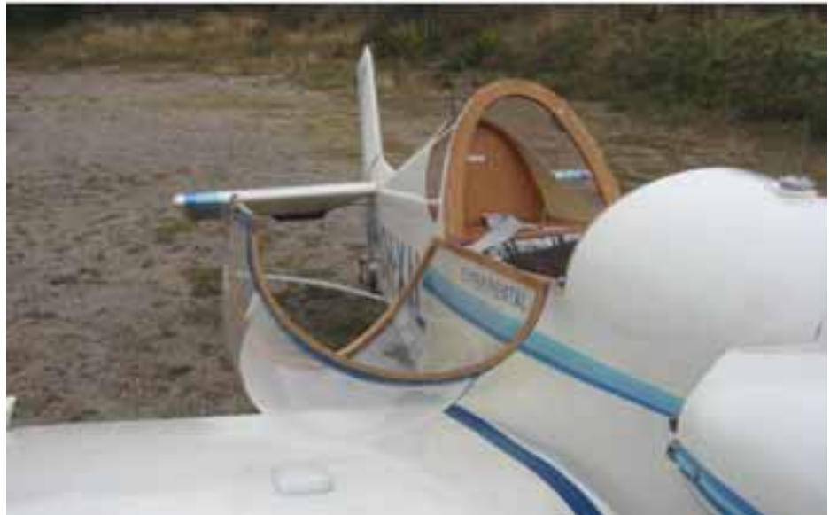
Kuva 8. Kuomu rajoitinpunos katkenneena. Kuo- mu iskeytyy siipeen.
