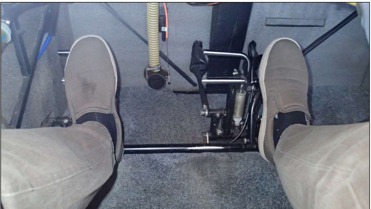
Kuva 3. Right foot positioned incorrectly. Photo: SIAF
