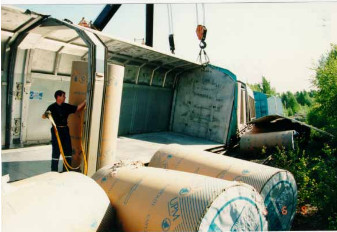
Kuva 4. Ensimmäisenä suistuneen vaunun perässä tulleet kaksi vaunua suistuivat myös kiskoilta. Vaunujen kallistuessa paperirullat luisuivat vaunujen kevyiden katteiden läpi ratapenkereelle (Nokia 9.6.1996).
