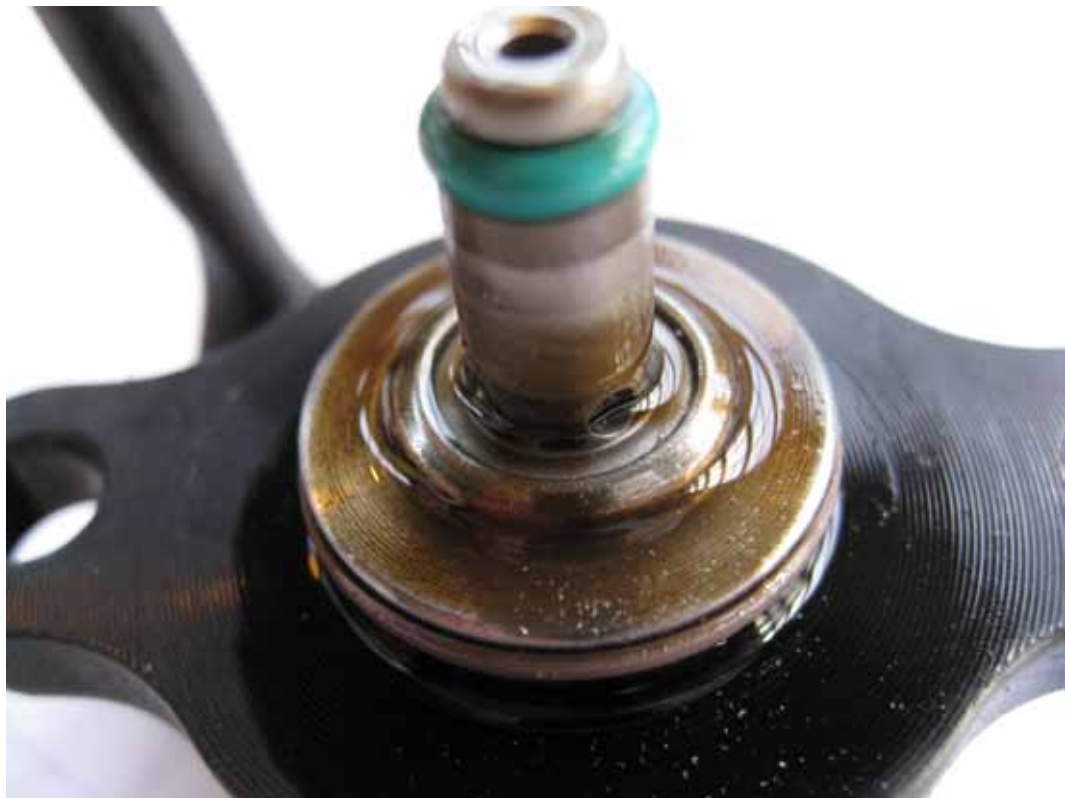
Kuva 5 Paineensäätöventtiilissä olleet metallihiukkaset.
