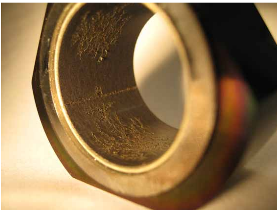
Kuva 6 OH-CAZ:n moottorin korkeapainepumpun käyttimen laakerin teflonpinnan kulumisjälkiä.
