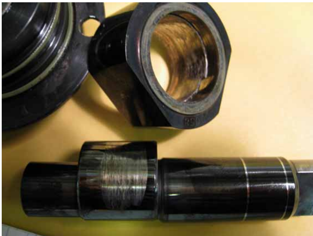
Kuva 4 Moottorin korkeapainepumppun käyttimen ja epäkeskoakselin vaurioita.
