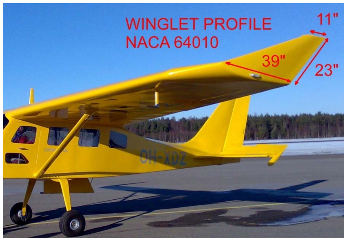
Kuva 18. Wingletin päämittoja.
