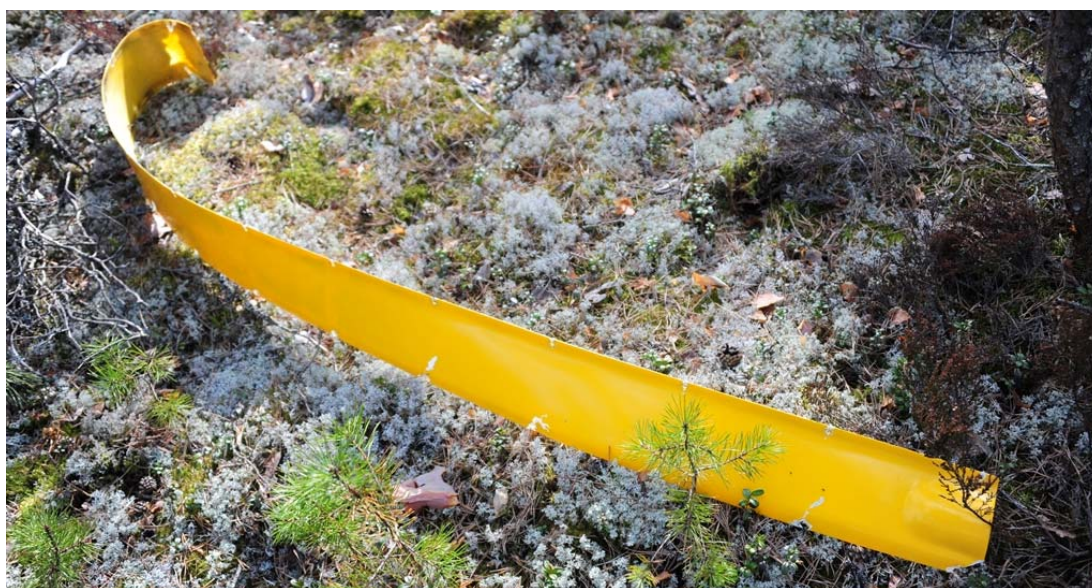
Kuva 7. Maastosta löytynyt oikean siiven tyven ja rungon välinen yläpuolinen muotolevy.
