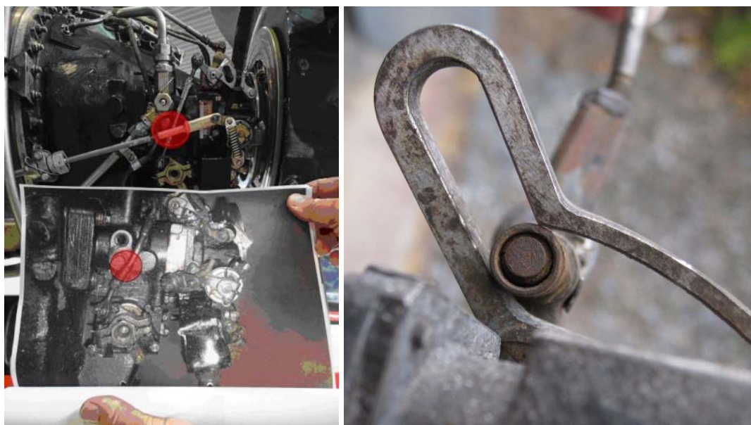
Kuva 19. Vasemmalla on potkurinsäätimen vivustojen vertailua – ylhäällä toimintakuntoinen moottori ja alhaalla valokuva OH-XDZ:n moottorin vivustoista. Oikealla on moottorin polttoainesäätimen tehovivun käyttämä ohjain.
