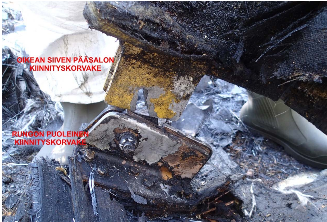
Kuva 8. Oikean siiven pääsalon kiinnityskorvake ja rungon puoleinen korvake.
