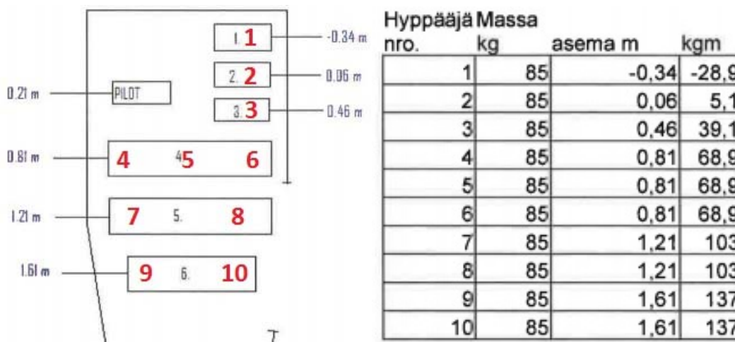
Kuva 2. Vasemmalla on lento-ohjekirjan kuormauspiirros täydellä kymmenen lasku-varjohyppäjän kuormalla. Piirrokseseen on lisätty punaisella hyppäjien peri-aatteelliset sijoittumiset. Oikealla on lento-ohjekirjan taulukko massakeskiön laskemiseen hyppäjien osalta.
