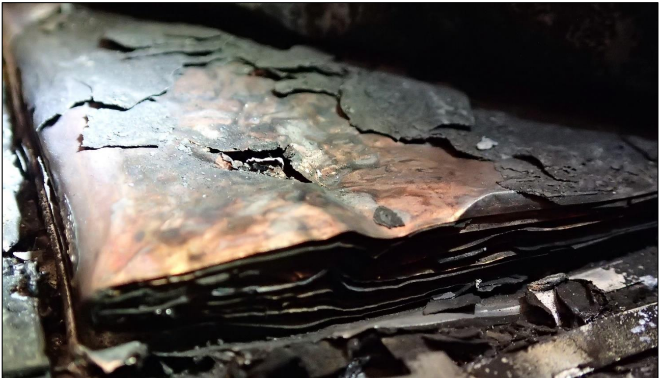
Kuva 5. Lähikuva tietokoneen akun vaurioista (Kuva: OTKES)
