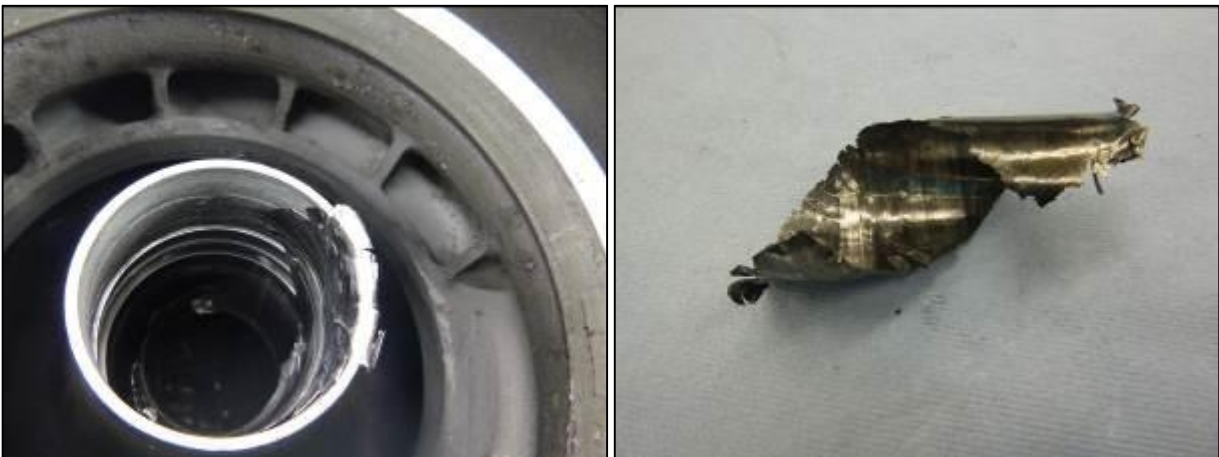
Kuva 12. Vaurioitunut liukulaakerien vaurioita (Kuvat: Hamilton Sundstrand CSC Maastricht BV/UTC Aerospace Systems)
