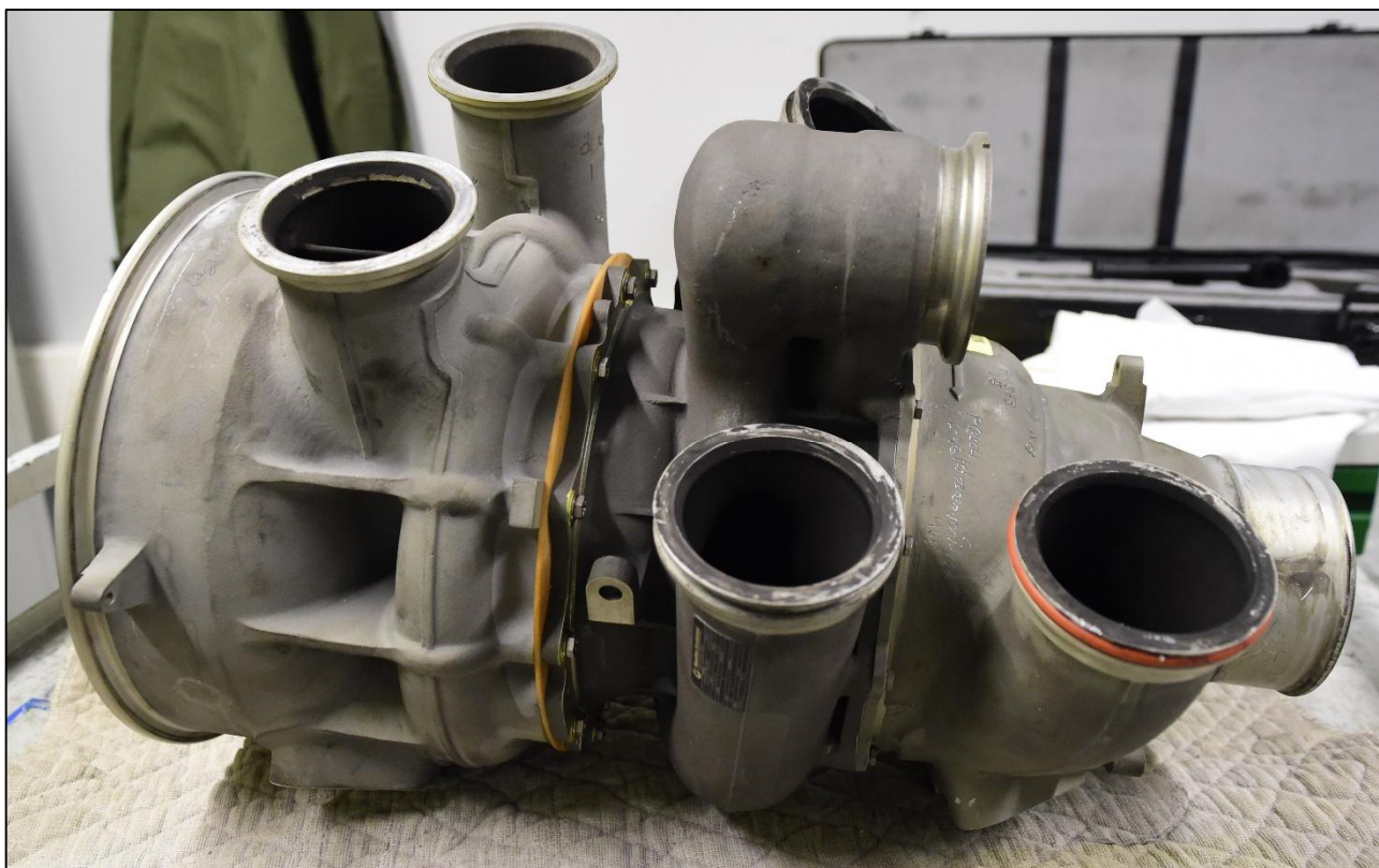
Kuva 4. Lentokoneesta OH-LKE irrotettu jäähdytyskoneisto (ACM-laite) (Kuva: Nordic Regional Airlines Oy)
