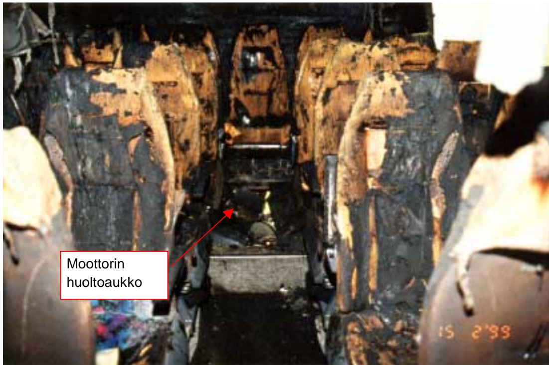
Kuva 3. Viiden takimmaisesta istuinrivin istuimet olivat palaneet ja takaosan sisäverho oli täysin tuhoutunut. Matkustamon etuosassa oli savu- ja nokivaurioita.
