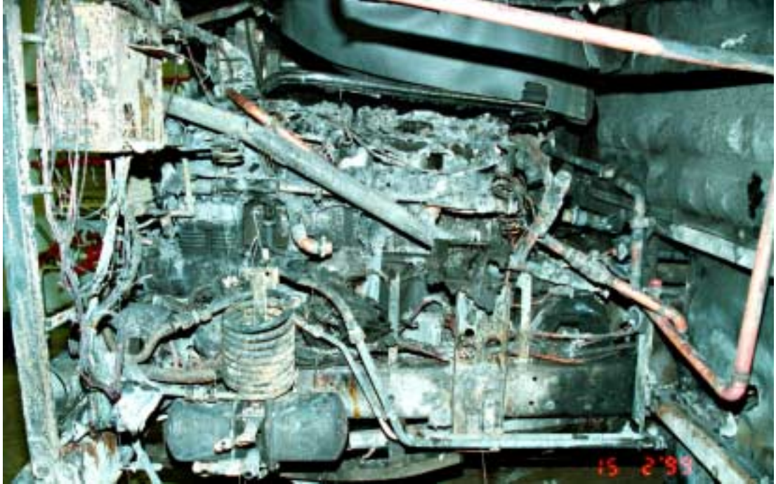
Kuva 4. Moottori oikealta puolelta kuvattuna. Runkopalkin päällä näkyy sähkökaapelipun jäännökset. Kaapelipun yläpuolella on ollut muovista valmistetut polttoaineputket (tulo- ja paluuputki).
