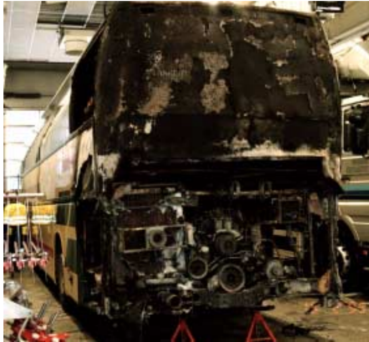
Kuva 2. Kuva takaa vasemmalta. Tuli oli sulattanut sivuluukun, rungon verhou levyä ja rikkonut takimmaisen sivuikkunan, josta liekit olivat päässeet matkustamoon.
