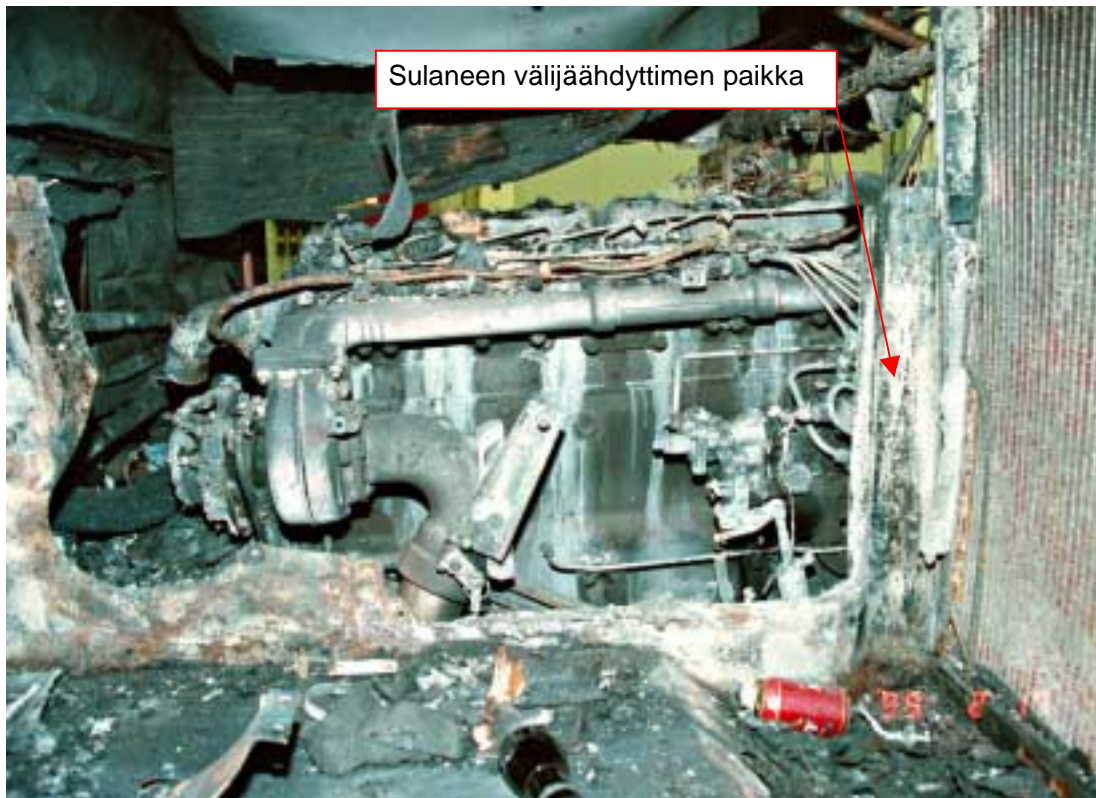
Kuva 5. Moottori vasemmalta puolelta kuvattuna. Turboahtimen ahdinkammio, ahtoilmän jäähdytin ja niiden ilmaputki olivat sulaneet. Myös moottorin sivulla ollut alumiinirakenteinen väliseinä oli sulanut.
