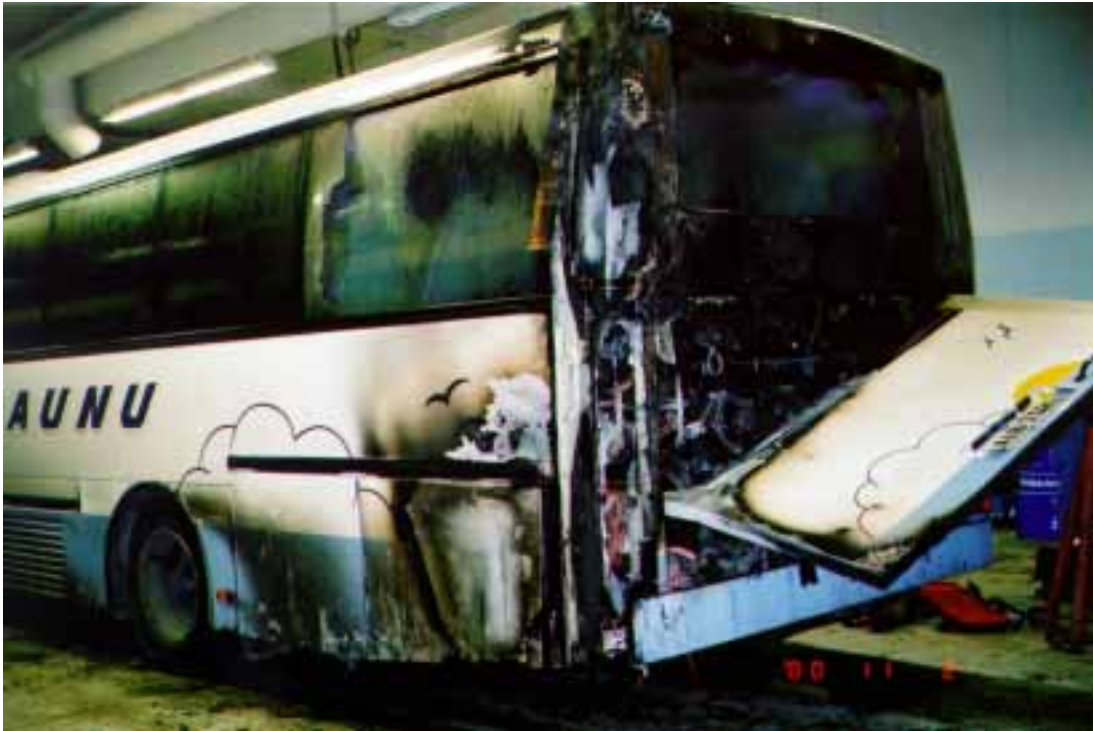
Kuva 16. Auton vasen takakulma paloi pahoin. Tuli rikkoi jo taaimman sivuikkunan uloimman lasin. Palo ei levinnyt matkustamoon.
