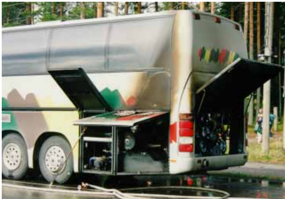
Kuva 1. Liekit nousivat moottoritilan luukun säleikön välistä ylös, vasemman taimmaisen sivuikkunan päälle, mutta ikkuna ei vielä rikkoutunut.
