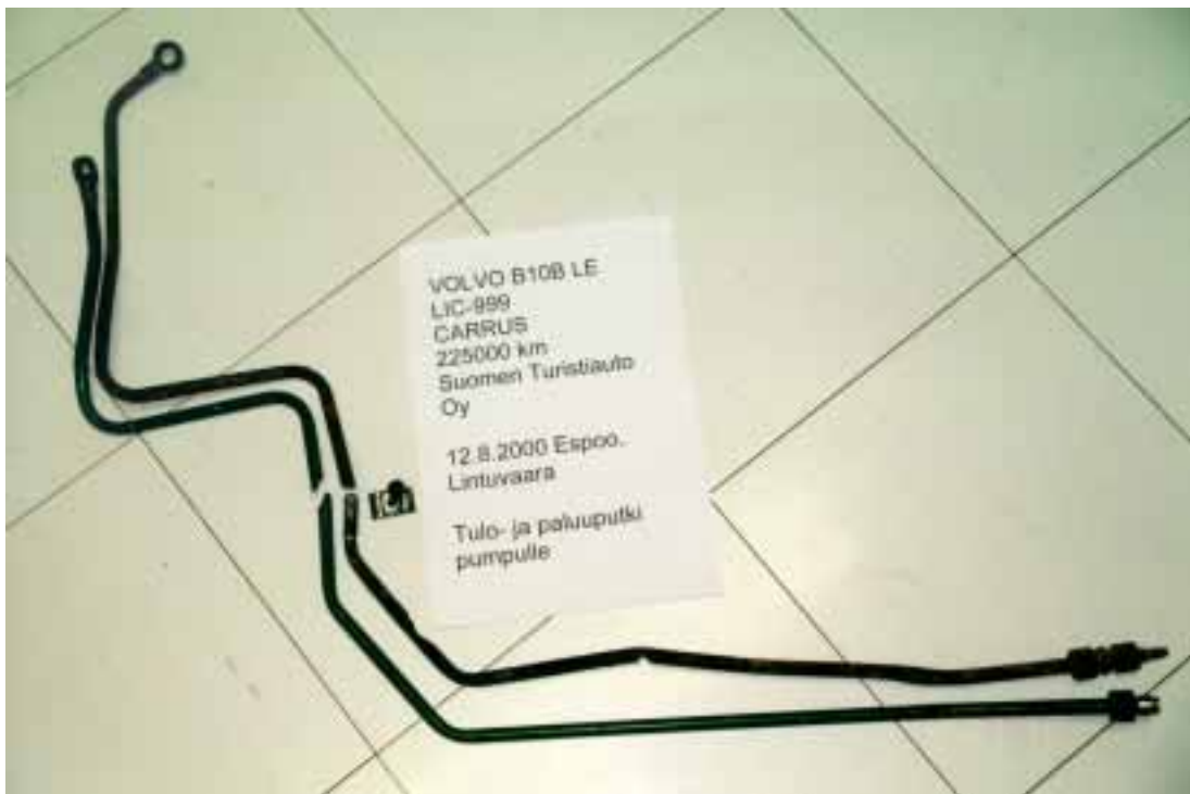
Kuva 6. Kuvassa oikeanpuoleinen putki on katkennut, palon aiheuttanut, polttoaineen paluuputki. Vasen putki on tuloputki, joka oli katkennut murtuman vuoksi muutama päivä ennen paloa ja korvattu taipuisalla putkella. Tuolloin kuvassa näkyvä kiinnike oli jätetty pois.
