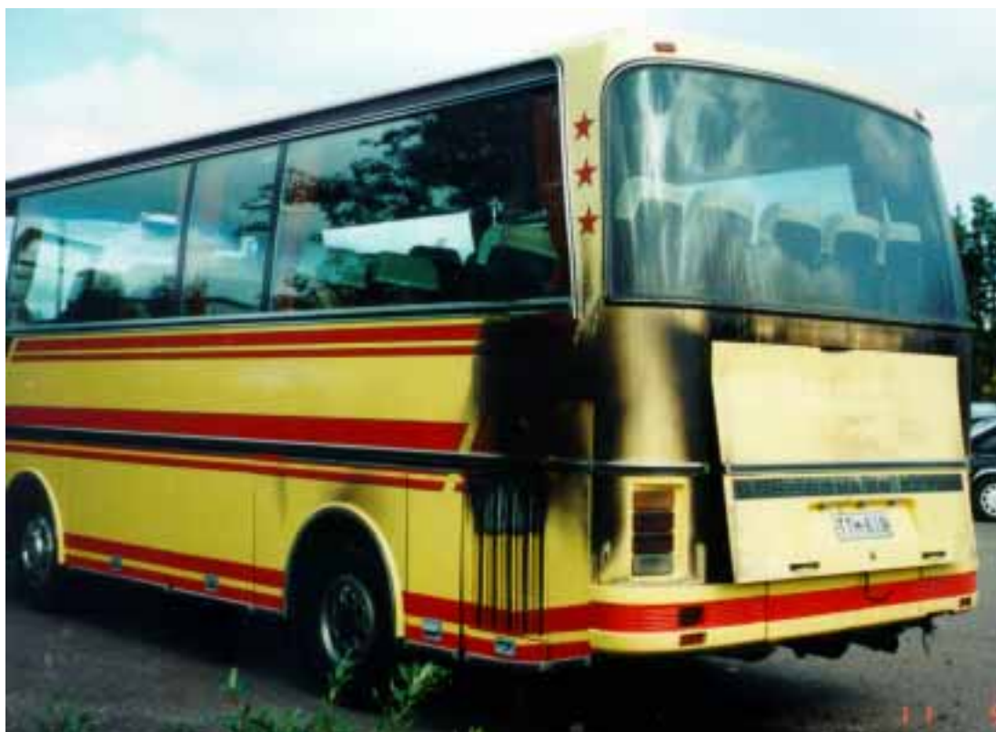
Kuva 7. Liekit tulivat ulos moottoritilasta vasemmalla takana olevan ilmanpuhdistimen luukun säleikön ja moottoritilan takaluukun välistä. Säleikön takana on ilmanpuhdistin, akut ja sähköinen päävirtakytkin.
