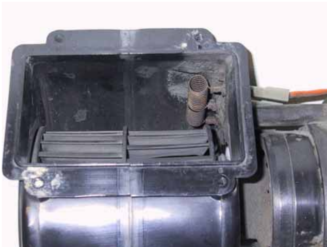
Kuva 20. Kuvassa palossa tuhoutuneen puhaltimen kaltainen puhallin, jonka etuvastus on jo sulattanut muovikuorta, mutta muovi ei ole vielä syttynyt palamaan.
