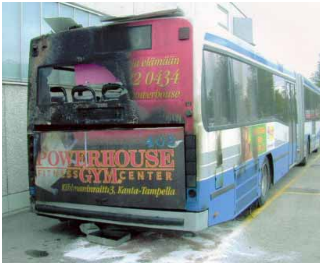
Kuva 9. Pahimmat palovauriot olivat auton vasemmassa takakulmassa. Liekit olivat rikkoneet auton takaikkunan ja vaurioittaneet vähän myös matkustamoa.
