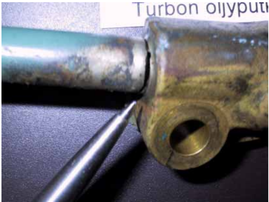
Kuva 18. Putken seinämästä noin puolet on murtunut väsymismurtuman seurauksena. Putki oli ollut asennettuna autossa noin 10 päivää.
