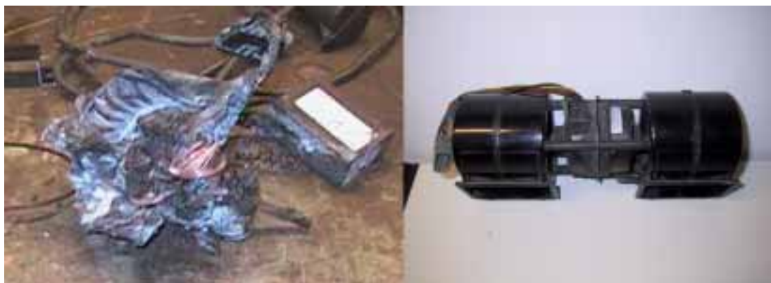
Kuva 19. Vasemmalla tuhoutunut puhallin ja oikealla vastaavanlainen ehyt.
