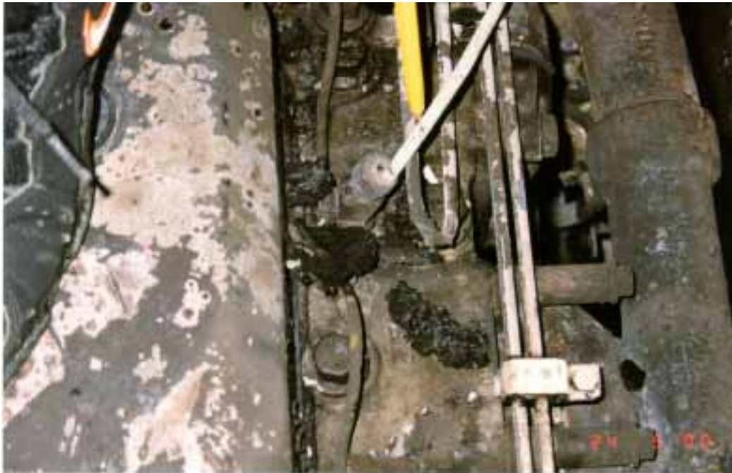
Kuva 2. Sylinterin 4 katkennut suihkupuutke. Oikealla oleva paksu putki on pakosarja.
