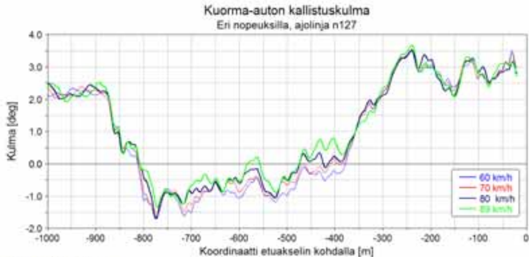
Kuva 22. Kuorma-auton rungon kallistuskulma eri nopeuksilla. Positiivinen kulma = kallistus oikealle.
