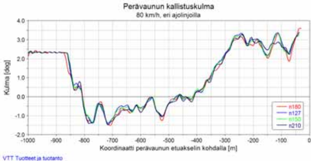
Kuva 20. Perävaunun rungon kallistuskulma eri ajolinjoilla. Positiivinen kulma = kallistus oikealle. Koordinaatti 0 = yhteentörmäyspaikka.
