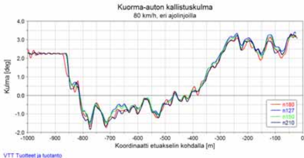
Kuva 19. Kuorma-auton rungon kallistuskulma eri ajolinjoilla. Positiivinen kulma = kallistus oikealle. Koordinaatti 0 = yhteentörmäyspaikka.
