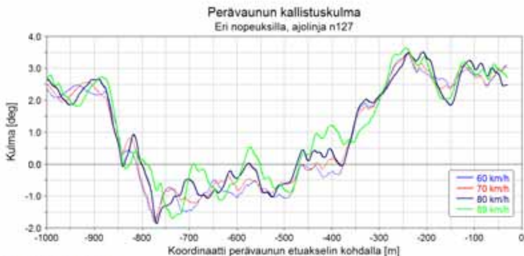
Kuva 23. Perävaunun rungon kallistuskulma eri nopeuksilla. Positiivinen kulma = kallistus oikealle.
