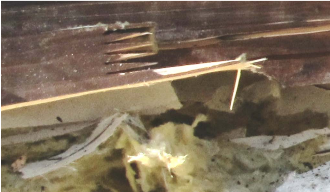
Kuva 18. Murtokohta palkin alimmassa lamellissa. Sormet eivät olleet katkenneet ja palkin alareuna oli kääntynyt sivulle. Kuvassa näkyvät sormet ovat lamellin sivussa. (Kuva: poliisi.)
