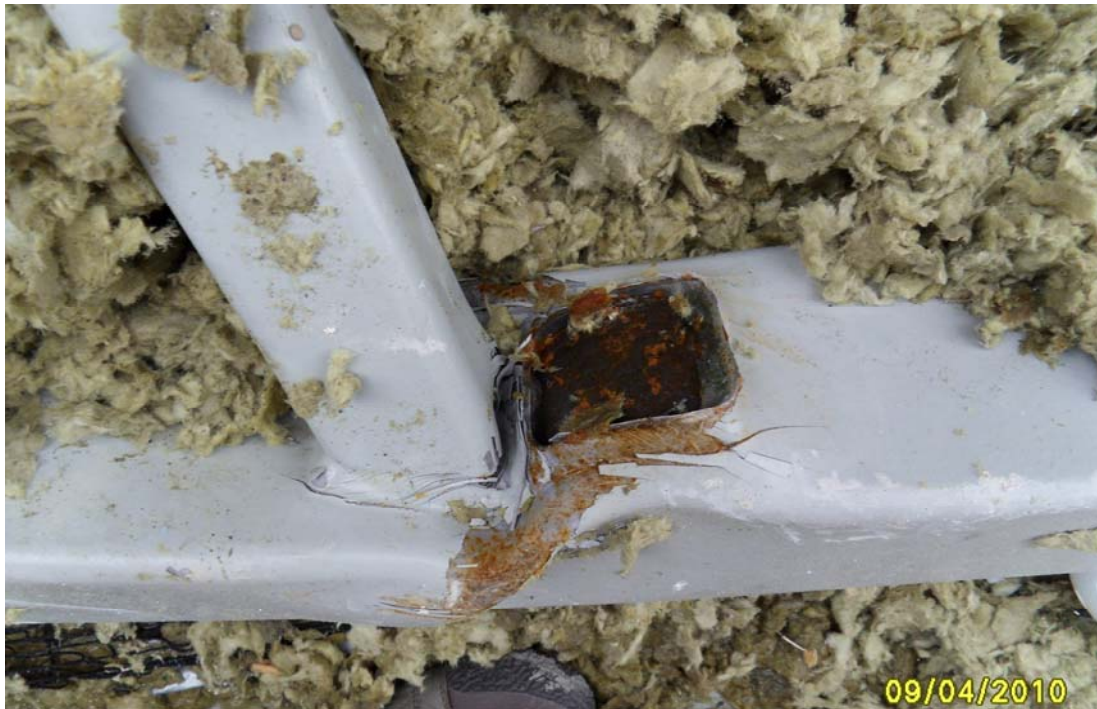
Kuva 11. Paarteista repeytyi irti diagonaaleja siten, että pala paarretta (tumma reikä) leikkautui irti ja jäi kiinni diagonaalin päähän. (Ari Rinne © 2010)
